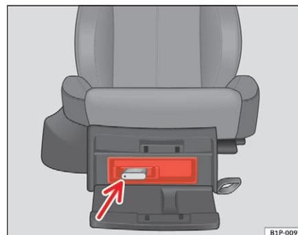
Abb. 14 Anschluss des iPod im Modell León
