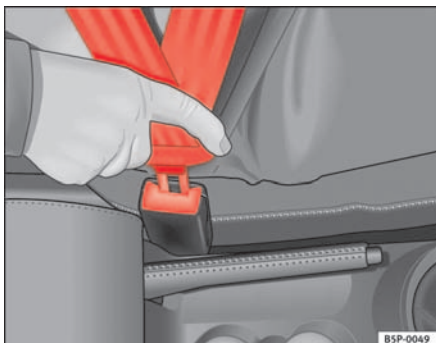
Abb. 12 Gurtschloss und Schloßzunge des Sicherheitsgurtes
