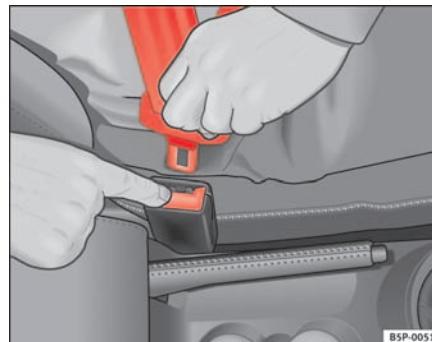
Abb. 16 Lösen der Schlosszunge vom Gurtschloss
