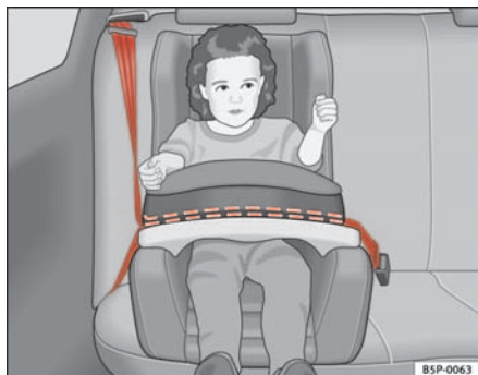
Abb. 29 In Fahrtrichtung eingebauter Kindersitz der Gruppe 1 auf dem Rücksitz
