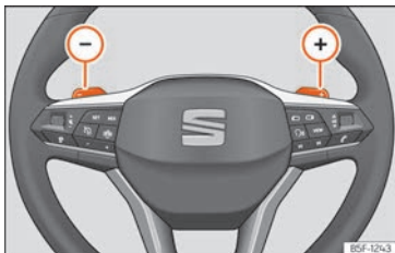
Abb. 166 Lenkrad: Hebel für Automatikgetriebe.
