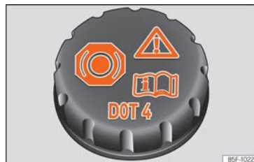
Abb. 229 Motorraum: Deckel des Bremsflüssigkeitsbehälters.
