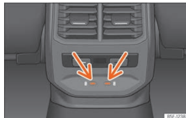
Abb. 160 Mittelkonsole hinten: USB-Anschlüsse mit Steckdosenfunktion.
