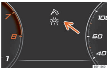
Abb. 64 Anzeige des Assistenten für eine ökologische Fahrweise (schematische Darstellung).
