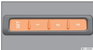
Abb. 116 Außen am Fahrersitz: Speichertasten.
