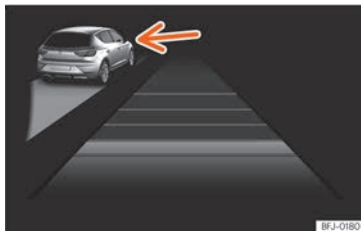
Abb. 181 Am Bildschirm des Kombi-Instruments: ACC aktiv, Fahrzeug auf der linken Seite erkannt
