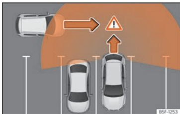
Abb. 192 Schematische Abbildung des Ausparkassistenten: Überwacher Bereich des ausparkenden Fahrzeugs.
