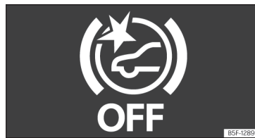
Abb. 178 Am Bildschirm des Kombi-Instruments: Anzeige, dass Front Assist ausgeschaltet ist.
