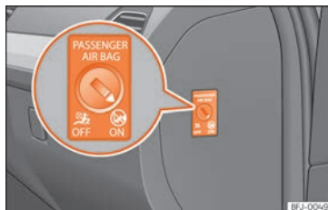
Abb. 20 Schlüsselschalter zum Ein- und Abschalten des Beifahrerairbags.
