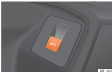
Abb. 94 An der Fahrertür: Taste zum Öffnen und Schließen der Heckklappe.
