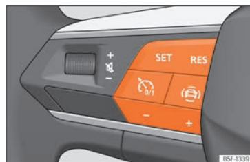
Abb. 173 Am Multifunktionslenkrad: Tasten zum Bedienen der Geschwindigkeitsregelanlage
