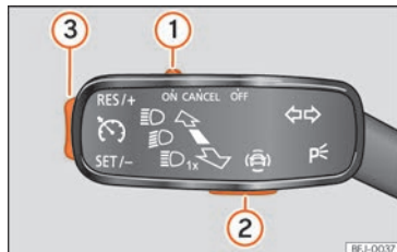
Abb. 175 Am Blinkerhebel: Tasten zur Bedienung des Geschwindigkeitsbegrenzers.
