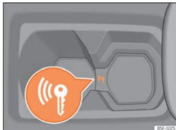
Abb. 162 In der Mittelkonsole: Notstart.
