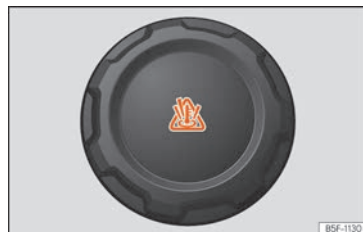
Abb. 228 Motorraum: Deckel des Motorkühlmittelausgleichsbehälters.
