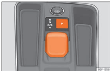
Abb. 165 In der Mittelkonsole: Wahlschalter.
