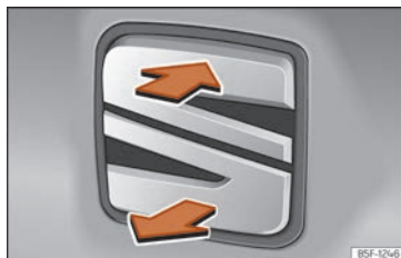
Abb. 92 Heckklappe: Öffnen von außen.
