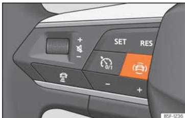
Abb. 73 Linke Seite des Multifunktionslenkrads: Taste für die Fahrerassistenzsysteme (modellabhängig).
