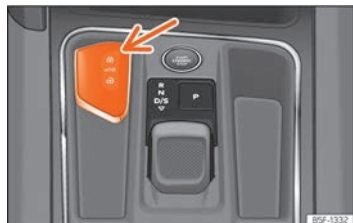
Abb. 81 Mittelkonsole: Aufnahme für den Fahrzeugschlüssel
