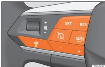
Abb. 179 Am Multifunktionslenkrad: Tasten zur ACC-Bedienung
