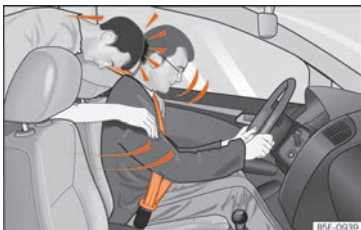
Abb. 13 Der nicht angegurte Mitfahrer auf dem Rücksitz schleudert nach vorn auf den angegurten Fahrer.
