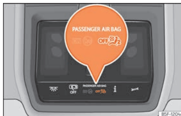
Abb. 21 In der Dachkonsole: Kontrollleuchte für Abschaltung der Beifahrerairbags.
