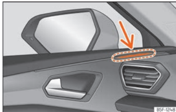
Abb. 188 Kontrollleuchte des Spurwechselassistenten.
