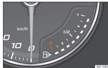
Abb. 67 Analoges Kombi-Instrument: Kraftstoffvorratsanzeige
