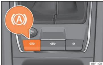
Abb. 196 Im unteren Teil der Mittelkonsole: Taste für die Auto Hold-Funktion.
