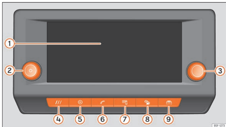
Abb. 153 Allgemeine Übersicht: Bedieneinheiten und Anzeige in der 8,25 Zoll Ausführung
