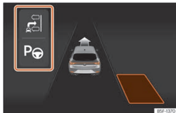
Abb. 197 Am Bildschirm des Kombi-Instruments: Anzeige des Parklenkassistenten mit eingeschränkter Sicht.
