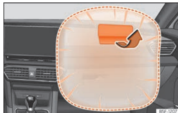
Abb. 19 Beifahrerairbag in der Instrumententafel
