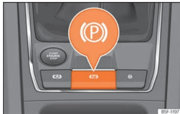
Abb. 195 Im unteren Teil der Mittelkonsole: Taste für elektronische Parkbremse.
