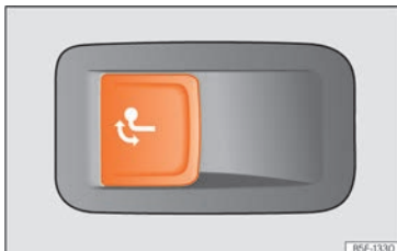
Abb. 206 Im Gepäckraum links: Taste zur Entriegelung der Anhängerkupplung.
