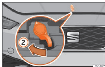
Abb. 222 Hebel unter der Motorraumklappe.
