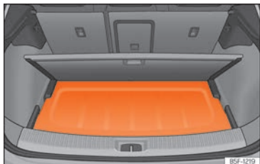
Abb. 124 Im Gepäckraum: Einsetzen der Gepäckraumabdeckung.
