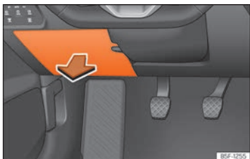
Abb. 55 Auf der Fahrerseite in der Instrumententafel: Abdeckung des Sicherungskastens.
