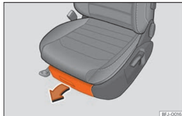
Abb. 145 Unter dem Vordersitz: Schublade.
