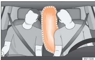
Abb. 25 Vollständig entfalteter Center-Airbag (Entfaltungsbereich)
