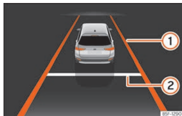
Abb. 185 Am Bildschirm des Kombi-Instruments: Anzeige bei aktiver Regelung.
