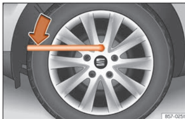
Abb. 43 Radwechsel: Radschrauben lockern.
