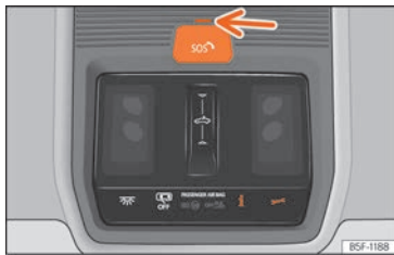
Abb. 37 In der Dachkonsole: Schalter für Sprachdienste
