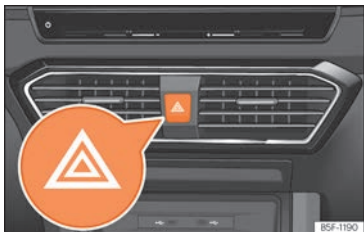
Abb. 103 Instrumententafel: Schalter für Warnblinkanlage.
