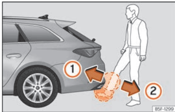
Abb. 95 Heckklappe mit sensorgesteuerter Öffnung (Easy Open).
