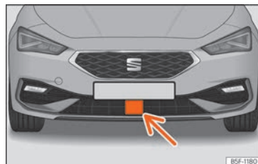
Abb. 167 Am vorderen Stoßfänger: Radarsensor.
