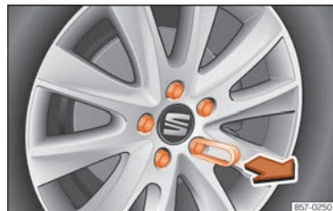
Abb. 41 Rad: Radschrauben mit Deckel.
