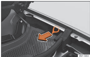
Abb. 213 Zwischen dem linken Kotflügel und dem Scharnier der Frontklappe: Ziehgriff für manuelle Notentriegelung des Ladesteckers.
