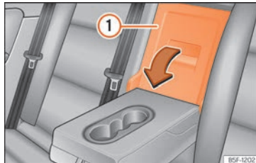
Abb. 136 An der Rücksitzlehne: Öffnung der Durchladeeinrichtung.
