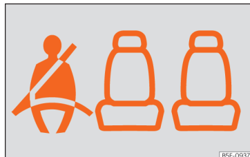
Abb. 10 Kombi-Instrument: Anzeige, dass der Platz hinten links besetzt ist und der Mitfahrer seinen Sicherheitsgurt angelegt hat.
