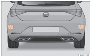
Abb. 170 Heckansicht des Fahrzeugs: Bereich der Radarsensoren.
