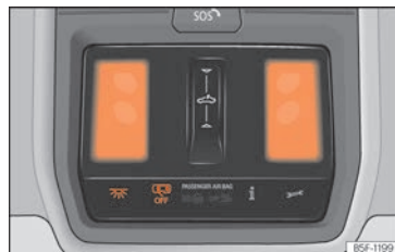
Abb. 104 Ausschnitt aus Dachhimmel:: Innenraumbeleuchtung vorn.
