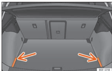
Abb. 123 Im Gepäckraum: Abdeckungen zum Verstauen der Gepäckraumabdeckung.
