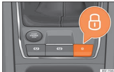
Abb. 86 In der Mittelkonsole: Zentralverriegelungstaster
