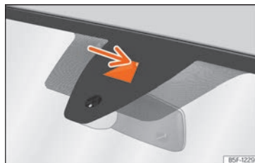
Abb. 169 An der Windschutzscheibe: Kamerasichtfenster des Spurhalteassistenten.
