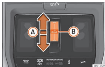
Abb. 99 Im Dachhimmel: Taste des Glasdachs.
