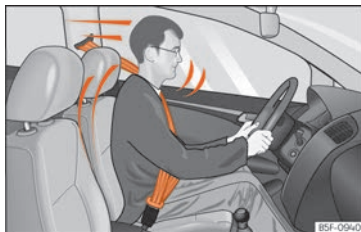
Abb. 93 Richtig angegurtete Fahrer werden bei einem plötzlichen Bremsmanöver nicht nach vorne geschleudert.
