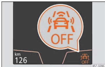
Abb. 267 Auf dem Display des Kombi-Instruments: Anzeige, dass Front Assist ausgeschaltet ist.
