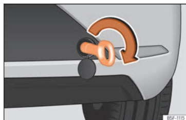
Abb. 103 Hinterer Stoßfänger rechts: Eingeschraubte Abschleppöse
