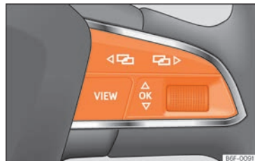
Abb. 137 Rechte Seite des Multifunktionslenkrads: Bedienelemente für die Menüs und Informationsanzeige im Kombiinstrument.
