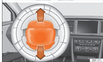
Abb. 26 Einbauort Fahrerairbag: im Lenkrad.
