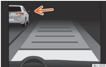
Abb. 274 Im Display des Kombiinstruments: ACC aktiv, Fahrzeug auf der linken Seite erkannt
