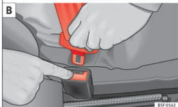
Abb. 91 Schlosszunge des Sicherheitsgurts in das Gurtschloss einstecken und vom Gurtschloss lösen.
