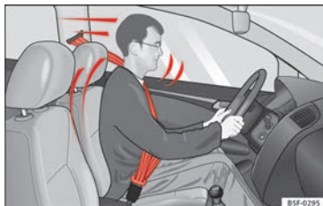
Abb. 88 Richtig angegurte Fahrer werden bei einem plötzlichen Bremsmanöver nicht nach vorne geschleudert.
