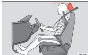
Abb. 83 Die richtige Kopfstüzeinstellung des Fahrers.
