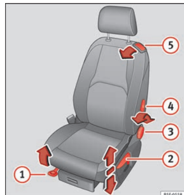
Abb. 13 Vordersitze: Manuelle Sitzverstellung.
