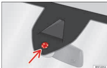
Abb. 144 Sensitive Fläche des Regensensors.
