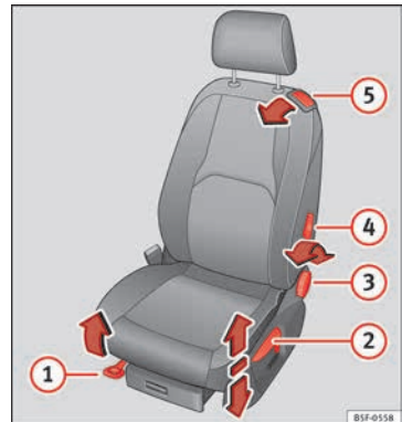
Abb. 13 Vordersitze: Manuelle Sitzverstellung.
