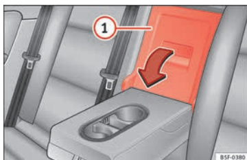
Abb. 170 An der Rücksitzlehne: Öffnung der Durchladeeinrichtung.
