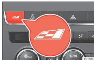
Abb. 210 Mittelkonsole: Taste Cupra Drive Profile
