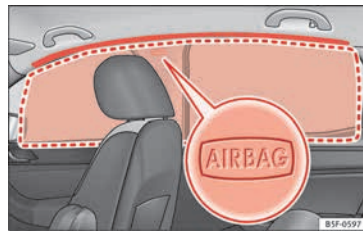
Abb. 28 Einbauort der Kopfairbags
