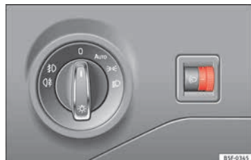
Abb. 140 Neben dem Lenkrad: Regler für die Leuchtweitenregulierung.
