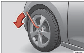
Abb. 73 Rad: Radschrauben lockern.
