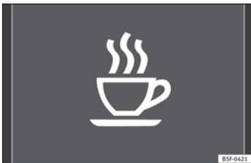
Abb. 212 Im Display des Kombiinstrumentes: Symbol der Müdigkeitserkennung.
