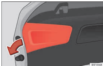
Abb. 118 Abdeckung der Gepäckraumklappe entfernen
