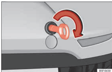
Abb. 77 Hinterer Stoßfänger rechts: Eingeschraubte Abschleppöse
