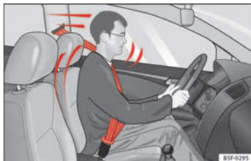
Abb. 89 Richtig angegurtete Fahrer werden bei einem plötzlichen Bremsmanöver nicht nach vorne geschleudert.
