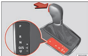
Abb. 54 Automatisches Getriebe: Wählhebelstellungen.
