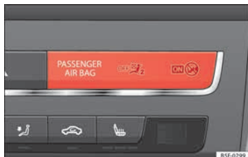
Abb. 94 Kontrollleuchte in der Instrumententafel für abgeschalteten Beifahrer-Frontairbag.
