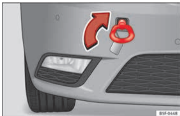
Abb. 76 Vorderer Stoßfänger rechts: Eingeschraubte Abschleppöse
