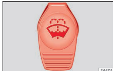
Abb. 64 Im Motorraum: Deckel des Scheibenwaschbehälters.
