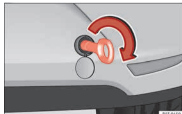
Abb. 100 Hinterer Stoßfänger rechts: Eingeschraubte Abschleppöse
