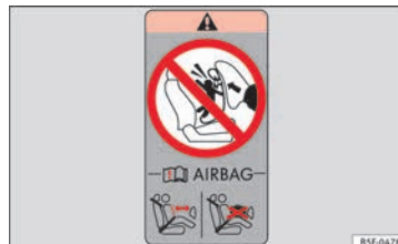
Abb. 30 Im hinteren Rahmen der Beifahrertür: Aufkleber mit Angaben zum Airbag.
