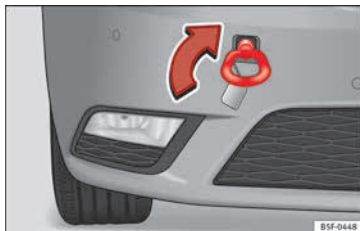
Abb. 98 Vorderer Stoßfänger rechts: Eingeschraubte Abschleppöse
