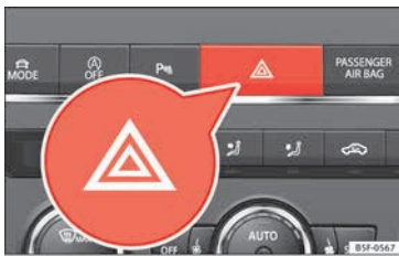
Abb. 139 Instrumententafel: Schalter für die Warnblinkanlage
