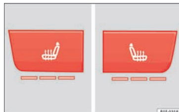
Abb. 147 In der Mittelkonsole: Regler für die Sitzheizung der Vordersitze.
