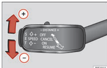
Abb. 197 Auf der linken Seite der Lenksäule: dritter Hebel für die Betätigung der automatischen Distanzregelung.
