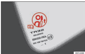
Abb. 87 Warnschild für Kopfstützenstellung
