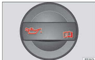
Abb. 61 Deckel der Motoröl-Einfüllöffnung im Motorraum
