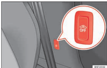
Abb. 136 Taste für Innenraum-/Abschleppschutzüberwachung
