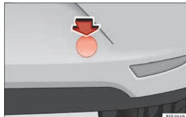
Abb. 99 Hinterer Stoßfänger rechts: Abdeckkappe-Deckel.
