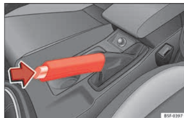
Abb. 186 Handbremse zwischen den Vordersitzen.
