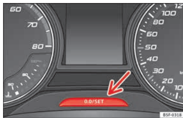
Abb. 125 Kombi-Instrument: Kilometerzähler und Rückstelltaste.
