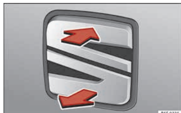
Abb. 5 Heckklappe: Öffnen von außen
