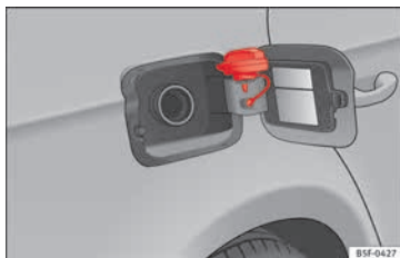
Abb. 59 Tankklappe mit aufgestecktem Tankverschluss.
