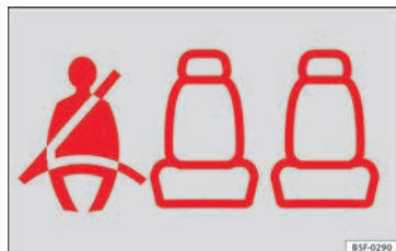
Abb. 88 Kombi-Instrument: Anzeige, dass der Platz hinten rechts besetzt und der entsprechende Sicherheitsgurt angelegt ist.
