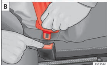
Abb. 92 Schlosszunge des Sicherheitsgurts in das Gurtschloss einstecken und vom Gurtschloss lösen.
