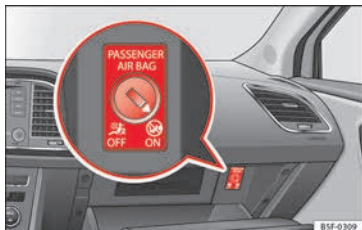
Abb. 23 Schalter für Beifahrer-Frontairbag.
