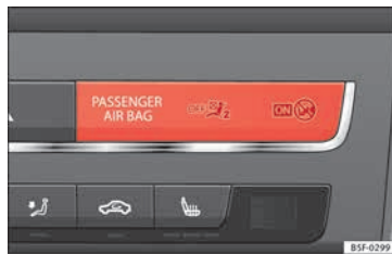
Abb. 96 Kontrolllämpchen für Abschaltung des und Beifahrerairbags.
