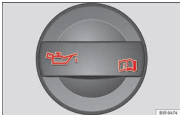
Abb. 236 Deckel der Motoröl-Einfüllöffnung im Motorraum
