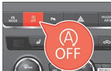
Abb. 191 Mittelkonsole: Systemtaste Start-Stopp.
