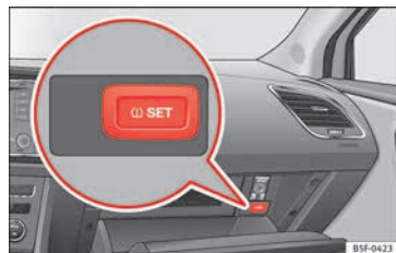
Abb. 241 Handschuhfach: Schalter Reifenkontrollanzeige.
