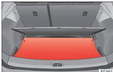
Abb. 163 Im Gepäckraum: Einsetzen der Gepäckraumabdeckung.
