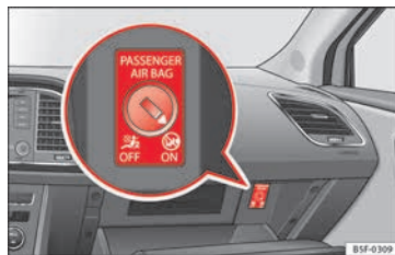
Abb. 95 Schalter für Beifahrer-Frontairbag.
