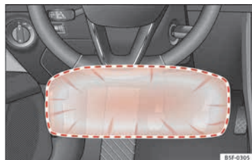
Abb. 25 Auf der Fahrerseite: Wirkungsbereich des Knieairbags.
