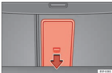
Abb. 171 Im Gepäckraum: Öffnung der Durchladeeinrichtung.
