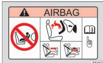
Abb. 29 Sonnenblende auf der Beifahrerseite: Airbagaufkleber.
