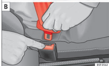
Abb. 64 Schlosszunge des Sicherheitsgurts in das Gurtschloss einstecken und vom Gurtschloss lösen.
