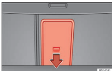
Abb. 129 Im Gepäckraum: Öffnung der Durchladeeinrichtung.
