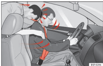
Abb. 63 Der nicht angegurte Mitfahrer auf dem Rücksitz schleudert nach vorn auf den angegurten Fahrer.
