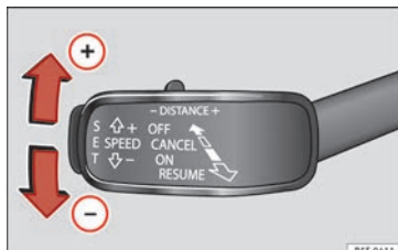
Abb. 153 Auf der linken Seite der Lenksäule: dritter Hebel für die Betätigung der automatische Distanzregelung.
