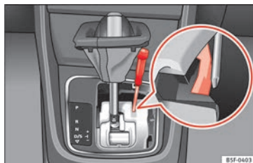
Abb. 198 Wählhebel: Notentriegeln aus der Parkstellung
