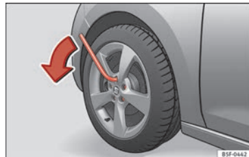
Abb. 185 Rad: Radschrauben lockern.
