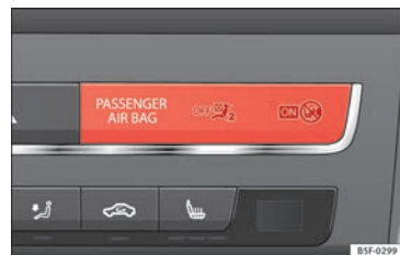
Abb. 73 Kontrollleuchte in der Instrumententafel für abgeschalteten Beifahrer-Frontairbag.
