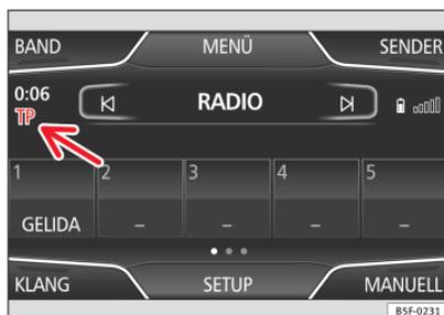
Abb. 15 Standarddarstellung: Hauptmenü RADIO mit TP Anzeige.
