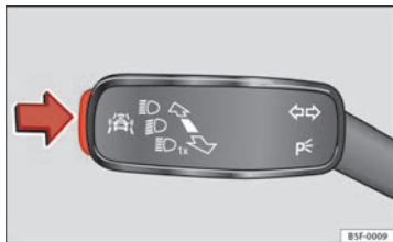
Abb. 42 Am Blinker- und Fernlichthebel: Taste für Fahrerassistenzsysteme.
