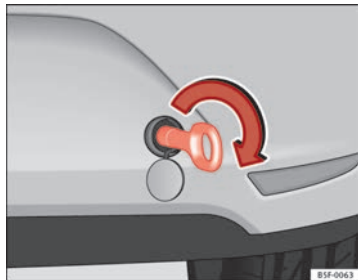
Abb. 130 Hinterer Stoßfänger rechts: Eingeschraubte Abschleppöse
