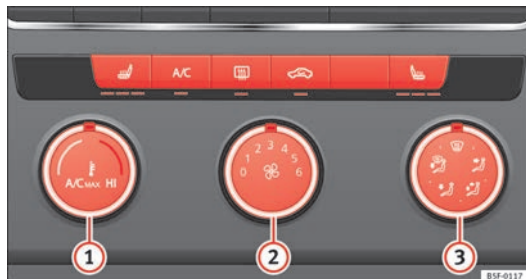
Abb. 82 Auf der Mittelkonsole: Manuelle Bedienelemente der Klimaanlage
