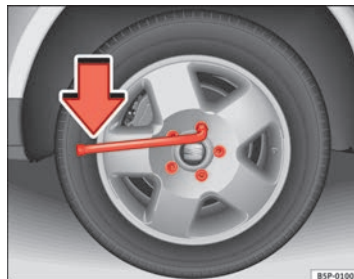
Abb. 122 Rad: Radschrauben lockern
