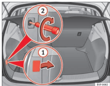
Abb. 143 Gepäckraum: Lage der Befestigungs- schraube für Heckleuchte
