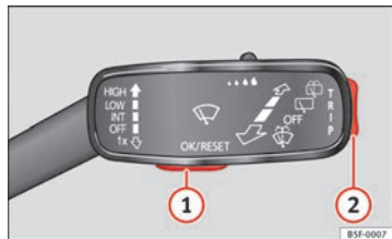
Abb. 40 Fahrzeuge ohne Multifunktionslenkrad: Taste ① im Scheibenwischerhebel zum Bestätigen von Menüpunkten und Wipptaste ② zum Wechseln der Menüs.
