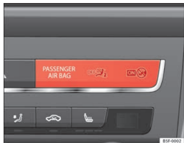
Abb. 16 Kontrollleuchte in der Instrumententafel für abgeschalteten Beifahrer-Frontairbag.
