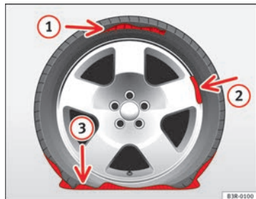
Abb. 117 Reifen: irreparable Schäden
