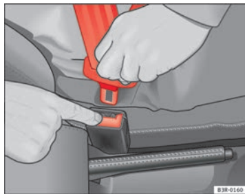
Abb. 15 Lösen der Schlosszunge vom Gurtschloss
