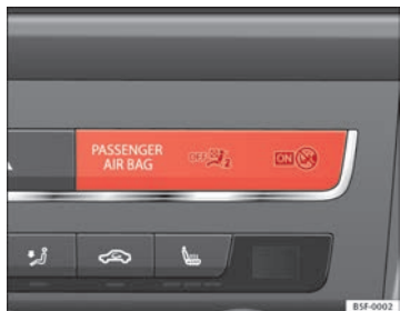
Abb. 27 Kontrollleuchte für Abschaltung des Beifahrerairbags
