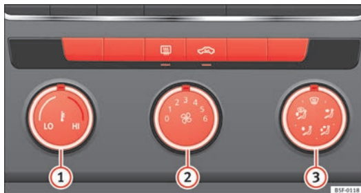
Abb. 83 Auf der Mittelkonsole: Bedienelemente des Heiz- und Frischluftsystems
