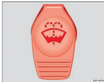
Abb. 68 Im Motorraum: Deckel des Scheibenwaschwasserbehälters.
