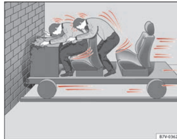
Abb. 7 Das Fahrzeug prallt an die Mauer: die Insassen haben nicht den Sicherheitsgurt angelegt
