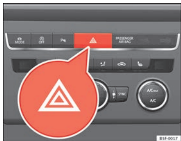
Abb. 61 In der Instrumententafel: Schalter für Warnblinkanlage
