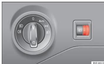
Abb. 62 Neben dem Lenkrad: Regler für die Leuchtweitenregulierung.
