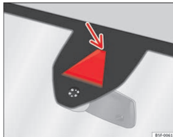
Abb. 99 An der Frontscheibe: Kamerasichtfenster des Spurhalteassistenten.
