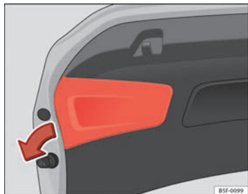
Abb. 146 Abdeckung der Gepäckraumklappe entfernen
