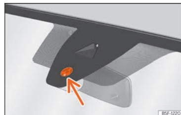
Abb. 107 Sensitive Fläche des Regensensors.
