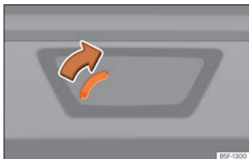
Abb. 83 Ausschnitt Gepäckraum: Notfallentriegelung (Leon Sportstourer).
