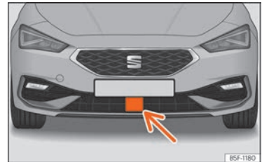
Abb. 122 Im vorderen Stoßfänger: Radarsensor.
