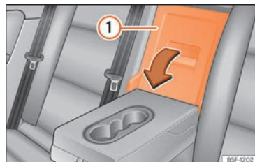
Abb. 192 An der Rückseite: Öffnung der Durchladeeinrichtung.
