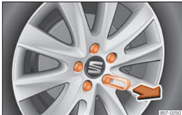
Abb. 238 Rad: Radschrauben mit Deckel.
