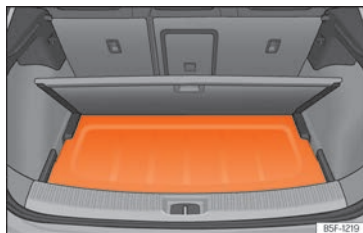
Abb. 176 Im Gepäckraum: Einsetzen der Gepäckraumabdeckung.
