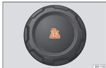
Abb. 222 Frontraum: Verschlussdeckel des Kühlmittelausgleichsbehälters.
