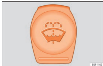
Abb. 224 Im Motorraum: Blauer Deckel des Scheibenwaschbehälters.
