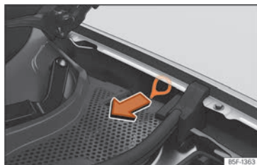
Abb. 62 Zwischen dem linken Kotflügel und dem Scharnier der Frontklappe: Ziehgriff für manuelle Notentriegelung des Ladesteckers.
