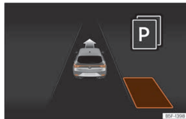
Abb. 150 Am Bildschirm des Kombi-Instruments: Anzeige des Parklenkassistenten mit eingeschränkter Sicht.
