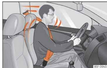
Abb. 22 Richtig angegurte Fahrer werden bei einem plötzlichen Bremsmanöver nicht nach vorne geschleudert.
