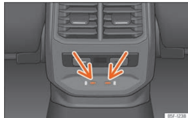
Abb. 165 Mittelkonsole hinten: USB-Anschlüsse mit Steckdosenfunktion.
