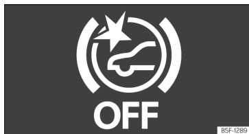
Abb. 137 Auf dem Display des Kombi-Instruments: Anzeige, dass Front Assist ausgeschaltet ist.
