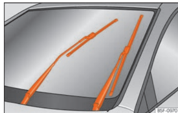
Abb. 207 Scheibenwischer in Servicestellung.
