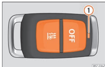
Abb. 113 Standheizung: mit Funkfernbedienung
