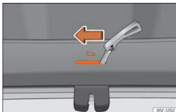
Abb. 82 Ausschnitt Gepäckraum: Notfallentriegelung (Leon).
