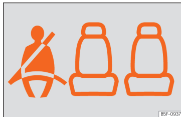
Abb. 23 Kombi-Instrument: Gurtstatusanzeige für die hinteren Sitzplätze.
