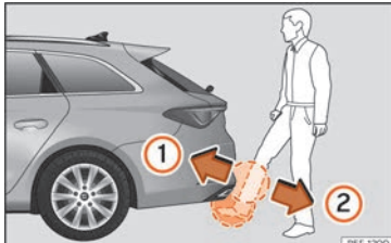
Abb. 81 Heckklappe mit sensorgesteuerter Öffnung (Easy Open).
