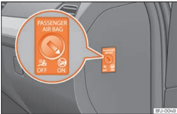
Abb. 32 Schlüsselschalter zum Ein- und Abschalten des Beifahrerairbags.
