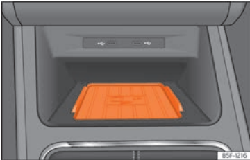
Abb. 172 In der Mittelkonsole: Aufnahme für die Mobiltelefonkopplung.
