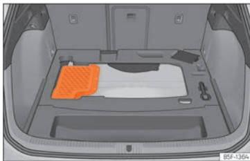
Abb. 229 Plug-in-Hybridfahrzeuge (PHEV): Einbauort der Batterie im Kofferraum
