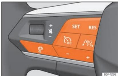
**Abb. 190** Linke Seite des Multifunktionslenkrads: Tasten zur Bedienung von Travel Assist.
