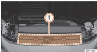
**Abb. 231** Im Motorraum: Position des Aufklebers mit Motoröl-Spezifikationen
