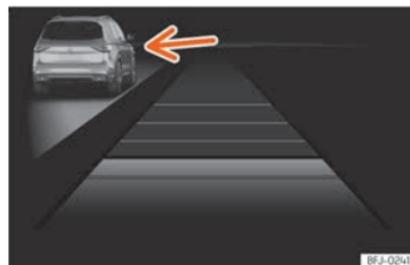
**Abb. 184** Am Bildschirm des Kombi-Instruments: ACC aktiv, Fahrzeug auf der linken Seite erkannt
