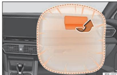
Abb. 19 Beifahrerairbag in der Instrumententafel
