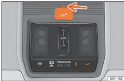
**Abb. 37** In der Dachkonsole: Schalter für Sprachdienste
