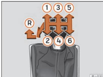
**Abb. 168** Schaltschema des 6-Gang-Schaltgetriebes.
