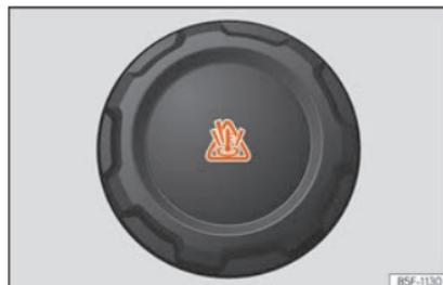
Abb. 236 Motorraum: Deckel des Motorkühlmittelausgleichsbehälters.
