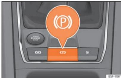
**Abb. 198** Im unteren Teil der Mittelkonsole: Taste für elektronische Parkbremse.
