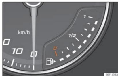
**Abb. 68** Analoges Kombi-Instrument: Kraftstoffvorratsanzeige
