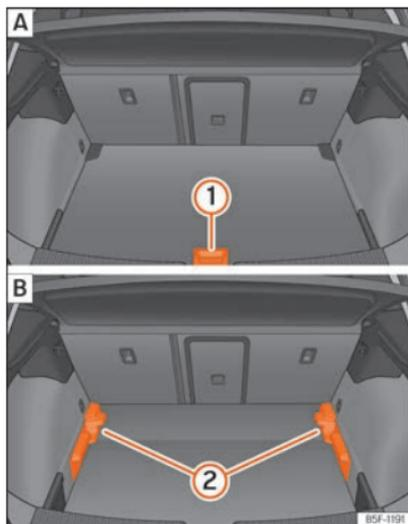
**Abb. 132** Variabler Gepäckraumboden: **A** Hochstellung; **B** Tiefstellung.
