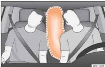
**Abb. 25** Vollständig entfalteter Center-Airbag (Entfaltungsbereich)
