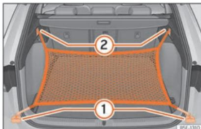
**Abb. 136** Im Gepäckraum: Ösen ① und Haken ② zum Einhängen des Gepäckraumnetzes.
