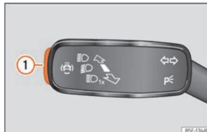
**Abb. 73** Am Blinker- und Fernlichthebel: Taste für die Fahrerassistenzsysteme (modellabhängig).
