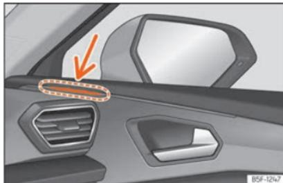
**Abb. 192** Kontrollleuchte des Spurwechselassistenten.
