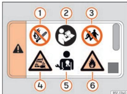
Abb. 241 48-Volt-Fahrzeugbatterie: Gefahrenwarnung
