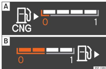
**Abb. 70** Frei konfigurierbares Kombiinstrument: **A**: Erdgasvorratsanzeige. **B**: Benzinvorratsanzeige
