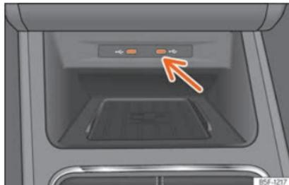
Abb. 163 Mittelkonsole: USB-Eingang.
