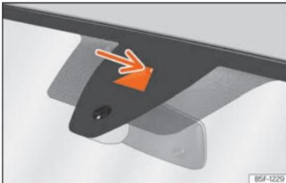
**Abb. 173** An der Windschutzscheibe: Kamerasichtfenster des Spurhalteassistenten.
