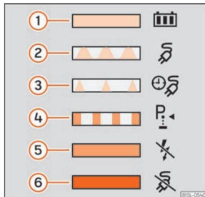
**Abb. 217** Auf der Innenseite der Batterieladeklappe: Aufkleber mit Informationen zur Ladevorgangsanzeige.
