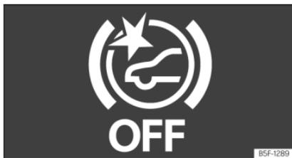
**Abb. 181** Am Bildschirm des Kombi-Instruments: Anzeige, dass Front Assist ausgeschaltet ist.
