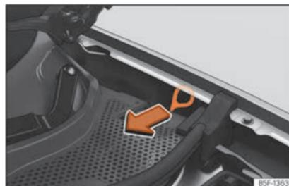
**Abb. 218** Zwischen dem linken Kotflügel und dem Scharnier der Frontklappe: Ziehgriff für manuelle Notentriegelung des Ladesteckers.
