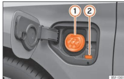
**Abb. 215** Hinter der Batterieladeklappe vorn links: Ladedose
