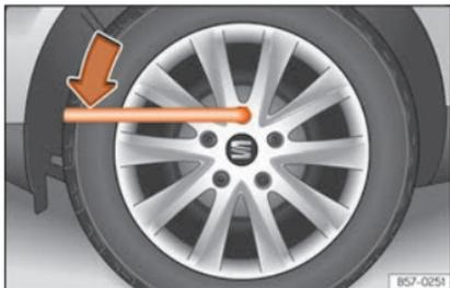
**Abb. 44** Radwechsel: Radschrauben lockern.
