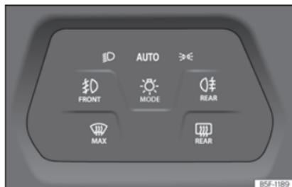
Abb. 103 Instrumententafel: Lichtschalter.
