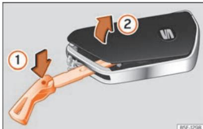
**Abb. 85** Fahrzeugschlüssel: Deckel des Batteriefachs öffnen.
