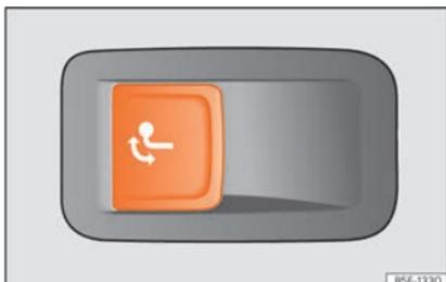
**Abb. 209** Im Gepäckraum links: Taste zur Entriegelung der Anhängerkupplung.
