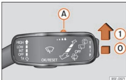
Abb. 109 Scheibenwischerhebel: Regensensor einstellen (A).
