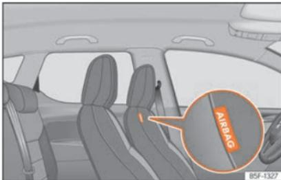
**Abb. 24** Im Sitzlehnenpolster des Fahrerplatzes: Center-Airbag.
