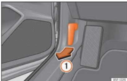
**Abb. 227** Entriegelungshebel im Fahrerfußraum.
