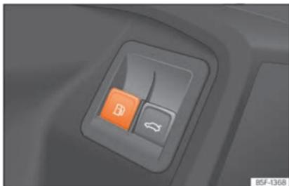
Abb. 222 Fahrertür: Tankklappenentriegelung.
