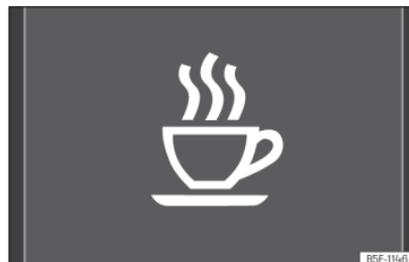
**Abb. 63** Am Bildschirm des Kombi-Instruments: Symbol für Müdigkeitserkennung.
