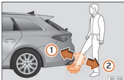
**Abb. 97** Heckklappe mit sensorgesteuerter Öffnung (Easy Open).
