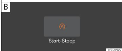
**Abb. 167** Auf dem Bildschirm des Infotainment-Systems: Start-Stopp-System eingeschaltet. **A** Ansicht im Hauptmenü. **B** Ansicht bei ausgeschaltetem Infotainment-System.
