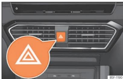
**Abb. 105** Instrumententafel: Schalter für Warnblinkanlage.
