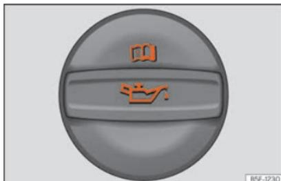
**Abb. 233** Deckel der Motoröl-Einfüllöffnung im Motorraum
