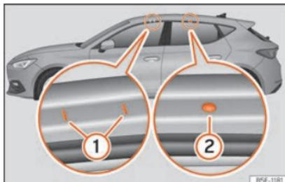
**Abb. 145** Befestigungspunkte der Längsträger für den Dachgepäckträger (Leon).
