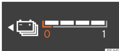
**Abb. 67** Frei konfigurierbares Kombiinstrument: Anzeige des Batterieładezustands.
