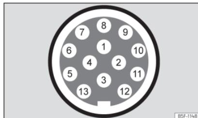
Abb. 208 Schematische Darstellung: Zuweisung der Steckverbinderstifte für Anhängerstrom.
