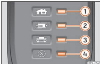
Abb. 221 Am Ladekabel für Netzsteckdosen: Kontrollleuchte in der Schutzeinrichtung.
