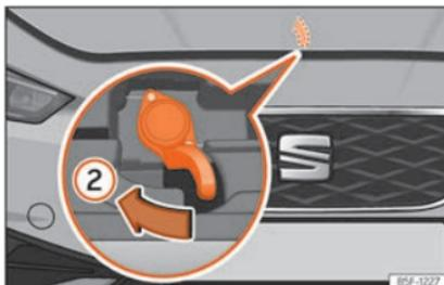
**Abb. 228** Hebel unter der Motorraumklappe.
