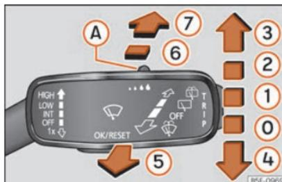
**Abb. 108** Bedienung von Windschutz- und Heckscheibenwischer
