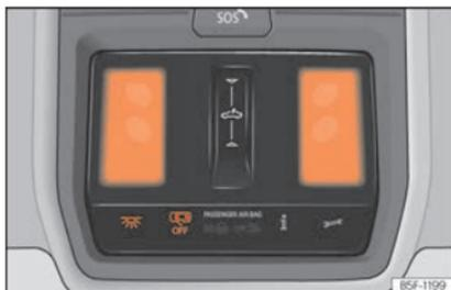
**Abb. 106** Ausschnitt aus Dachhimmel:: Innenraumbeleuchtung vorn.
