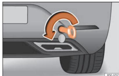
**Abb. 55** Auf der rechten Seite des hinteren Stoßfängers: eingeschraubte Abschleppöse.
