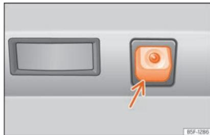
**Abb. 176** Im Stoßfänger hinten: Einbauort der Kamera des Rückfahrassistenten.
