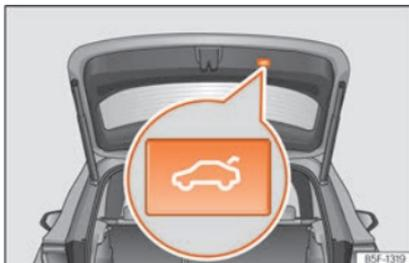
Abb. 95 Heckklappe: Taste zum Schließen der Heckklappe.
