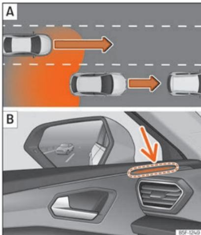
**Abb. 193** Schematische Darstellung: [A] Überholvorgang mit Verkehr im hinteren Bereich. [B] Anzeige des Spurwechselassistenten an der Kontrollleuchte links.
