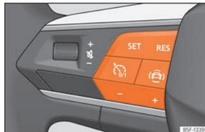
**Abb. 178** Am Multifunktionslenkrad: Tasten zum Bedienen des Geschwindigkeitsbegrenzers
