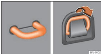
Abb. 134 Im Gepäckraum: feststehende und herausklappbare Verzurrösen.
