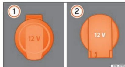
**Abb. 150** 12-Volt-Steckdose: ① in der Armlehne vorn, ② im Kofferraum.
