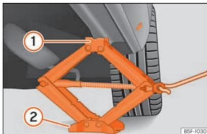
**Abb. 47** Längsholm: Wagenheber ansetzen.
