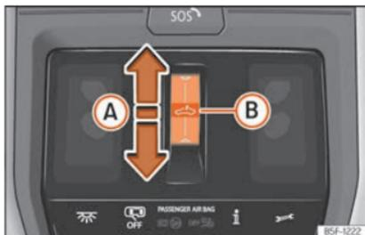
**Abb. 101** Im Dachhimmel: Taste des Glasdachs.
