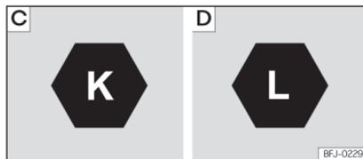
**Abb. 214** Kennzeichnung Gleichstrom [DC] und CCS-Fahrzeugstecker
