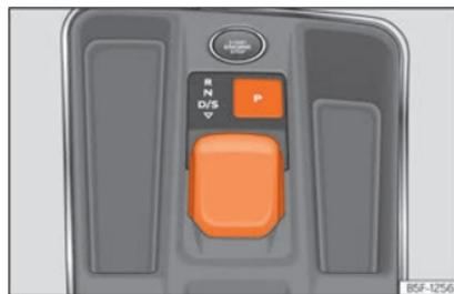
**Abb. 169** In der Mittelkonsole: Wahlschalter.
