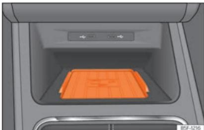
**Abb. 162** In der Mittelkonsole: Aufnahme für die Mobiltelefonkopplung.
