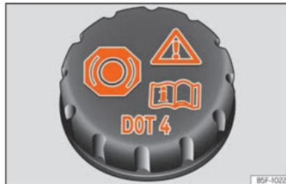
Abb. 237 Motorraum: Deckel des Bremsflüssigkeitsbehälters.
