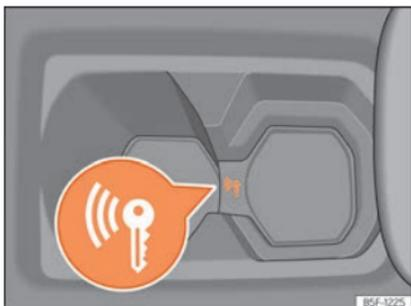
Abb. 166 In der Mittelkonsole: Notstart.
