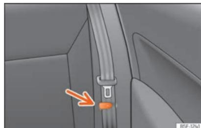
Abb. 120 Rücksitz: Bügel zum Halten des Sicherheitsgurtes.
