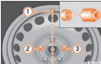
**Abb. 45** Radwechsel: Reifenventil ① und Einbauort der Anti-Diebstahl-Radschraube ② oder ③.
