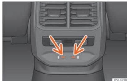
Abb. 164 Mittelkonsole hinten: USB-Anschlüsse mit Steckdosenfunktion.
