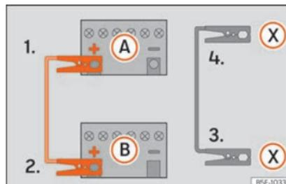
**Abb. 51** Anschlussschema für Fahrzeuge mit Start-Stopp-System.
