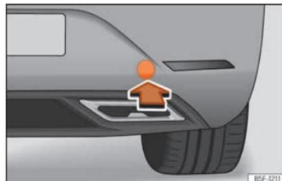
**Abb. 54** Auf der rechten Seite des hinteren Stoßfängers: Abdeckung entfernen.
