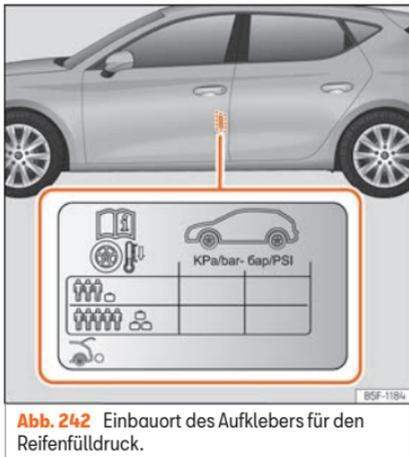
**Abb. 242** Einbauposition des Aufklebers für den Reifendruck.
