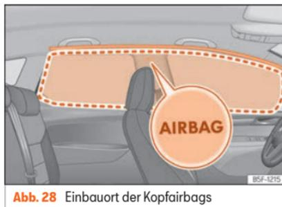
Abb. 28 Einbauort der Kopfairbags
