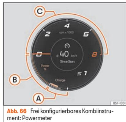
**Abb. 66** Frei konfigurierbares Kombiinstrument: Powermeter
