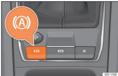
**Abb. 199** Im unteren Teil der Mittelkonsole: Taste für die Auto Hold-Funktion.
