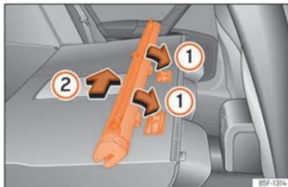
Abb. 143 Einbau der Netztrennwand an den Rücksitzlehnen
