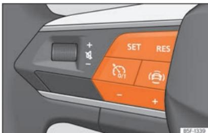
**Abb. 177** Am Multifunktionslenkrad: Tasten zum Bedienen der Geschwindigkeitsregelanlage
