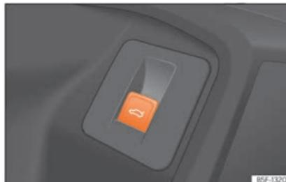
Abb. 96 An der Fahrertür: Taste zum Öffnen und Schließen der Heckklappe.
