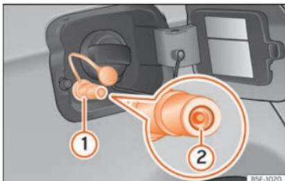
**Abb. 224** Geöffnete Tankklappe: Gas-Einfüllstutzen ①, Dichting des Einfüllstutzens ②.
