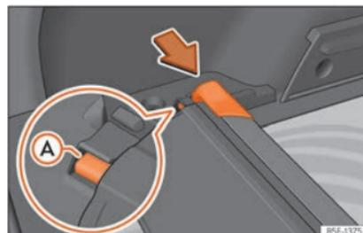
**Abb. 131** Im Gepäckraum: Aufnahme zum Verstauen der aufrollbaren Abdeckung.
