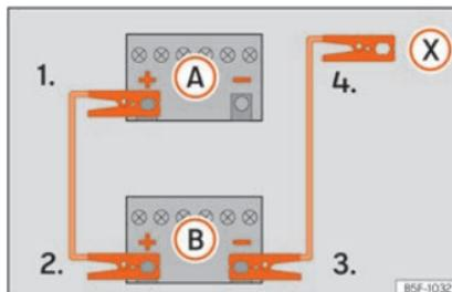
**Abb. 50** Anschlussschema für Fahrzeuge ohne Start-Stopp-System.
