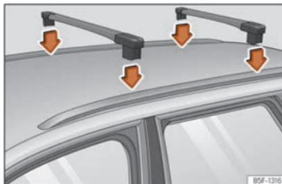
**Abb. 146** Längsträger für den Dachgepäckträger (Leon Sportstourer).
