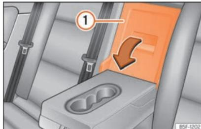
**Abb. 139** An der Rücksitzlehne: Öffnung der Durchladeeinrichtung.
