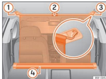
Abb. 144 Im Gepäckraum: eingehängtes Trennnetz bei vorgeklappter Rücksitzlehne.
