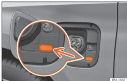
**Abb. 216** Hinter der Batterieladeklappe: Ladevorgangsanzeige.
