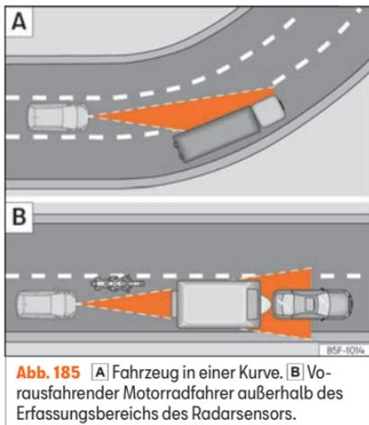
**Abb. 185** [A] Fahrzeug in einer Kurve. [B] Vorausfahrender Motorradfahrer außerhalb des Erfassungsbereichs des Radarsensors.
