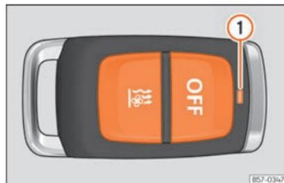
Abb. 155 Standheizung: Funkfernbedienung.
