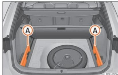
**Abb. 130** Im Gepäckraum: Aufnahme zum Verstauen der aufrollbaren Abdeckung.
