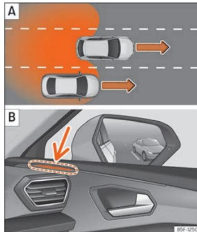
**Abb. 194** Schematische Darstellung: [A] Überholvorgang auf der mittleren Spur und anschließender Wechsel auf die rechte Fahrbahn. [B] Anzeige des Spurwechselassistenten an der Kontrollleuchte rechts.
