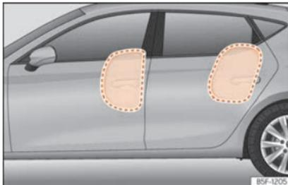
Abb. 27 Kompletzt aufgeblasene Seitenairbags auf der linken Fahrzeugseite
