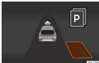
**Abb. 200** Am Bildschirm des Kombi-Instruments: Anzeige des Parklenkassistenten mit eingeschränkter Sicht.
