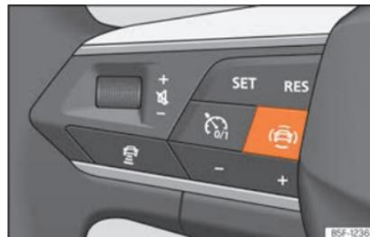
**Abb. 74** Linke Seite des Multifunktionslenkrads: Taste für die Fahrerassistenzsysteme (modellabhängig).
