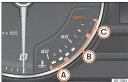
**Abb. 71** Analoges Kombi-Instrument: Motor-Kühlmittel-Temperaturanzeige.
