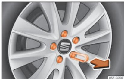
**Abb. 42** Rad: Radschrauben mit Deckel.
