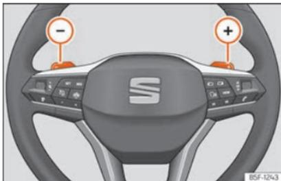
**Abb. 170** Lenkrad: Hebel für Automatikgetriebe.
