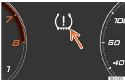
**Abb. 245** Kombi-Instrument: Warnung Reifendruckverlust.
