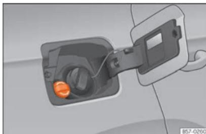
**Abb. 226** Verschlussdeckel des AdBlue-Tanks
