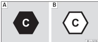
**Abb. 213** Kennzeichnung Wechselstrom [AC] und Stecker Typ 2.
