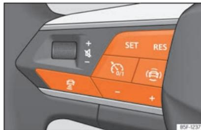
**Abb. 182** Am Multifunktionslenkrad: Tasten zur ACC-Bedienung
