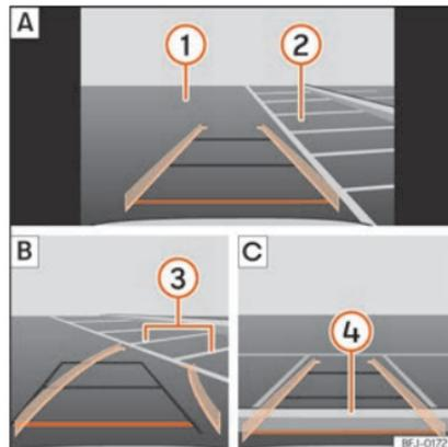
**Abb. 207** Anzeige auf dem Bildschirm des Infotainment-Systems: einparken mit dem Rückfahrassistenten.
