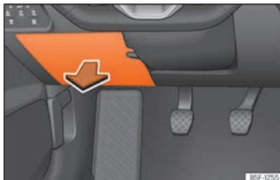
**Abb. 56** Auf der Fahrerseite in der Instrumententafel: Abdeckung des Sicherungskasten.
