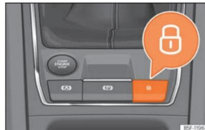
**Abb. 88** In der Mittelkonsole: Zentralverriegelungstaster **»**
