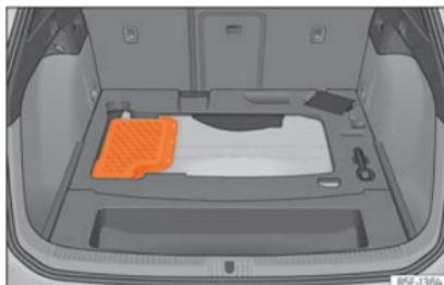
**Abb. 239** Plug-in-Hybridfahrzeuge (PHEV): Einbauort der Batterie im Kofferraum
