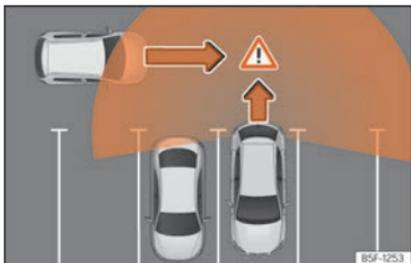
**Abb. 195** Schematische Abbildung des Ausparkassistenten: Überwachter Bereich des ausparkenden Fahrzeugs.
