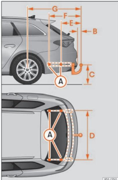
**Abb. 210** Maße und Befestigungspunkte für den nachträglichen Einbau einer Anhängervorrichtung
