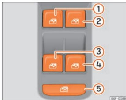
**Abb. 100** Ausschnitt aus der Fahrertür: Schalter für die Fenster.
