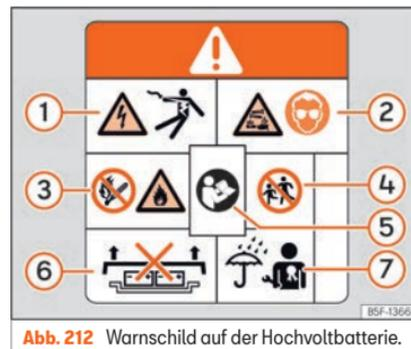
Abb. 212 Warnschild auf der Hochvoltbatterie.
