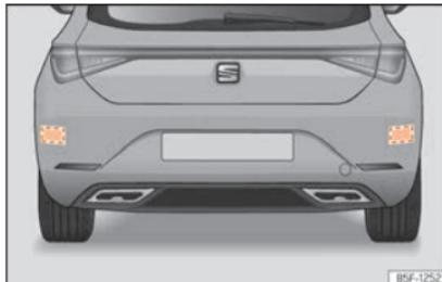
**Abb. 174** Heckansicht des Fahrzeugs: Bereiche der Radarsensoren.
