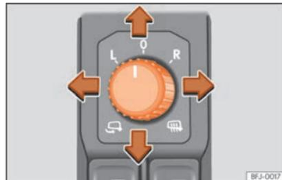
**Abb. 111** Ausschnitt aus der Fahrertür: Drehknopf für den Außenspiegel.
