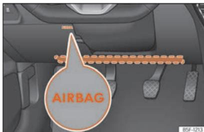
**Abb. 22** Auf der Fahrerseite: Einbauort des Knieairbags.
