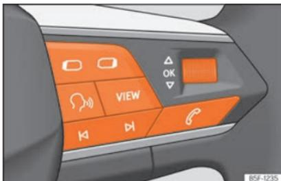
**Abb. 72** Rechte Seite des Multifunktionslenkrads: Bedienelemente für die Menüs und Informationsanzeigen im Kombi-Instrument.
