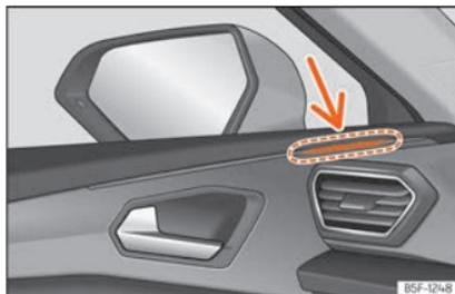
**Abb. 191** Kontrollleuchte des Spurwechselassistenten.
