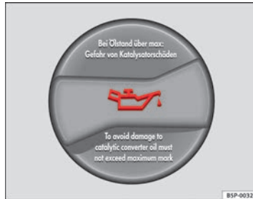
Abb. 125 Deckel der Motoröl-Einfüllöffnung im Motorraum
