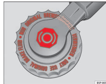
Abb. 132 Im Motorraum: Abdeckung des Bremsflüssigkeitsbehälters ▶
