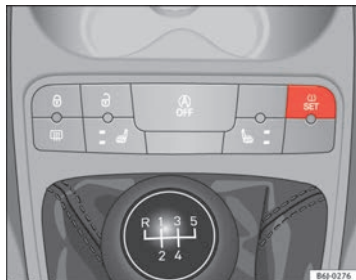
Abb. 40 Mittelkonsole: Taste für die Reifenkontrollanzeige
