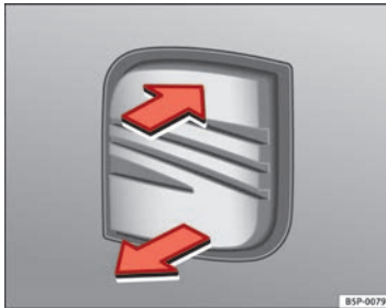
Abb. 47 Heckklappe: Öffnen von außen
