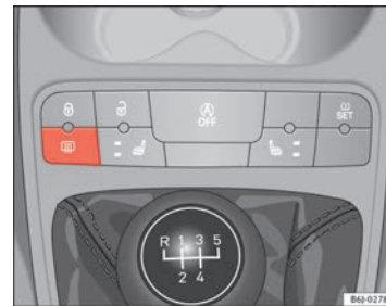
Abb. 57 Ausschnitt aus der Mittelkonsole: Schalter für Heckscheibenbeheizung
