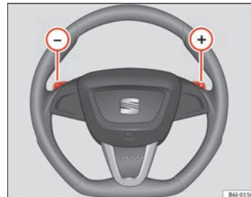
Abb. 108 Lenkrad mit Schaltwippen für Automatikgetriebe
