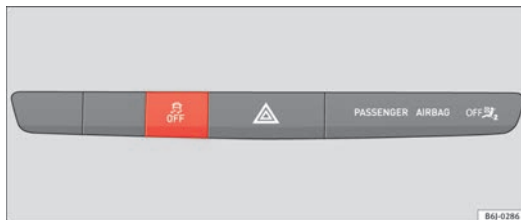
Abb. 97 Ausschnitt von der Instrumententafel: ESC-Taste
