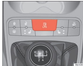
Abb. 99 Mittelkonsole: Kontrollschalter für Autogasanlage.
