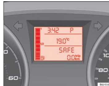
Abb. 36 Display: Wählhebelstellung des Automatikgetriebes
