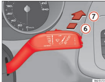
Abb. 65 Scheibenwischer- und Scheibenwascherhebel; Scheibenwischer für die Heckscheibe
