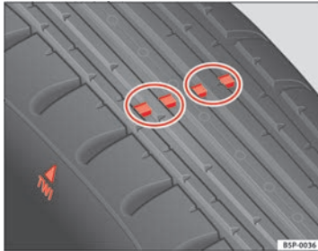
Abb. 133 Prinzipdarstellung Reifenprofil: Verschleißanzeiger
