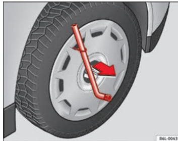
Abb. 135 Die Radvollblende vom Rad abnehmen
