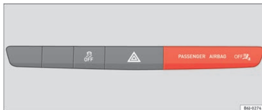
Abb. 22 Kontrollleuchte für Abschaltung der Beifahrerairbags
