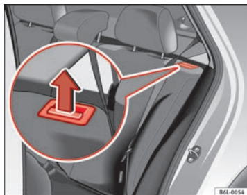
Abb. 74 Entriegelungstaste der Rücksitzlehne
