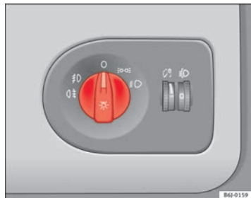
Abb. 53 Ausschnitt aus der Instrumententafel: Schalter für die Leuchten, Nebelscheinwerfer und Nebelschlussleuchte
