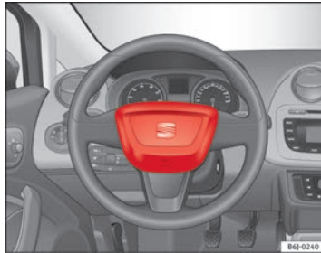
Abb. 16 Einbauort Fahrerairbag: im Lenkrad
