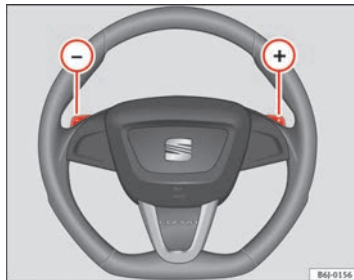
Abb. 108 Lenkrad mit Schaltwippen für Automatikgetriebe
