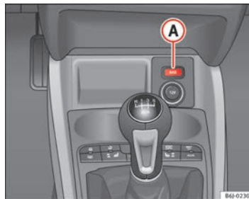
Abb. 99 Mittelkonsole: Kontrollschalter für Autogasanlage.
