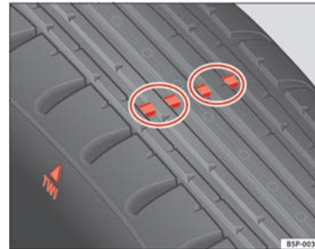
Abb. 133 Prinzipdarstellung Reifenprofil: Verschleißanzeiger
