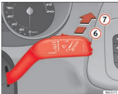
Abb. 63 Scheibenwischer- und Scheibenwaschhebel: Heckscheibenwischer
