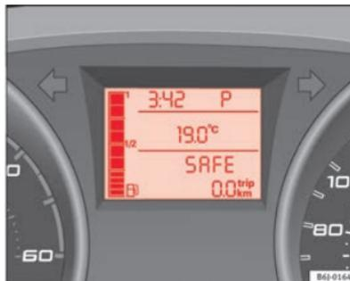
Abb. 101 Automatikgetriebe: Display des Kombiinstrumentes
