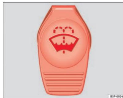
Abb. 120 Im Motorraum: Deckel des Scheibenwaschwasserbehälters
