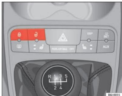
Abb. 41 Taster für Zentralverriegelung
