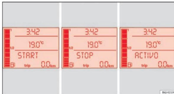
Abb. 97 Anzeige am Display des Kombiinstrumentes während des Start-Stopp-Betriebs
