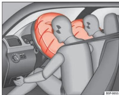
**Abb. 18** Aufgeblasene Frontairbags
