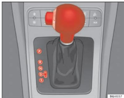
Abb. 103 Schalten mit Tiptronic
