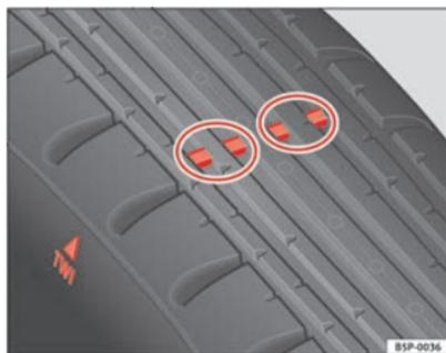
Abb. 124 Prinzipdarstellung Reifenprofil: Verschleißanzeiger
