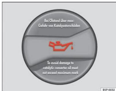
Abb. 118 Deckel der Motoröl-Einflüllöffnung im Motorraum
