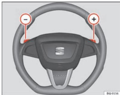
Abb. 104 Lenkrad mit Schaltwippen für Automatikgetriebe
