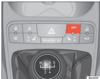
Abb. 94 Ansicht der Mittelkonsole: ESP-Taste
