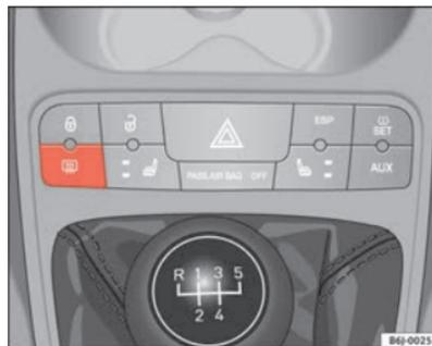
Abb. 55 Mittelkonsole: Schalter für Heckscheibenbeheizung
