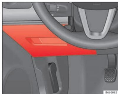
Abb. 132 Sicherungen in der Instrumententafel
