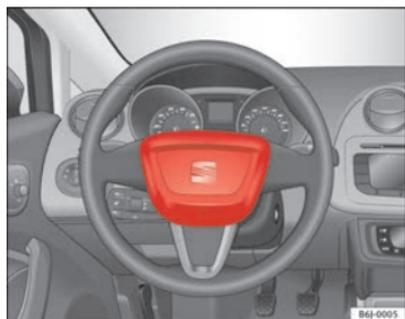
Abb. 16 Einbauort
