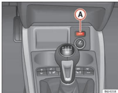
Abb. 96 Ansicht des Tasters für den Start-Stopp-Betrieb
