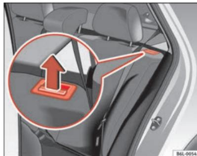
Abb. 72 Entriegelungstaste der Rücksitzlehne
