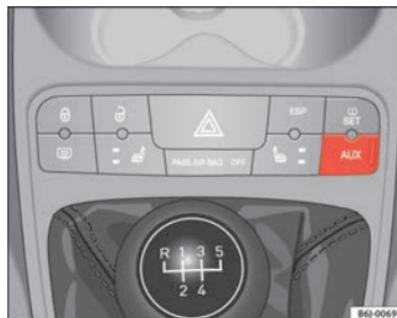
Abb. 84 AUX-Anschluss an der Mittelkonsole (ausstattungsabhängig)
