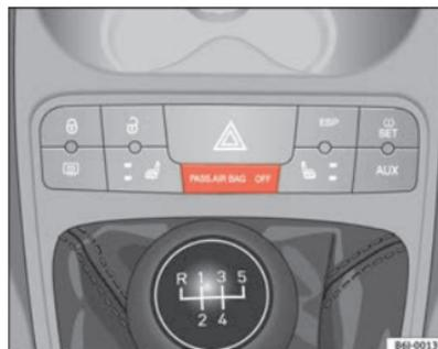
Abb. 22 Kontrollleuchte für Abschaltung der Beifahrerairbags
