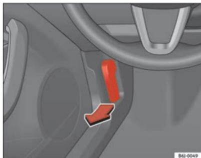
Abb. 115 Öffnungshebel für Motorraumklappe
