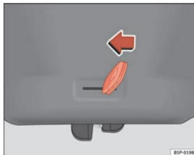
Abb. 47 Heckklappe: Notöffnung
