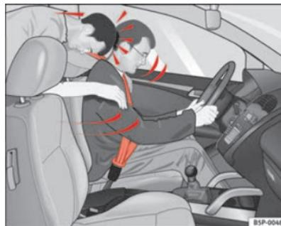
**Abb. 9** Der nicht angegurte Mitfahrer auf dem Rücksitz wird nach vorne auf den angegurten Fahrer geschleudert.
