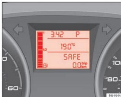
**Abb. 35** Display: Wählhebelstellung des Automatikgetriebes
