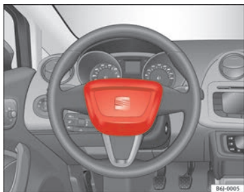
Abb. 16 Einbauort Fahrerairbag: im Lenkrad
