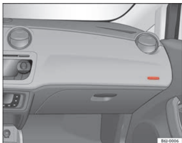
Abb. 17 Einbauort Beifahrerairbag: in der Instrumententafel
