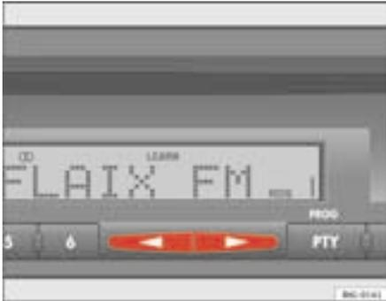
Abb. 20 Mit dem automatischen Sendersuchlauf Sender einstellen
