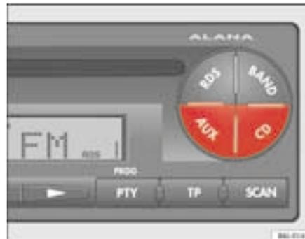
Abb. 32 Verborgene Funktionen mit der Taste CD/CD6 aktivieren
