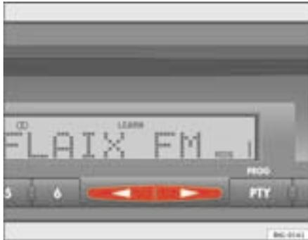
Abb. 23 Mit dem automatischen Sendersuchlauf AM-Sender einstellen
