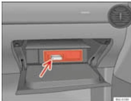
Abb. 35 Anschluss des iPod
