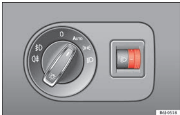
Abb. 127 Instrumententafel: Regler für Leuchtweitenregulierung.
