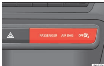
Abb. 43 Kontrollämpchen für Abschaltung des und Beifahrerairbags.
