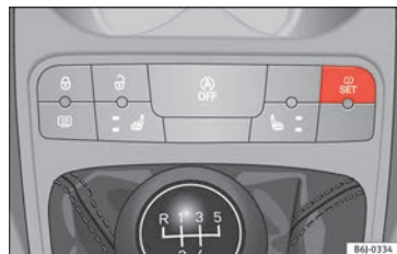
Abb. 179 Mittelkonsole: Taste für die Reifenkontrollanzeige
