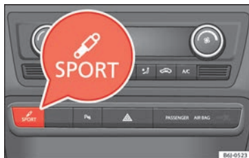
Abb. 171 In der Mittelkonsole: Taste zur Einstellung des Systems "SEAT Drive Profile"
