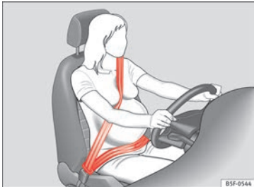
Abb. 83 Gurtbandverlauf bei schwangeren Frauen.
