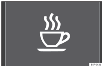
Abb. 163 Im Display des Kombiinstrumentes: Symbol der Müdigkeitserkennung.
