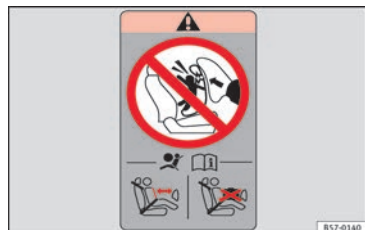
Abb. 23 Im hinteren Rahmen der Beifahrertür: Aufkleber mit Angaben zum Airbag.
