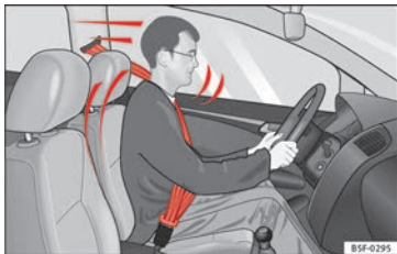
Abb. 79 Richtig angegurte Fahrer werden bei einem plötzlichen Bremsmanöver nicht nach vorne geschleudert.
