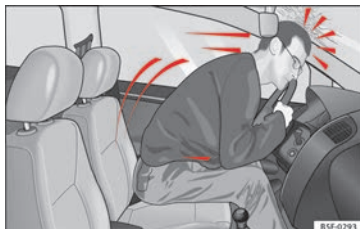
Abb. 80 Der nicht angegurtete Fahrer schleudert nach vorn.
