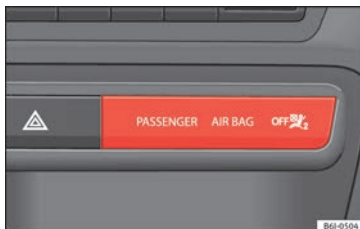
Abb. 85 Instrumententafel-Mittelteil: Kontrollleuchte für abgeschalteten Beifahrer-Frontairbag.
