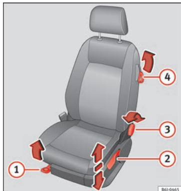
Abb. 10 Vordersitze: Manuelle Sitzverstellung.
