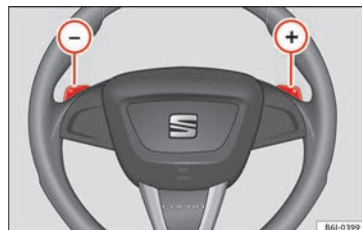
Abb. 137 Lenkrad mit Schaltwippen für Automatikgetriebe.
