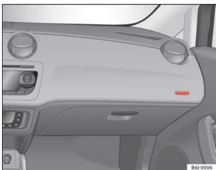
Abb. 17 Einbauort Beifahrerairbag: in der Instrumententafel
