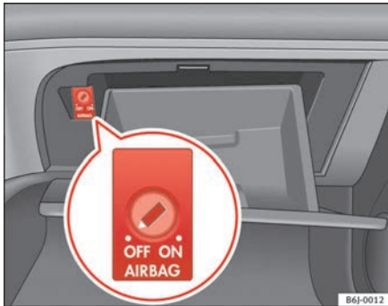
Abb. 23 Im Handschuhfach: Schlüsselschalter zum An- und Abschalten des Beifahrerairbags.
