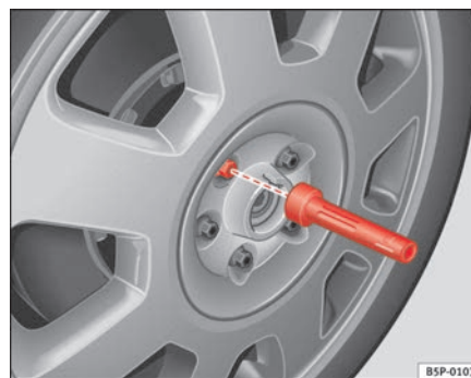
Abb. 139 Radwechsel: Innensechskant zum Drehen der Schrauben
