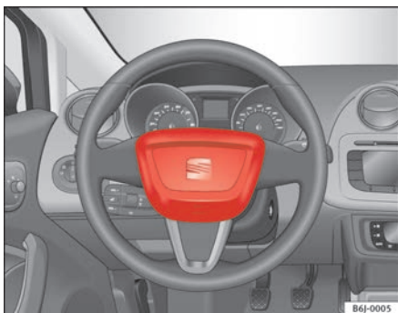
Abb. 16 Einbauort Fahrerairbag: im Lenkrad
