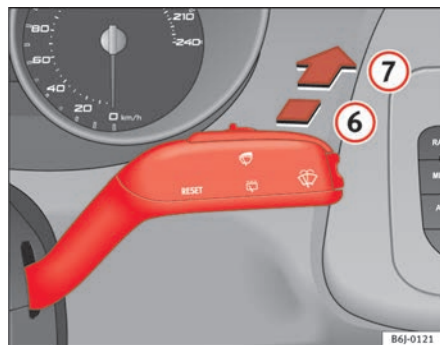
Abb. 62 Scheibenwischer- und Scheibenwaschhebel: Heckscheibenwischer
