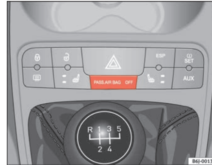
Abb. 24 Kontrollleuchte für Abschaltung der Beifahrerairbags
