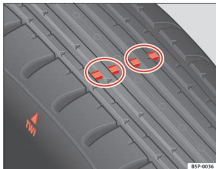
Abb. 133 Prinzipdarstellung Reifenprofil: Verschleißanzeiger
