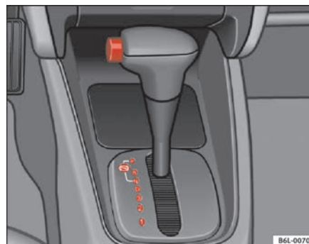
Abb. 102 Ausschnitt aus der Mittelkonsole: Wählhebel vom Automatikgetriebe
