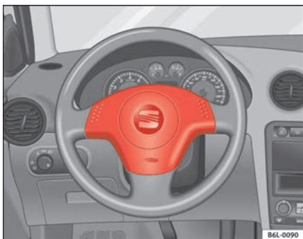
Abb. 17 Einbauort Fahrerairbag: im Lenkrad
