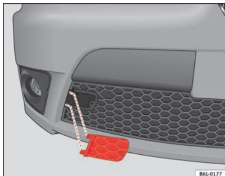
Abb. 173 Deckel der Abschleppöse unten am mittleren Gitter
