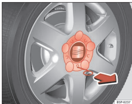
Abb. 139 Radwechsel: Radzierkappe abziehen
