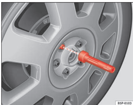
Abb. 144 Radwechsel: Innensechskant zum Drehen der Schrauben
