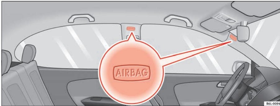
Abb. 23 Einbauort der Kopfairbags auf der linken Fahrzeugseite
