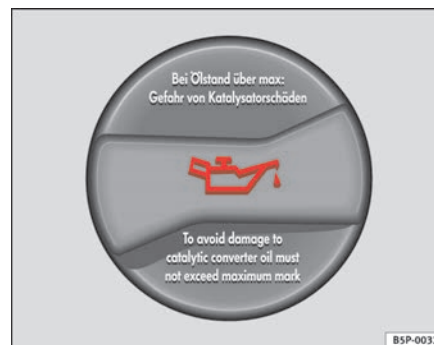
Abb. 128 Deckel der Motoröl-Einfüllöffnung im Motorraum
