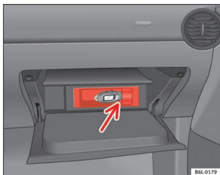
Abb. 89 Anschluss USB* im Handschuhfach auf der Beifahrerseite.
