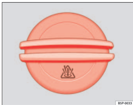
Abb. 124 Im Motorraum: Deckel des Kühlmittel- Ausgleichsbehälters
