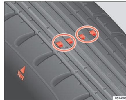
Abb. 129 Prinzipdarstellung Reifenprofil: Verschleißanzeiger ▶
