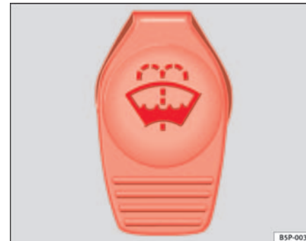
Abb. 125 Im Motorraum: Deckel des Scheibenwaschwasserbehälters
