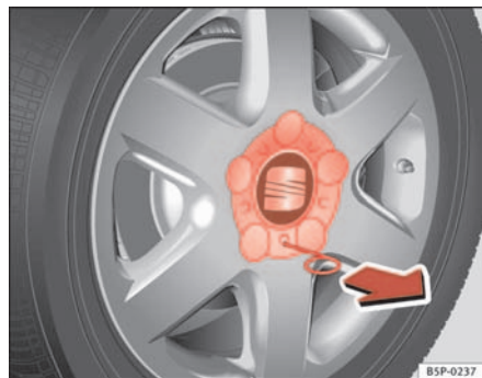
Abb. 131 Radwechsel: Radzierkappe abziehen
