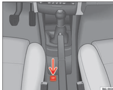
Abb. 93 Ausschnitt aus der Mittelkonsole: ESP-Taste
