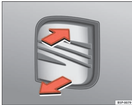
Abb. 50 Heckklappe: Öffnen von außen
