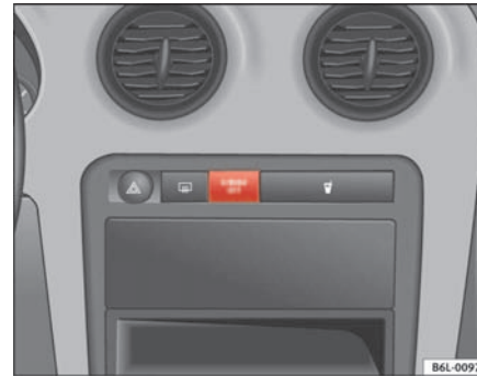
Abb. 26 Kontrollleuchte für Abschaltung der Beifahrerairbags
