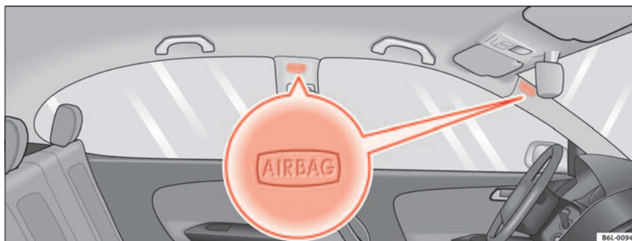
Abb. 23 Einbauort der Kopfairbags auf der linken Fahrzeugseite
