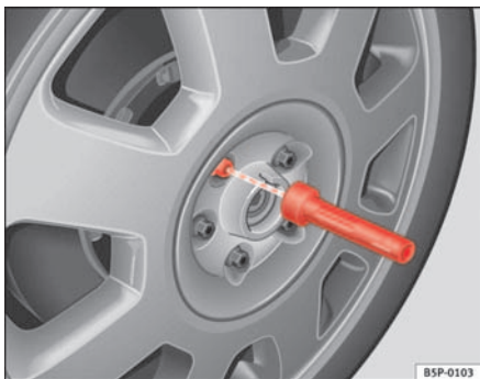
Abb. 136 Radwechsel: Innensechskant zum Drehen der Schrauben
