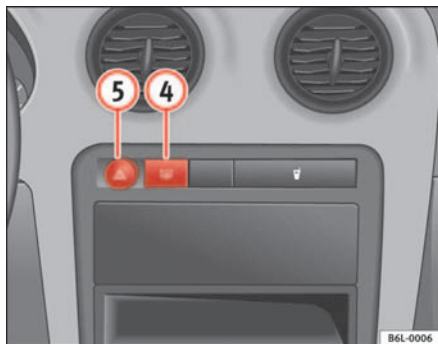
Abb. 58 Instrumententafel: Schalter Heckscheibenheizung
