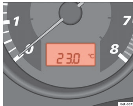
Abb. 38 Display im Kombiinstrument: Außentemperaturanzeige.
