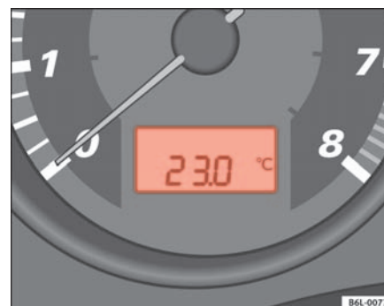
Abb. 36 Display im Kombiinstrument: Außentemperaturanzeige ▶
