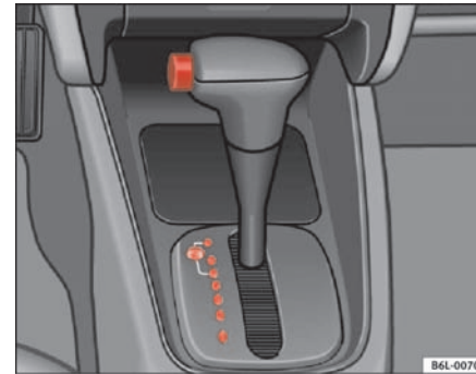
Abb. 96 Ausschnitt aus der Mittelkonsole: Wählhebel vom Automatikgetriebe
