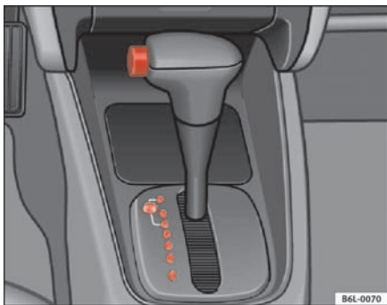
Abb. 97 Ausschnitt aus der Mittelkonsole: Wählhebel vom Automatikgetriebe
