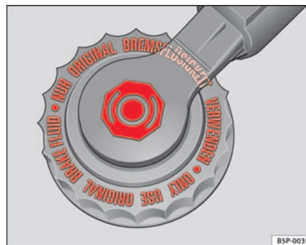
Abb. 128 Im Motorraum: Abdeckung des Bremsflüssigkeitsbehälters
