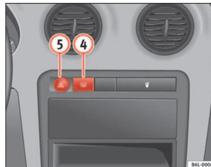
Abb. 59 Ausschnitt aus der Instrumententafel: Schalter für die Warnblinkanlage
