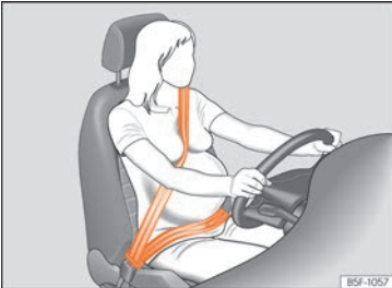
Abb. 27 Gurtbandverlauf bei schwangeren Frauen.
