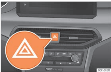
Abb. 44 Instrumententafel: Schalter für die Warnblinkanlage
