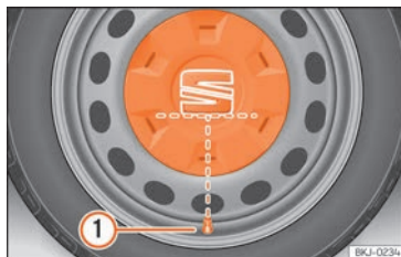
Abb. 184 Korrekte Anbringung der Radvollblende für Stahlfelgen.
