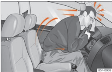
Abb. 22 Der nicht angegurte Fahrer wird nach vorn geschleudert.
