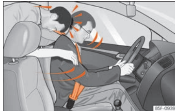
Abb. 23 Der nicht angegurte Mitfahrer auf dem Rücksitz wird nach vorn auf den angegurten Fahrer geschleudert.
