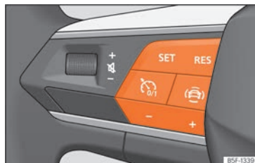
Abb. 103 Am Multifunktionslenkrad: Tasten zur Bedienung des Geschwindigkeitsbegrenzers.
