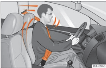
Abb. 20 Richtig angegurte Fahrer werden bei einem plötzlichen Bremsmanöver nicht nach vorne geschleudert.
