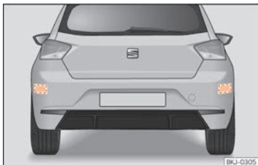
Abb. 99 Bereich hinter dem Fahrzeug: Bereiche der Radarsensoren.
