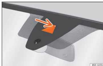
Abb. 98 Kamerasichtfenster des Spurhalteassistenten.
