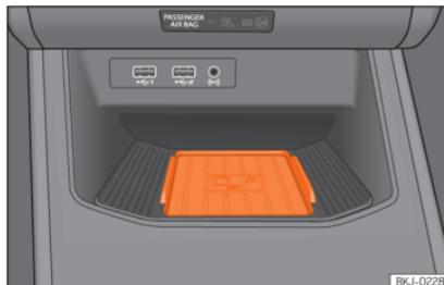
**Abb. 28** Mittelkonsole: Connectivity Box (Arona, Ibiza)
