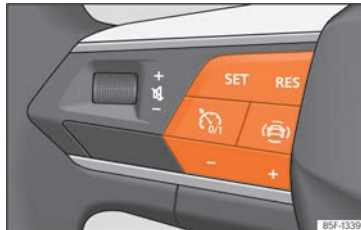
Abb. 148 Am Multifunktionslenkrad: Tasten zum Bedienen der Geschwindigkeitsregelanlage
