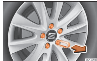
Abb. 34 Rad: Radschrauben mit Deckel.
