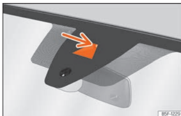
Abb. 144 An der Windschutzscheibe: Kamerasichtfenster des Spurhalteassistenten.
