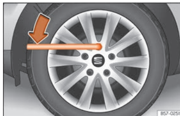
Abb. 36 Radwechsel: Radschrauben lockern.
