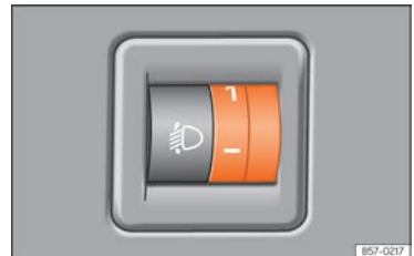
Abb. 99 Neben dem Lenkrad: Regler für die Leuchtweitenregulierung.
