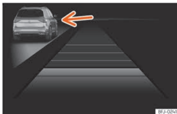
Abb. 154 Am Bildschirm des Kombi-Instruments: ACC aktiv, Fahrzeug auf der linken Seite erkannt
