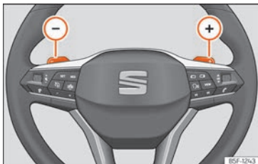
Abb. 139 Lenkrad: Hebel für Automatikgetriebe.
