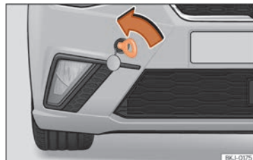
Abb. 46 Stoßfänger vorn rechts: eingeschraubte Abschleppöse.
