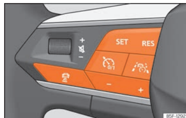
Abb. 160 Linke Seite des Multifunktionslenkrads: Tasten zur Bedienung von Travel Assist.
