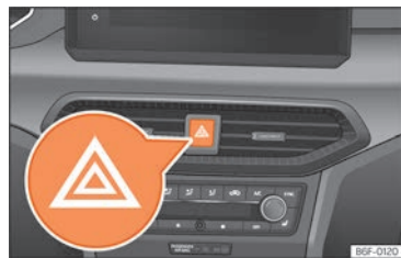
Abb. 98 Instrumententafel: Schalter für Warnblinkanlage. »
