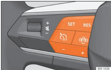
Abb. 149 Am Multifunktionslenkrad: Tasten zum Bedienen des Geschwindigkeitsbegrenzers
