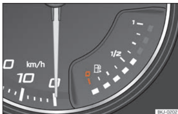
Abb. 66 Analoges Kombi-Instrument: Kraftstoffvorratsanzeige
