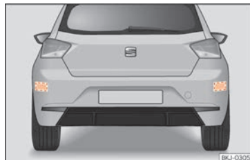
Abb. 145 Heckansicht des Fahrzeugs: Bereiche der Radarsensoren.
