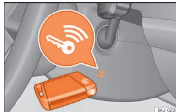
Abb. 134 Rechts an der Lenksäule: Notstart.
