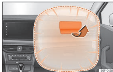
Abb. 15 Beifahrerairbag in der Instrumententafel
