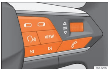
Abb. 71 Rechte Seite des Multifunktionslenkrads: Bedienelemente für die Menüs und Informationsanzeigen im Kombi-Instrument.
