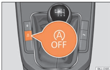
Abb. 135 Mittelkonsole: Taste des Start-Stopp-Systems.
