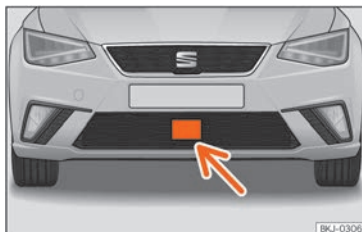
Abb. 142 Am vorderen Stoßfänger: Radarsensor.
