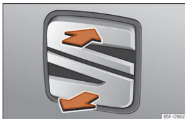
Abb. 90 Heckklappe: Öffnen von außen.
