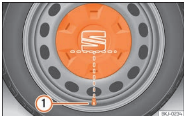
Abb. 32 Korrekte Anbringung der Radvollblende für Stahlfelgen.
