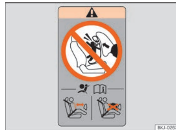
Abb. 23 Airbagaufkleber: Im hinteren Rahmen der Beifahrertür
