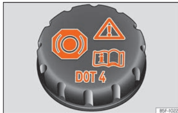
Abb. 193 Motorraum: Deckel des Bremsflüssigkeitsbehälters.
