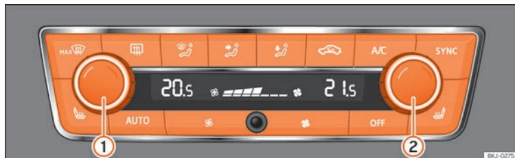
Abb. 122 In der Mittelkonsole: Bedienungselemente der Climatronic.
