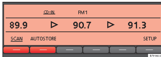
Abb. 6 Radio-Zusatzfunktionen und laufende automatische Sendersuche (SCAN).
