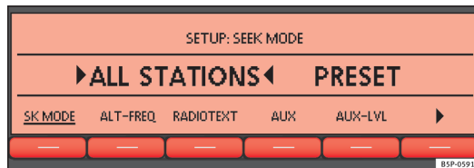
Abb. 25 Menü SETUP: Senderauswahl für die Wipptaste SEEK festlegen.
