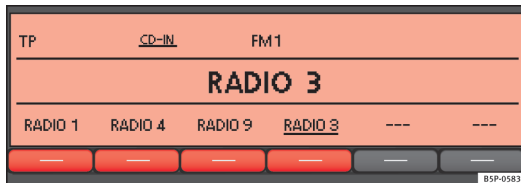
Abb. 9 Anzeige der Sendernamen. TP-Funktion eingeschaltet und funktionsbereit.
