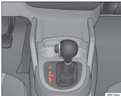
Abb. 146 Ausschnitt aus der Mittelkonsole: Wählhebel des Automatikgetriebes / Direktschaltgetriebes DSG
