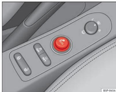
Abb. 116 Der Zigarettenanzünder befindet sich in der Steckdose der vorderen Mittelkonsole
