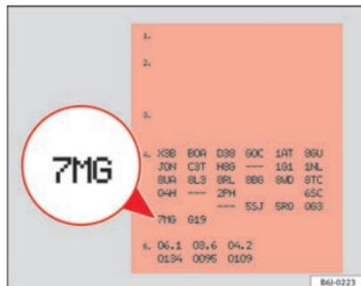
Abb. 157 Fahrzeugdatenträger auf der Rückseite des Service-Plans
