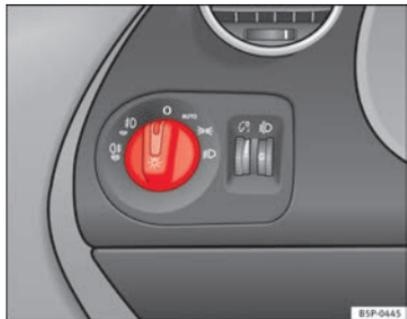
Abb. 70 Ausschnitt aus der Instrumententafel: Schalter für Licht, Nebelscheinwerfer und Nebelschlussleuchte
