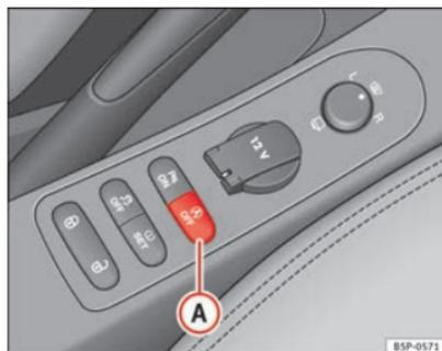
Abb. 142 Ansicht des Tasters für den Start-Stopp-Betrieb
