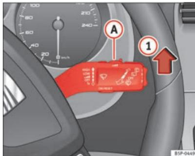
Abb. 85 Scheibenwischerhebel
