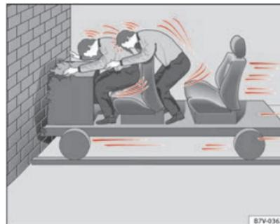
**Abb. 8** Prinzipdarstellung: Das Fahrzeug prallt mit nicht angegurtenen Insassen gegen die Mauer
