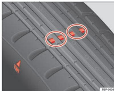
Abb. 176 Prinzipdarstellung Reifenprofil: Verschleißanzeiger
