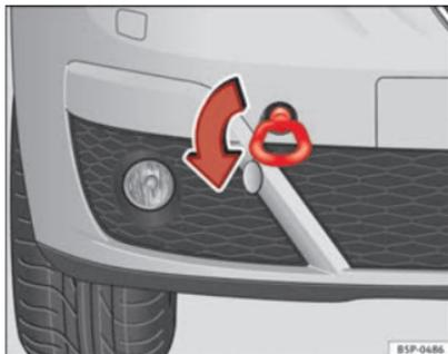
Abb. 216 Frontpartie rechts: Einschrauben der vorderen Abschleppöse
