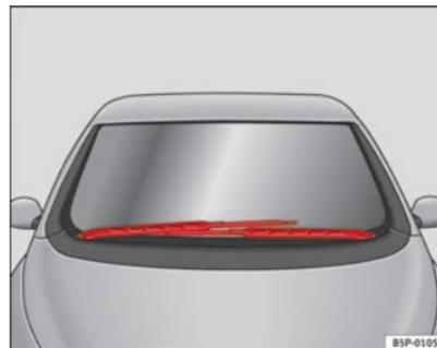
Abb. 170 Scheibenwischer in Service-Stellung
