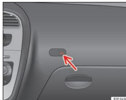
Abb. 27 Kontrollleuchte für Abschaltung der Beifahrerairbags
