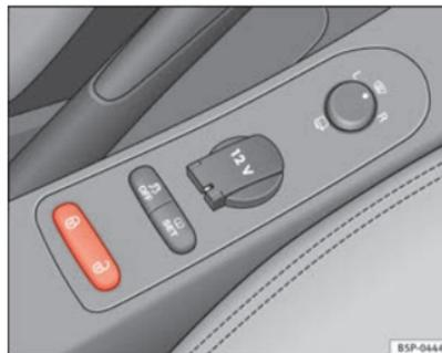
Abb. 57 Ausschnitt der Mittelkonsole: Zentralverriegelungstaster
