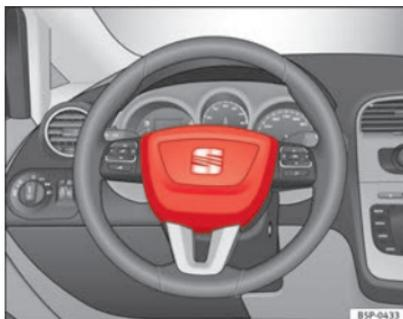
**Abb. 18 Einbauort Fahrerairbag: im Lenkrad**
