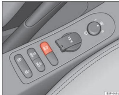
Abb. 153 Mittelkonsole: Schalter für Einparkhilfe
