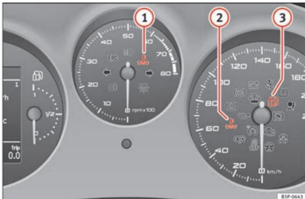
Abb. 49 Kombiinstrument mit Warn- und Kontrollleuchten bei Fahrzeugen mit Autogasanlage.
