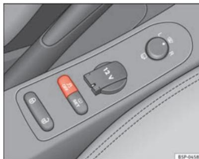
**Abb. 139** Ausschnitt aus der Mittelkonsole: ESC-Taste.
