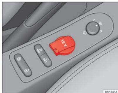
Abb. 117 Steckdose an der Mittelkonsole vorne
