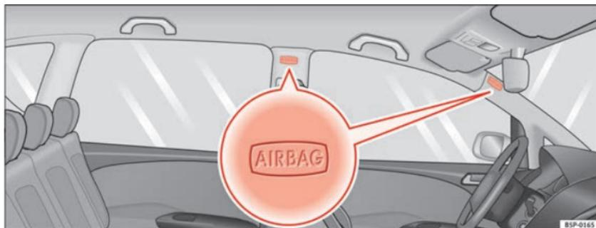
**Abb. 24** Einbauort der Kopfairbags auf der linken Fahrzeugseite
