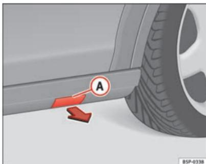
Abb. 183 Kunststoff-Trittleiste mit Deckel zur Aufnahme des Wagenhebers
