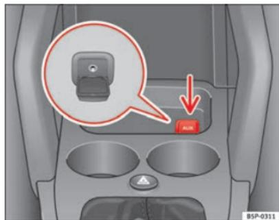
Abb. 119 Anschluss für einen zusätzlichen Audio-Eingang
