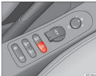
Abb. 141 Mittelkonsole: Kontrollschalter für Autogasanlage.
