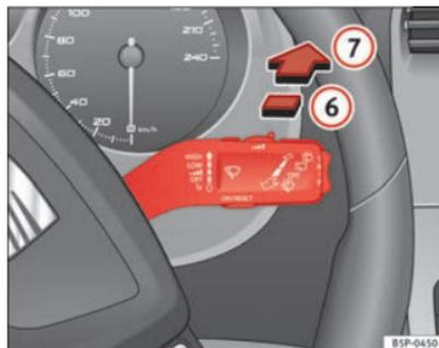
Abb. 86 Scheibenwischer- und Scheibenwascherhebel: Scheibenwischer für die Heckscheibe
