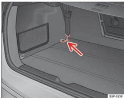
Abb. 128 Verzurösen zum Spannen des Gepäckraumnetzes
