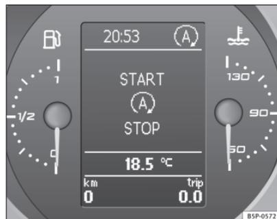
Abb. 143 Anzeige am Display des Kombiinstruments während des Start-Stopp-Betriebs
