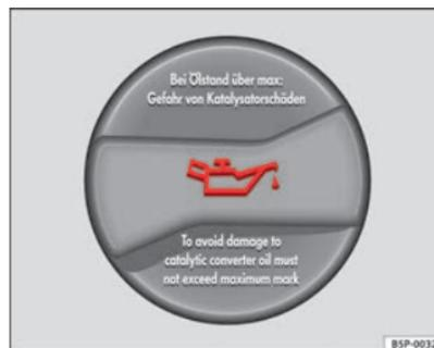
Abb. 167 Deckel der Motoröl-Einfüllöffnung im Motorraum
