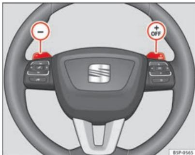
Abb. 151 Lenkrad mit Wippen für Automatikgetriebe
