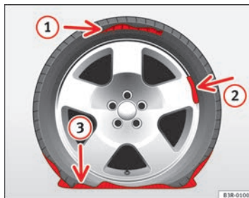
Abb. 200 Reifenschäden für die das Tire-Mobility-System nicht geeignet ist
