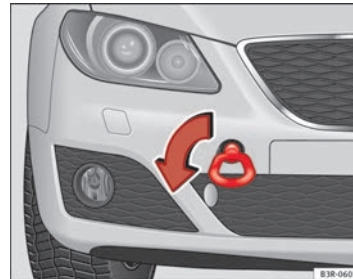
Abb. 246 Einschrauben der Abschleppöse vorne am Fahrzeug
