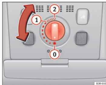
Abb. 82 Ausschnitt aus Dachhimmel: Drehschalter für das Schiebe-/Ausstelldach
