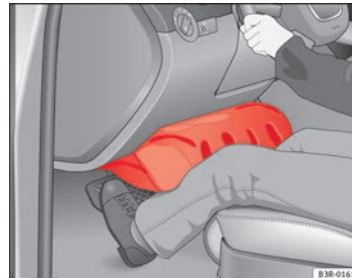
Abb. 22 Die aufgeblasenen Airbags schützen bei einem Frontaufprall
