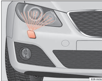
Abb. 101 Scheinwerfer mit ausgefahrener Waschdüse
