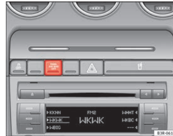
Abb. 28 Kontrollleuchte für Abschaltung der Beifahrerairbags
