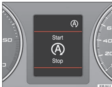
Abb. 148 Anzeige am Display des Kombiinstrumentes während des Start-Stopp-Betriebs
