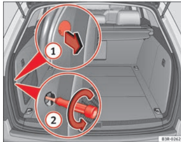
Abb. 223 Gepäckraum: Lage der Befestigungs- schraube der Heckleuchte
