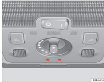
Abb. 93 Ausschnitt aus dem Dachhimmel: Ambientebeleuchtung
