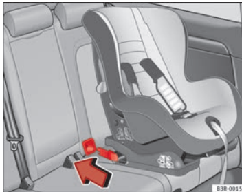
Abb. 33 Die ISOFIX-Rastarme des Kindersitzes lassen sich über die bereits angebrachten Plastikföhhrungen einföhren, bis sie in den ISOFIX-Verankerungen des Fahrzeugs einrasten.
