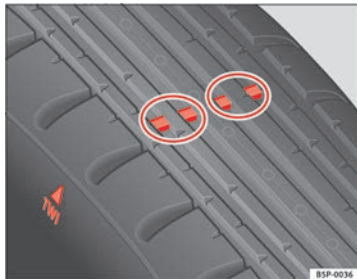
Abb. 190 Prinzipdarstellung Reifenprofil: Verschleißanzeiger
