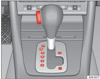
Abb. 157 Ausschnitt aus Mittelkonsole: Wählhebel mit Sperrtaste
