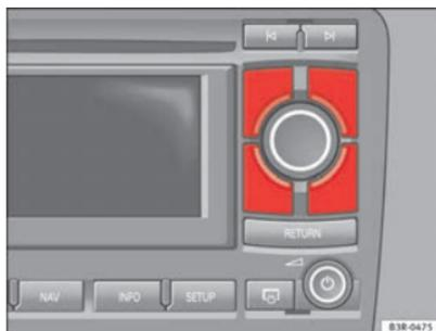
Abb. 7 Navigations-system: Steuerungstasten
