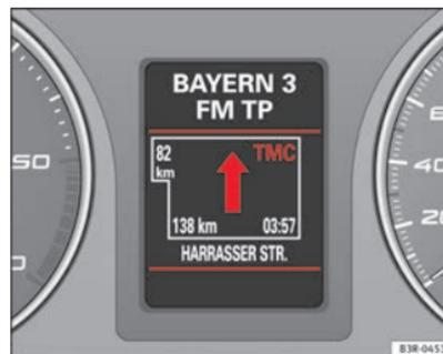
Abb. 129 Display des Kombiinstrument: Beispiel TMC-Symbol rot
