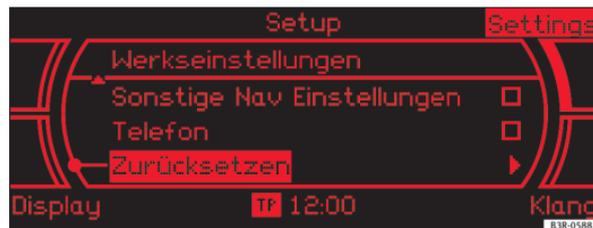
Abb. 135 Setup: Zurücksetzen der gewählten Systeme
