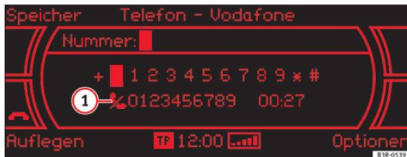
Abb. 76 Telefon: Anruf stumm geschaltet (Mikrofon aus)
