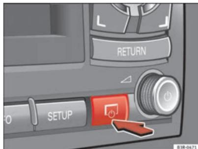
Abb. 3 Navigations-system: Taste zum Ein- und Ausschalten des Displays
