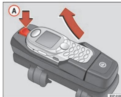
**Abb. 67 Mobiltelefon aus dem Mobiltelefon-Adapter herausnehmen**
