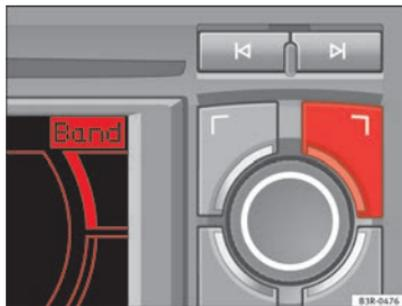
Abb. 8 Navigations-system: Zuordnung von Steuerungstasten und Tastensymbolen in den Ecken des Displays
