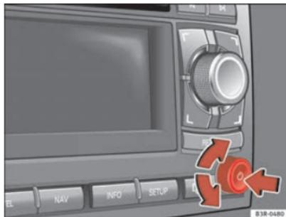
Abb. 12 Navigationssystem: Stummschaltung (Mute)
