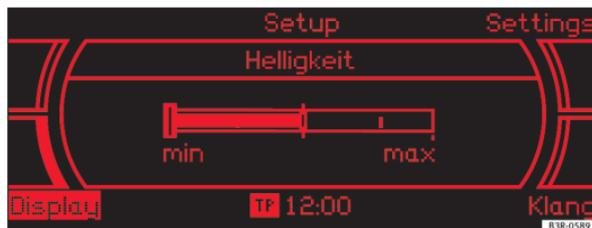
Abb. 136 Setup: Helligkeit des Displays einstellen
