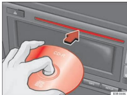
Abb. 29 CD-Spieler: CD in das Laufwerk einführen
