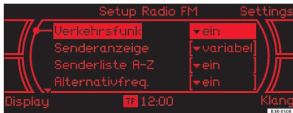
Abb. 43 Setup-Hauptmenü des Radios
