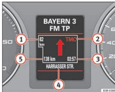
Abb. 94 Display des Kombiinstrument: Beispiel-Darstellung einer Zielführung
