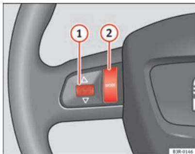
Abb. 91 Multifunktionslenkrad: Linke Menüwalze und MODE-Taste
