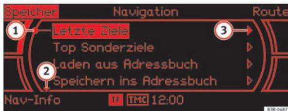
Abb. 20 Detailansicht des Displays: Orientierungszeichen
