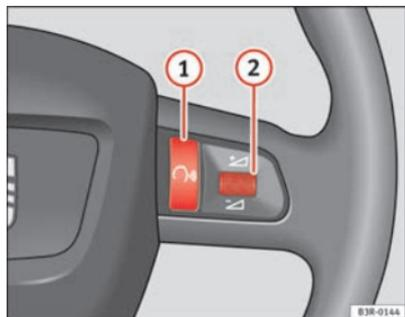
Abb. 89 Sprechaste am Multifunktionslenkrad
