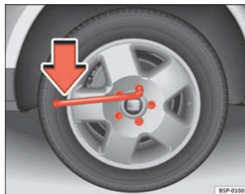
Abb. 193 Radwechsel: Radschrauben lockern
