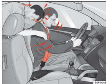
Abb. 9 Der nicht angegurte Mitfahrer auf dem Rücksitz wird nach vorne auf den angegurten Fahrer geschleudert.
