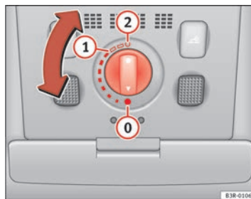
Abb. 82 Ausschnitt aus Dachhimmel: Drehschalter für Schiebe-/Ausstelldach
