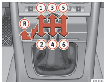
Abb. 153 Ansicht der Mittelkonsole: Schalt-schema eines 6-Gang-Schaltgetriebes
