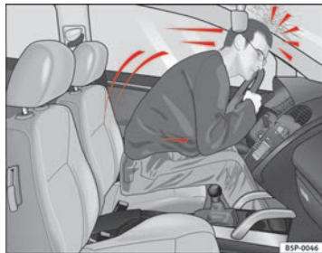
Abb. 8 Der nicht angegurte Fahrer wird nach vorne geschleudert.
