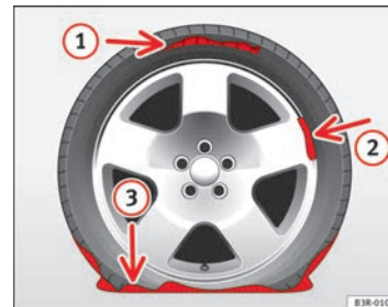
Abb. 186 Reifenschäden für die das Tire-Mobility-System nicht geeignet ist
