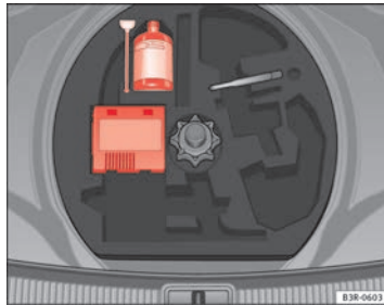
Abb. 180 Reifenreparaturset (Tire-Mobility-System) unter Ladeboden im Gepäckraum
