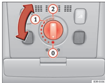
Abb. 81 Ausschnitt aus Dachhimmel: Drehschalter für das Schiebe-/Ausstelldach
