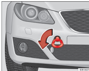
Abb. 231 Einschrauben der Abschleppöse vorne am Fahrzeug
