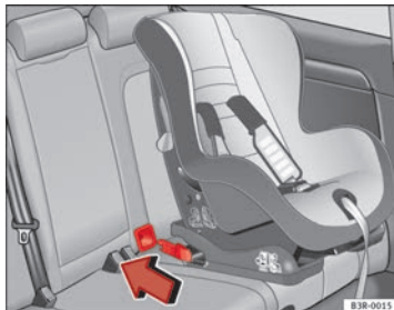
Abb. 33 Die ISOFIX-Rastarme des Kindersitzes lassen sich über die bereits angebrachten Plastikführungen einführen, bis sie in den ISOFIX-Verankerungen des Fahrzeugs einrasten.
