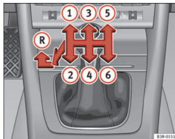
Abb. 145 Ausschnitt aus der Mittelkonsole: Schaltschema des 6-Gang-Schaltgetriebes
