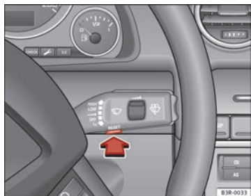
Abb. 61 Scheibenwischerhebel: Bedientaste für Menüwahl
