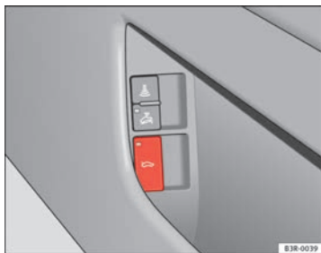
Abb. 74 Fahrertür: Gepäckraumklappe entriegeln
