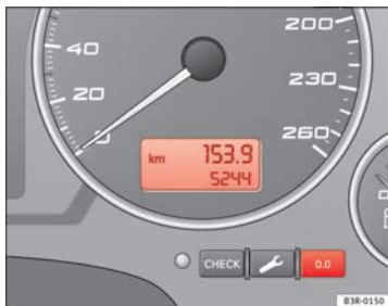
Abb. 42 Ausschnitt aus Kombiinstrument: Kilometerzähler
