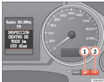
Abb. 52 Ausschnitt aus Kombiinstrument: Service-Intervall-Anzeige
