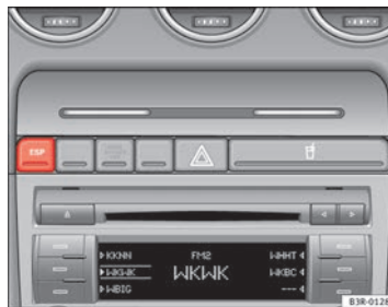
Abb. 135 Ansicht der Mittelkonsole: ESP-Taste ▶
