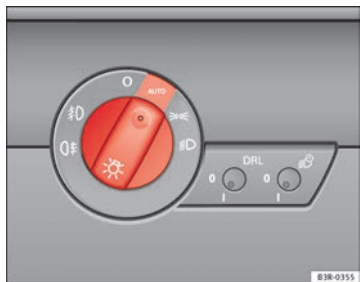
Abb. 85 Ausschnitt aus der Instrumententafel: Lichtschalter
