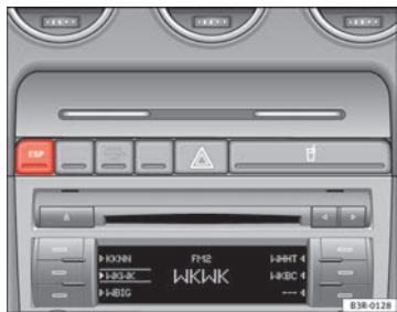
Abb. 149 Mittelkonsole mit ESP-Schalter
