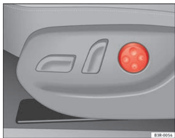
Abb. 109 Vordersitz: Schalterplatte für Lendenwirbelstütze
