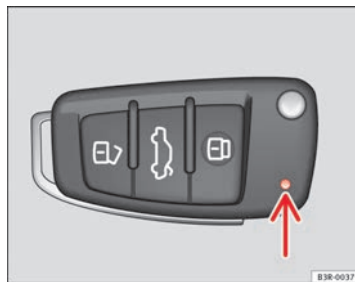
Abb. 68 Kontrollleuchte im Funkschlüssel
