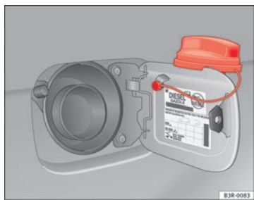
Abb. 163 Tankklappe mit aufgestecktem Tankverschluss
