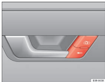
Abb. 71 Ausschnitt aus der Fahrertür: Zentralverriegelungsschalter
