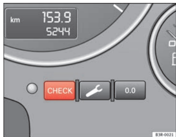
Abb. 57 Ausschnitt aus Kombiinstrument: CHECK-Taste
