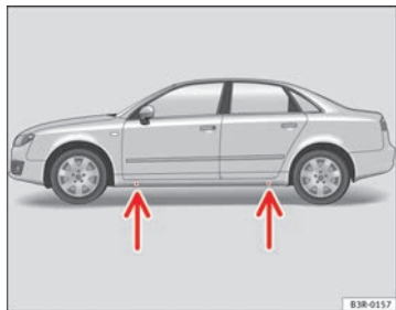
Abb. 180 Radwechsel: Aufnahmepunkte für den Wagenheber
