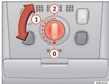
Abb. 81 Ausschnitt aus Dachhimmel: Drehschalter für Schiebe-/Ausstelldach
