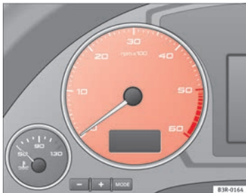
Abb. 39 Ausschnitt aus Kombiinstrument. Drehzahlmesser
