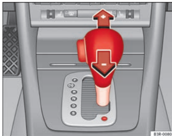
Abb. 146 Mittelkonsole: Manuelles Schalten (tiptronic-Betrieb)
