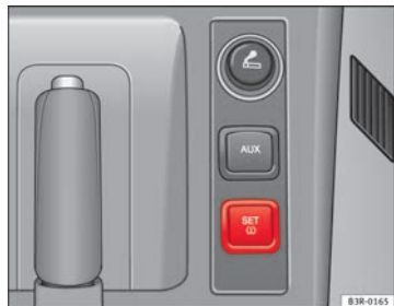
Abb. 173 Ansicht der Mittelkonsole: Taste für die Reifenkontrollanzeige
