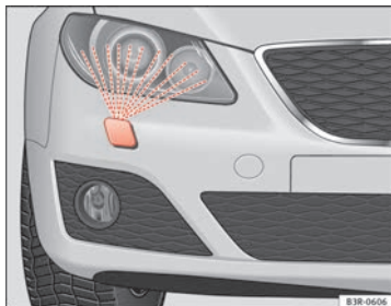
Abb. 102 Scheinwerfer mit ausgefahrener Waschdüse
