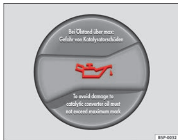
Abb. 167 Deckel der Motoröl-Einfüllöffnung im Motorraum
