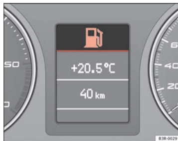
Abb. 55 Display: Kraftstoffvorrat niedrig
