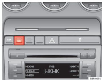
Abb. 100 Taste für elektrisches Heckrollo
