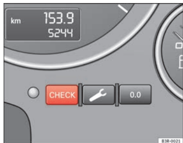
Abb. 43 Ausschnitt aus Kombiinstrument: CHECK-Taste
