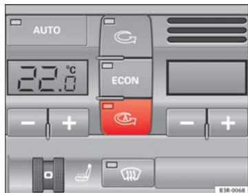
Abb. 131 Bedientaste für den automatischen Umluftbetrieb
