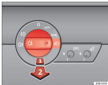
Abb. 84 Ausschnitt aus der Instrumententafel: Lichtschalter
