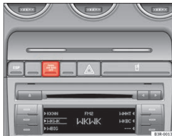
Abb. 28 Kontrollleuchte für Abschaltung der Beifahrerairbags
