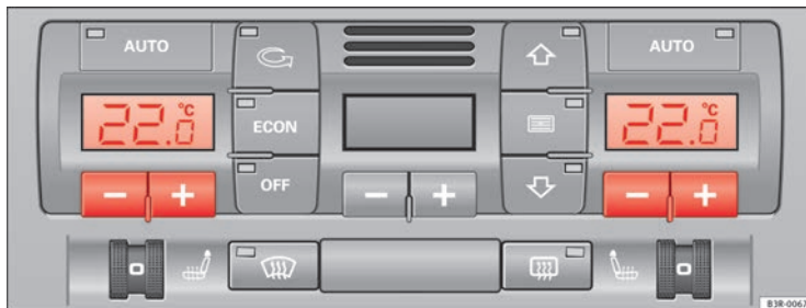
Abb. 130 Bedienelemente der Klimaanlage
