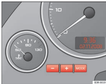
Abb. 40 Ausschnitt aus Kombiinstrument: Digitaluhr
