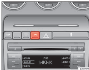
Abb. 139 Mittelkonsole: Schalter für Einparkhilfe
