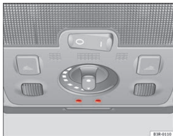
Abb. 94 Ausschnitt aus Dachhimmel: Ambientebeleuchtung
