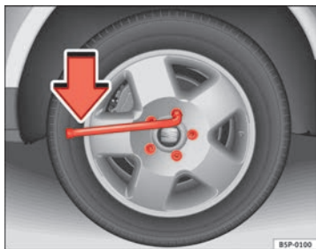
Abb. 179 Radwechsel: Radschrauben lockern
