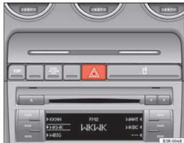
Abb. 91 Mittelkonsole: Schalter für Warnblinkanlage
