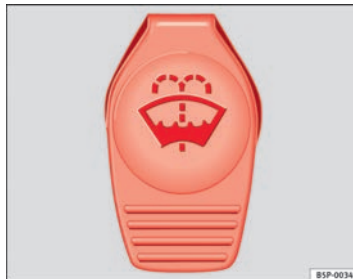
Abb. 169 Im Motorraum: Deckel des Scheibenwaschwasserbehälters ▶
