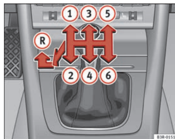
Abb. 142 Ansicht der Mittelkonsole: Schalt-schema eines 6-Gang-Schaltgetriebes
