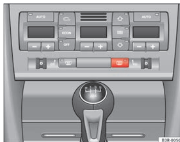
Abb. 97 Schalter für Heckscheibenbeheizung
