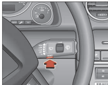
Abb. 61 Scheibenwischerhebel: Bedientaste für Menüwahl
