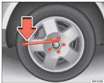
Abb. 183 Radwechsel: Radschrauben lockern
