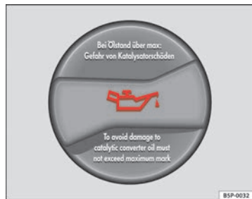
Abb. 171 Deckel der Motoröl-Einfüllöffnung im Motorraum
