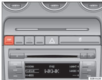
Abb. 151 Mittelkonsole mit ESP-Schalter
