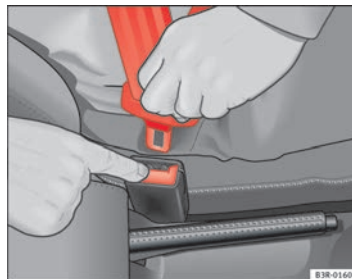
Abb. 15 Lösen der Schlosszunge vom Gurtverschluss
