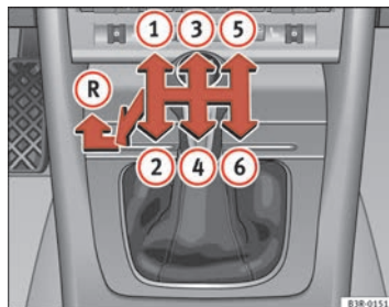
Abb. 144 In der Mittelkonsole: Schaltschema eines 6-Gang-Schaltgetriebes
