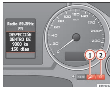
Abb. 52 Ausschnitt aus Kombiinstrument: Service-Intervall-Anzeige
