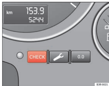
Abb. 43 Ausschnitt aus Kombiinstrument: CHECK-Taste
