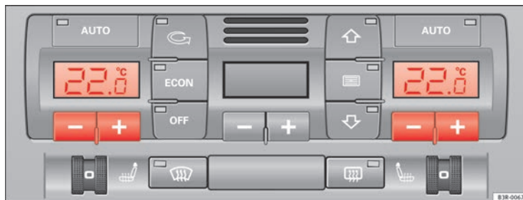
Abb. 132 Bedienelemente der Klimaanlage
