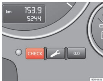
Abb. 57 Ausschnitt aus Kombiinstrument: CHECK-Taste
