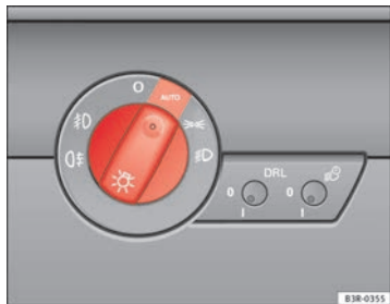
Abb. 85 Ausschnitt aus der Instrumententafel: Lichtschalter
