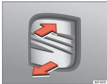
Abb. 75 Gepäckraum: Öffnen von außen
