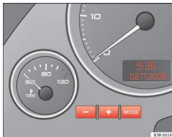
Abb. 40 Ausschnitt aus Kombiinstrument: Digitaluhr
