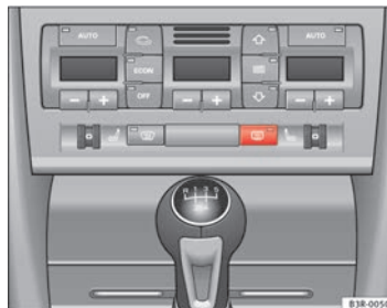
Abb. 97 Schalter für Heckscheibenbeheizung
