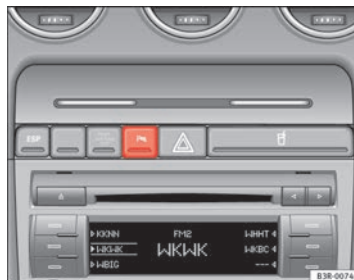
Abb. 141 Mittelkonsole: Taste für Einparkhilfe ▶
