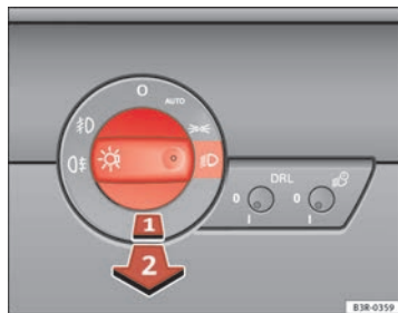
Abb. 84 Ausschnitt aus der Instrumententafel: Lichtschalter
