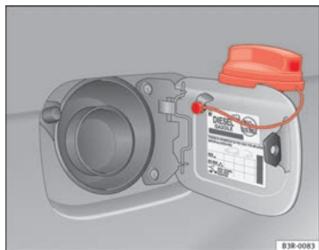
Abb. 165 Tankklappe mit aufgestecktem Tankverschluss
