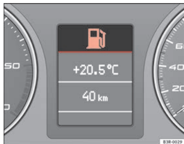
Abb. 55 Display: Kraftstoffvorrat niedrig
