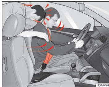
Abb. 9 Der nicht angegurte Mitfahrer auf dem Rücksitz schleudert nach vorne auf den angegurten Fahrer.
