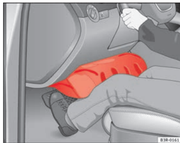
Abb. 22 Die aufgeblasenen Airbags schützen bei einem Frontaufprall
