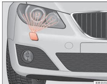
Abb. 102 Scheinwerfer mit ausfahrender Waschdüse
