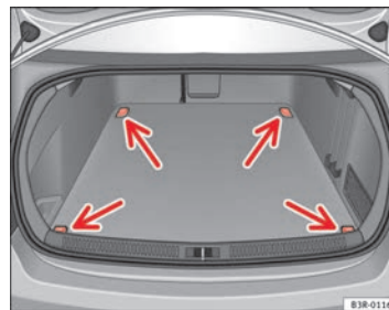
Abb. 116 Anordnung der Verzurrösen im Gepäckraum
