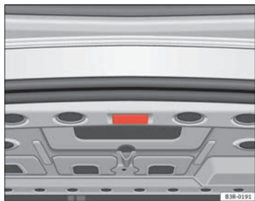
Abb. 96 Ausschnitt aus Gepäckraumoberseite: Gepäckraumbeleuchtung
