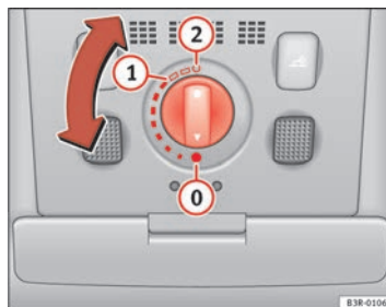
Abb. 81 Ausschnitt aus Dachhimmel: Drehschalter für Schiebe-/Ausstelldach
