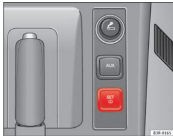
Abb. 177 In der Mittelkonsole: Taste für die Reifenkontrollanzeige
