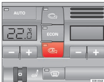
Abb. 133 Bedientaste für den automatischen Umluftbetrieb
