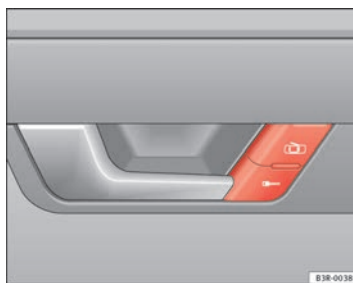
Abb. 71 Ausschnitt aus der Fahrertür: Zentralverriegelungsschalter
