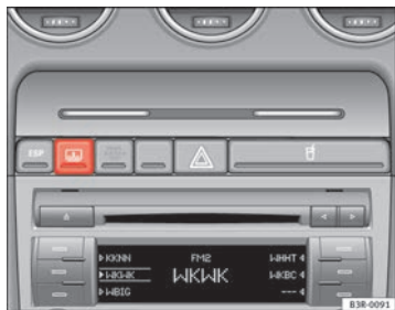
Abb. 100 Taste für elektrisches Heckrollo
