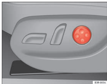
Abb. 109 Vordersitz: Schalterplatte für Lenden- wirbelstütze
