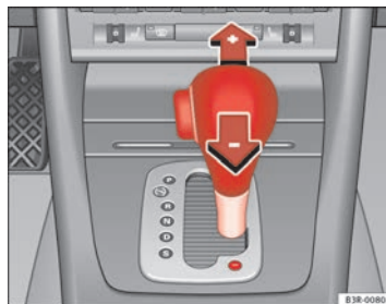
Abb. 148 Mittelkonsole: Manuelles Schalten (tiptronic-Betrieb)
