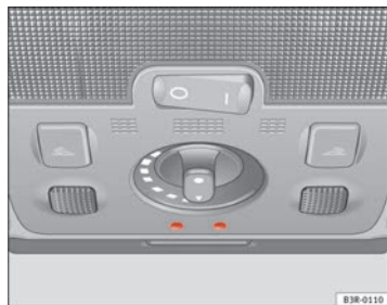
Abb. 94 Ausschnitt aus Dachhimmel: Ambientebeleuchtung
