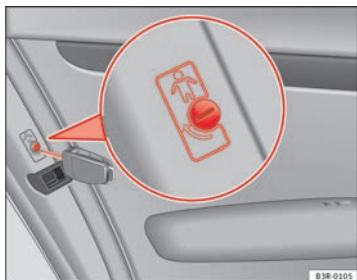
Abb. 76 Kindersicherung der hinteren Türen
