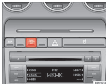
Abb. 28 Kontrollleuchte für Abschaltung der Beifahrerairbags
