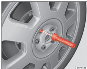
Abb. 186 Radwechsel: Innensechskant zum Drehen der Schrauben
