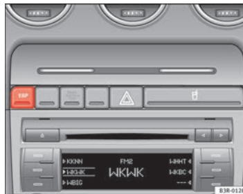
Abb. 137 In der Mittelkonsole: ESP-Taste
