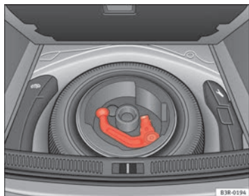
Abb. 153 Gepäckraum: Reserverad mit Anhängervorrichtung
