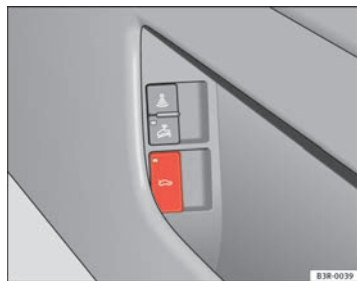
Abb. 74 Fahrertür: Gepäckraumklappe entriegeln
