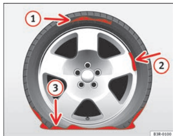
Abb. 188 Reifenschäden für die das Tire-Mobility-System nicht geeignet ist
