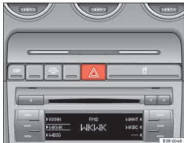
Abb. 91 Mittelkonsole: Schalter für Warnblinkanlage
