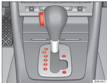
Abb. 145 Ansicht der Mittelkonsole: Wählhebel mit Sperrtaste
