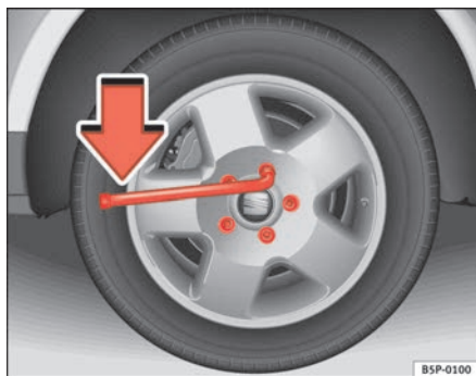
Abb. 178 Radwechsel: Radschrauben lockern
