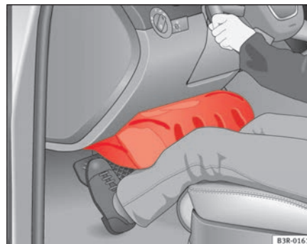
Abb. 22 Die aufgeblasenen Airbags schützen bei einem Frontaufprall
