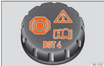
Abb. 204 Motorraum: Deckel des Bremsflüssigkeitsbehälters
