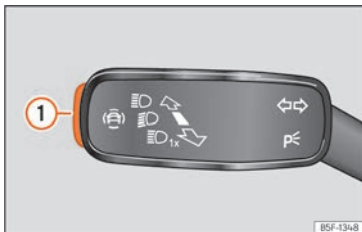
Abb. 105 Am Blinker- und Fernlichthebel: Taste für die Fahrerassistenzsysteme (modellabhängig).
