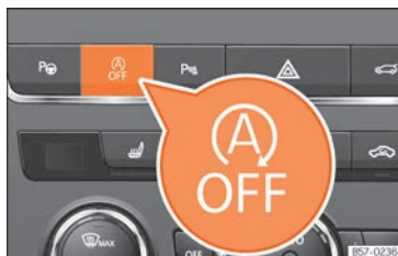
Abb. 98 Mittelkonsole: Systemtaste Start-Stopp.
