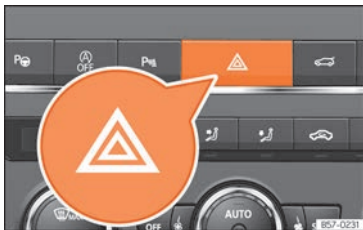
Abb. 44 Instrumententafel: Schalter für die Warnblinkanlage
