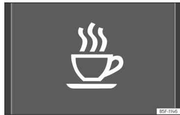
Abb. 9 Im Display des Kombi-Instruments: Symbol der Müdigkeitserkennung.
