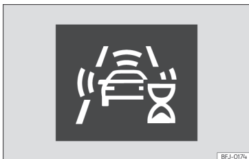
Abb. 121 Im Display des Kombi-Instruments: Anzeige der ersten Selbstkalibrierung des Systems.
