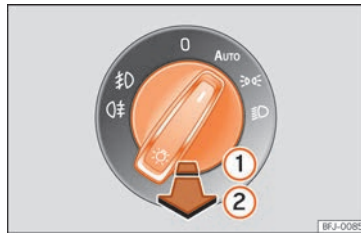
Abb. 83 Instrumententafel: Bedienelement Licht
