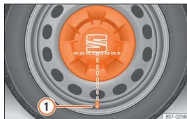
Abb. 216 Korrekte Anbringung der Radvollblende für Stahlfelgen.
