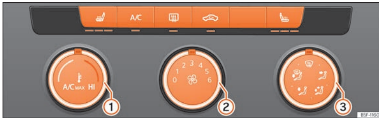
Abb. 92 In der Mittelkonsole: Bedienelemente der manuellen Klimaanlage.
