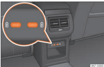
Abb. 156 Mittelkonsole hinten: USB-Anschlüsse mit Steckdosenfunktion.
