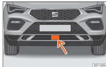
Abb. 107 Im vorderen Stoßfänger: Radarsensor.
