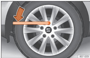
Abb. 219 Radwechsel: Radschrauben lockern
