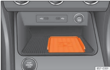
Abb. 163 In der Mittelkonsole: Aufnahme für die Mobiltelefonkopplung.
