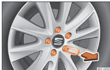
Abb. 217 Rad: Radschrauben mit Deckel.
