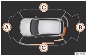
Abb. 132 Anzeige der Einparkhilfe auf dem Bildschirm des Infotainment-Systems.
