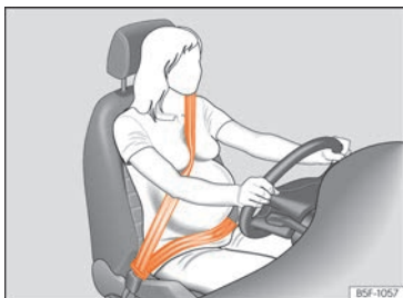
Abb. 26 Gurtbandverlauf bei schwangeren Frauen.
