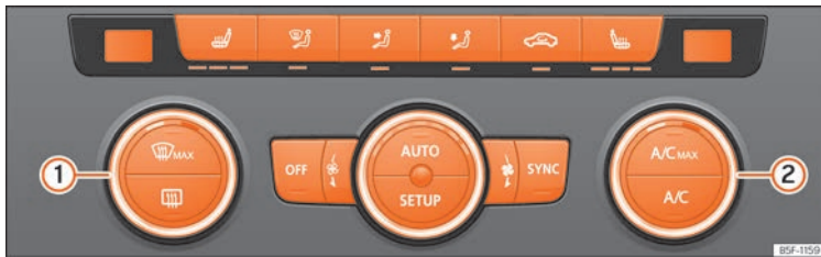
Abb. 91 In der Mittelkonsole: Bedienelemente der Climatronic.
