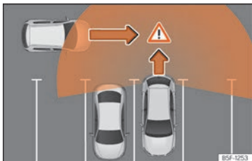
Abb. 149 Schematische Abbildung des Ausparkassistenten: Überwachter Bereich des ausparkenden Fahrzeugs.
