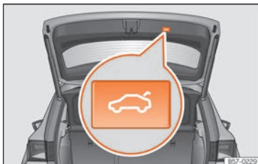
Abb. 60 Heckklappe: Taste zum Schließen der Heckklappe.
