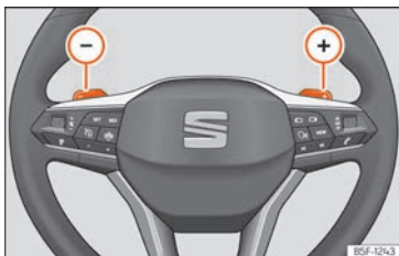
Abb. 102 Lenkrad: die Hebel für Automatikgetriebe.
