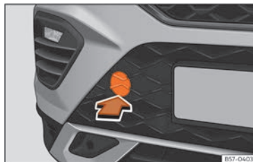
Abb. 192 Auf der rechten Seite des vorderen Stoßfängers: Abdeckung entfernen.
