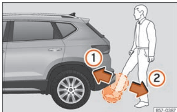
Abb. 62 Heckklappe mit sensorgesteuerter Öffnung (Easy Open).
