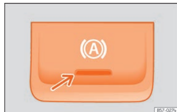
Abb. 131 Im unteren Bereich der Mittelkonsole: Funktionstaste Auto Hold.
