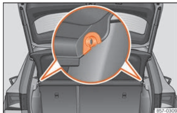
Abb. 165 Im Gepäckraum: Gepäckraumabdeckung aus- und einbauen.
