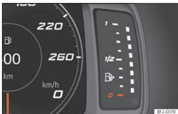
Abb. 6 Kombi-Instrument SEAT Digital Cockpit: Kraftstoffvorratsanzeige.
