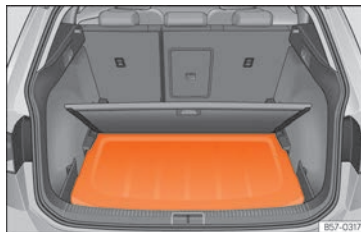
Abb. 167 Im Gepäckraum: Einsetzen der Gepäckraumabdeckung.
