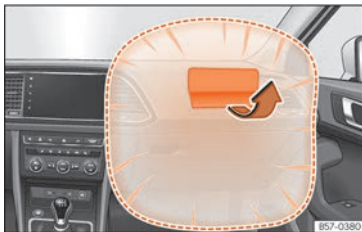
Abb. 28 Beifahrerairbag in der Instrumententafel
