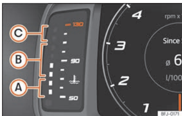
Abb. 8 Digitales Kombi-Instrument SEAT Digital Cockpit: Motorkühlmitteltemperatur-Anzeige.
