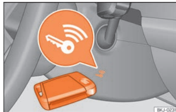
Abb. 97 Rechts an der Lenksäule: Notstart.
