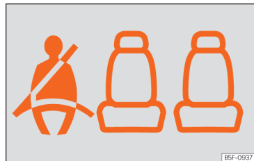
Abb. 20 Kombi-Instrument: Gurtstatusanzeige für die hinteren Sitzplätze.
