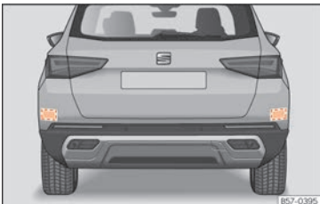
Abb. 110 Bereich hinter dem Fahrzeug: Bereiche der Radarsensoren.
