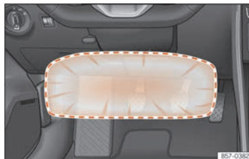
Abb. 35 Auf der Fahrerseite: Wirkungsbereich des Knieairbags.
