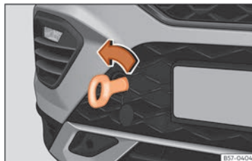
Abb. 193 Vorderer Stoßfänger rechts: Eingeschraubte Abschleppöse
