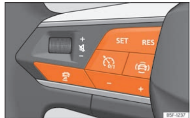
Abb. 116 Am Multifunktionslenkrad: Tasten zur ACC-Bedienung.
