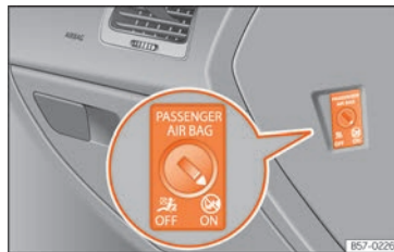
Abb. 29 Schlüsselschalter zum Ein- und Abschalten des Beifahrerairbags.
