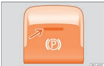
Abb. 130 Im unteren Bereich der Mittelkonsole: Taste fr die elektronische Parkbremse.
