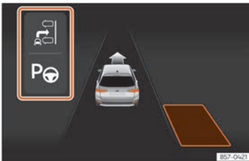
Abb. 138 Am Bildschirm des Kombi-Instruments: Anzeige des Parklenkassistenten mit eingeschränkter Sicht.
