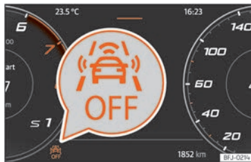
Abb. 122 Auf dem Display des Kombi-Instruments: Anzeige, dass Front Assist ausgeschaltet ist.
