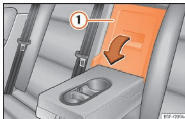
Abb. 175 An der Rücksitzlehne: Öffnung der Durchladeeinrichtung.
