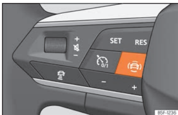
Abb. 106 Linke Seite des Multifunktionslenkrads: Taste für die Fahrerassistenzsysteme (modellabhängig).
