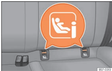
Abb. 39 Rücksitz: Einbauort der Halteösen ISOFIX oder i-Size.
