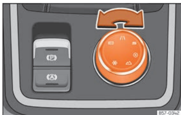
Abb. 104 Mittelkonsole: Drehknopf [Driving Experience button].
