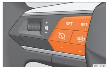
Abb. 113 Am Multifunktionslenkrad: Tasten zur Bedienung der Geschwindigkeitsregelanlage.
