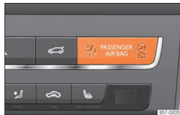
Abb. 30 Instrumententafel: Kontrollleuchte für abgeschalteten Beifahrerairbag.
