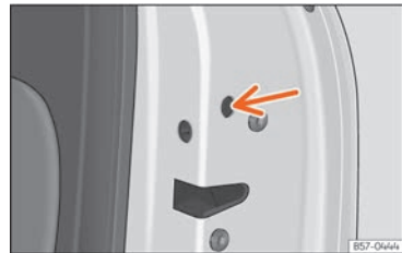
Abb. 57 Notfallsperre der Tür.
