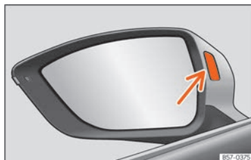
Abb. 126 Kontrollleuchte des Spurwechselassistenten.
