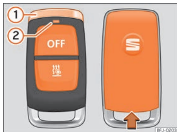
Abb. 95 Standheizung: mit Funkfernbedienung
