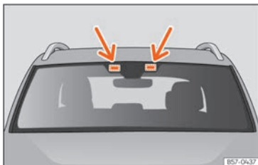
Abb. 94 Bereiche für das Anbringen elektronischen Zubehörs
