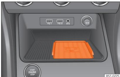
**Abb. 78** In der Mittelkonsole: Aufnahme für die Mobiltelefonkopplung.
