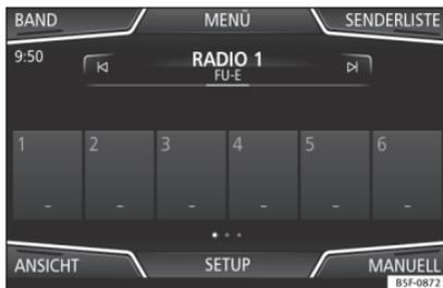
**Abb. 28** Anzeige der Speichertasten im DAB-Modus.
