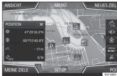
Abb. 54 Anzeigen und Funktionstasten auf der Kartendarstellung
