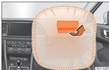
Abb. 15 Beifahrerairbag in der Instrumententafel
