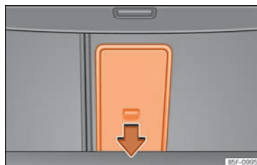
Abb. 127 Im Gepäckraum: Öffnung der Durchladeeinrichtung.
