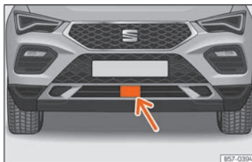
Abb. 158 Am vorderen Stoßfänger: Radarsensor.
