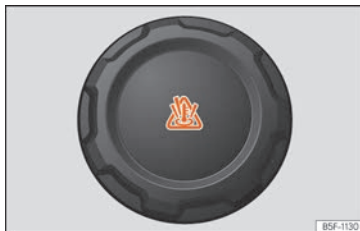
Abb. 216 Motorraum: Deckel des Motorkühlmittelausgleichsbehälters.
