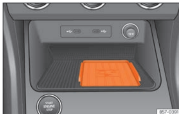
Abb. 146 In der Mittelkonsole: Aufnahme für die Mobiltelefonkopplung.
