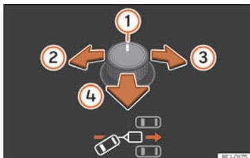
Abb. 196 Drehknopf für die Außenspiegel: Ausrichtung des Anhängers einstellen.
