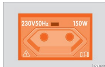
Abb. 134 Im Gepäckraum links: 230-Volt-Steckdose.
