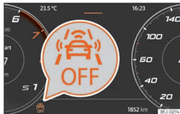
Abb. 167 Am Bildschirm des Kombi-Instrumenten: Anzeige, dass Front Assist ausgeschaltet ist.
