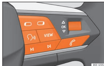
Abb. 63 Rechte Seite des Multifunktionslenkrads: Bedienelemente für die Menüs und Informationsanzeigen im Kombi-Instrument.
