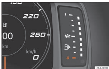
Abb. 60 Frei konfigurierbares Kombiinstrument: Kraftstoffvorratsanzeige
