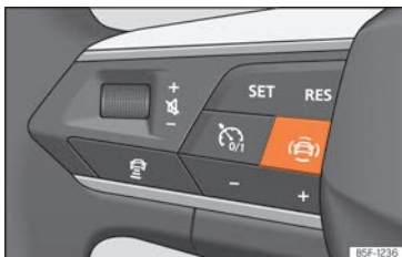
Abb. 66 Linke Seite des Multifunktionslenkrads: Taste für die Fahrerassistenzsysteme (modellabhängig).
