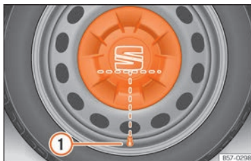
Abb. 33 Korrekte Anbringung der Radvollblende für Stahlfelgen.
