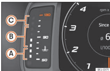
Abb. 62 Frei konfigurierbares Kombiinstrument: Motor- und Kühlmittel-Temperaturanzeige.
