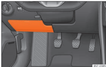
Abb. 49 Linkslenker: Abdeckung des Sicherungskasten unter der Instrumententafel auf der Fahrerseite
