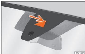
Abb. 160 An der Windschutzscheibe: Kamera-sichtfenster des Spurhalteassistenten.
