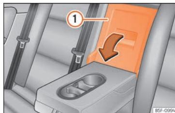
Abb. 126 An der Rücksitzlehne: Öffnung der Durchladeeinrichtung.
