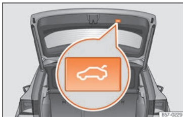
Abb. 87 Heckklappe: Taste zum Schließen der Heckklappe.
