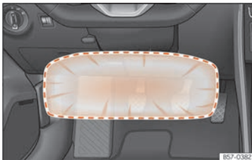
Abb. 19 Auf der Fahrerseite: Wirkungsbereich des Knieairbags.
