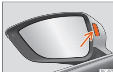
Abb. 178 Kontrollleuchte des Spurwechselassistenten.
