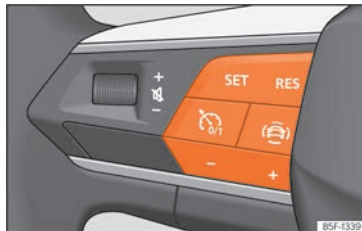
Abb. 164 Am Multifunktionslenkrad: Tasten zum Bedienen der Geschwindigkeitsregelanlage
