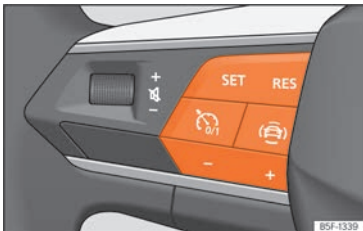
Abb. 165 Am Multifunktionslenkrad: Tasten zum Bedienen des Geschwindigkeitsbegrenzers
