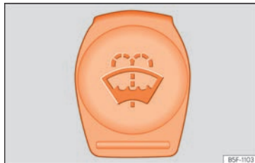
Abb. 218 Im Motorraum: blauer Deckel des Scheibenwaschwasserbehälters.
