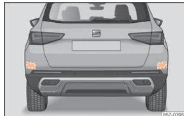
Abb. 161 Heckansicht des Fahrzeugs: Bereiche der Radarsensoren.
