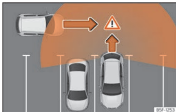
Abb. 182 Schematische Abbildung des Ausparkassistenten: Überwacher Bereich des ausparkenden Fahrzeugs.
