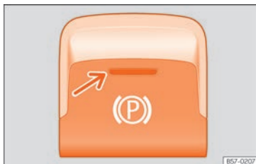
Abb. 183 Im unteren Teil der Mittelkonsole: Taste für elektronische Parkbremse.
