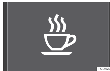
Abb. 56 Am Bildschirm des Kombi-Instruments: Symbol für Müdigkeitserkennung.
