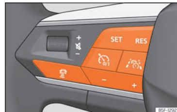
Abb. 177 Linke Seite des Multifunktionslenkrads: Tasten zur Bedienung von Travel Assist.
