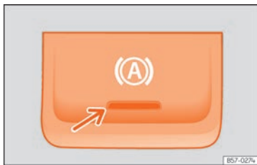
Abb. 184 Im unteren Teil der Mittelkonsole: Taste für die Auto Hold-Funktion.
