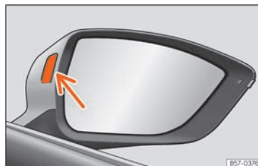
Abb. 179 Kontrollleuchte des Spurwechselassistenten.
