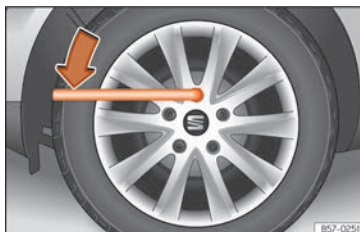
Abb. 36 Radwechsel: Radschrauben lockern.
