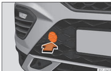
Abb. 45 Auf der rechten Seite des vorderen Stoßfängers: Abdeckung entfernen.
