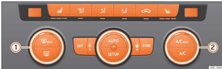
Abb. 135 In der Mittelkonsole: Bedienelemente der Climatronic.
