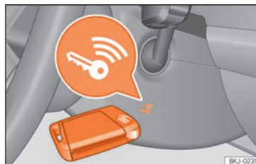
Abb. 150 Rechts an der Lenksäule: Notstart.
