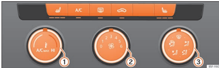
Abb. 136 In der Mittelkonsole: Bedienungselemente für die Klimaanlage.
