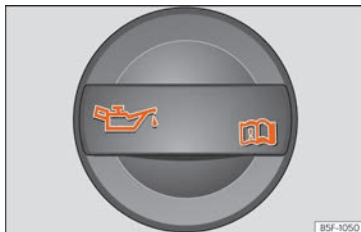
Abb. 214 Deckel der Motoröl-Einfüllöffnung im Motorraum
