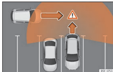
Abb. 129 Schematische Abbildung des Ausparkassistenten: Überwachter Bereich des ausparkenden Fahrzeugs.
