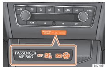
Abb. 31 Instrumententafel-Mittelteil: Kontrollleuchte für abgeschalteten Beifahrer-Frontairbag.
