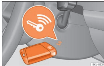
Abb. 84 Rechts an der Lenksäule: Notstart.
