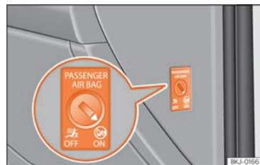
Abb. 30 Schlüsselschalter zum Ein- und Abschalten des Beifahrerairbags.
