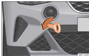
Abb. 164 Vorderer Stoßfänger rechts: Eingeschraubte Abschleppöse
