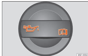
Abb. 186 Deckel der Motoröl-Einfüllöffnung im Motorraum.
