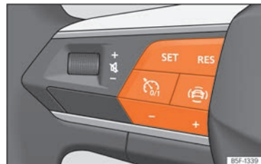
Abb. 100 Am Multifunktionslenkrad: Tasten zur Bedienung der Geschwindigkeitsregelanlage.
