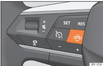
Abb. 93 Linke Seite des Multifunktionslenkrads: Taste für die Fahrerassistenzsysteme (modellabhängig).
