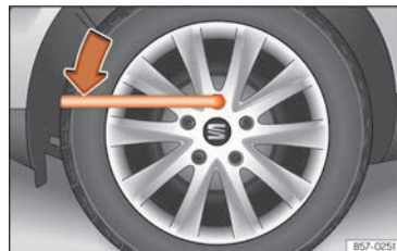
Abb. 195 Radwechsel: Radschrauben lockern
