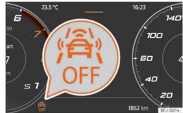
Abb. 109 Auf dem Display des Kombi-Instruments: Anzeige, dass Front Assist ausgeschaltet ist.
