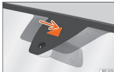
Abb. 96 Kamerasichtfenster des Spurhalteassistenten.
