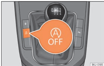
Abb. 85 Mittelkonsole: Systemtaste Start-Stopp.
