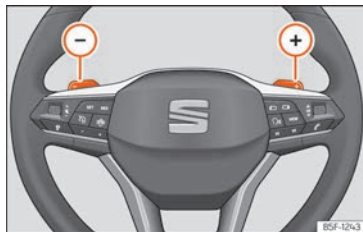
Abb. 89 Lenkrad: die Hebel für Automatikgetriebe.
