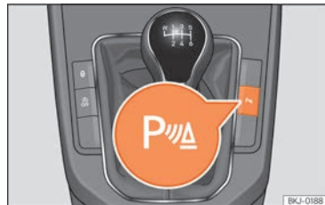
Abb. 119 Mittelkonsole: Taste für Einparkhilfe (je nach Ausführung).
