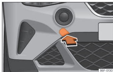
Abb. 163 Auf der rechten Seite des vorderen Stoßfängers: Abdeckung entfernen.
