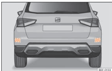
Abb. 97 Bereich hinter dem Fahrzeug: Bereiche der Radarsensoren.
