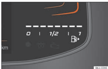
Abb. 5 Kombi-Instrument Basic: Kraftstoffvorratsanzeige.
