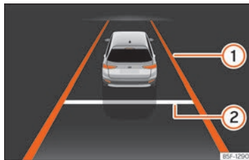
Abb. 111 Am Bildschirm des Kombi-Instruments: Anzeige bei aktiver Regelung (schematische Darstellung).
