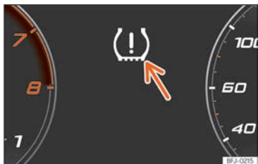
Abb. 199 Kombi-Instrument: Warnung Reifendruckverlust.
