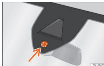
Abb. 77 Sensitive Fläche des Regensensors.
