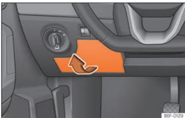
Abb. 167 Auf der Fahrerseite in der Instrumententafel: Abdeckung des Sicherungskastens.
