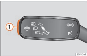
Abb. 92 Am Blinker- und Fernlichthebel: Taste für die Fahrerassistenzsysteme (modellabhängig).
