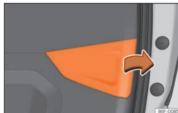
Abb. 172 Geöffnete Heckklappe: Abdeckung entfernen.
