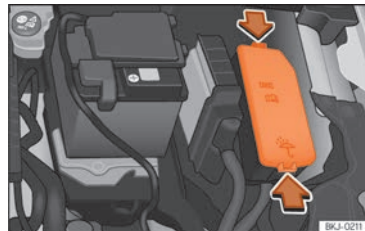
Abb. 168 Im Motorraum: Abdeckung des Sicherungskastens.
