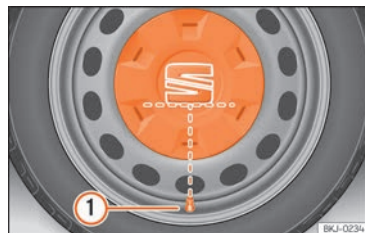
Abb. 192 Korrekte Anbringung der Radvollblende für Stahlfelgen.
