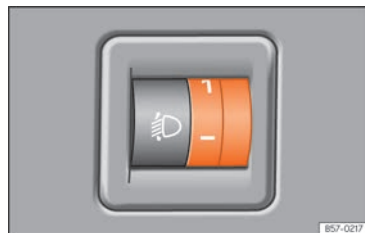
Abb. 73 Neben dem Lenkrad: Regler für die Leuchtweitenregulierung.
