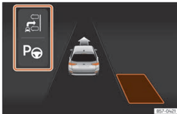
Abb. 123 Am Bildschirm des Kombi-Instruments: Anzeige des Parklenkassistenten mit eingeschränkter Sicht.
