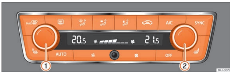
Abb. 80 In der Mittelkonsole: Bedienelemente der Climatronic.
