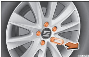
Abb. 193 Rad: Radschrauben mit Deckel.
