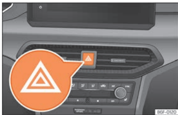
Abb. 44 Instrumententafel: Schalter für die Warnblinkanlage
