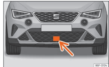
Abb. 94 Im vorderen Stoßfänger: Radarsensor.
