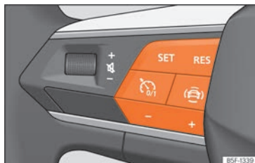
Abb. 101 Am Multifunktionslenkrad: Tasten zur Bedienung des Geschwindigkeitsbegrenzers.
