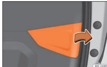
Abb. 59 Offene Heckklappe: Abdeckung entfernen.
