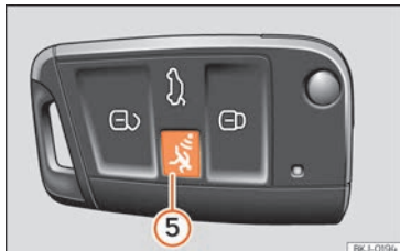
Abb. 83 Fahrzeugschlüssel mit Alarmtaste.
