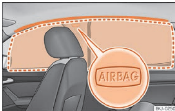
Abb. 20 Einbauort und Entfaltungsbereich des Kopfairbags.
