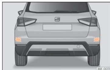
Abb. 147 Heckansicht des Fahrzeugs: Bereiche der Radarsensoren.
