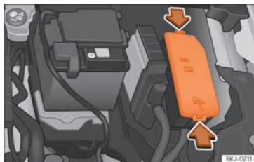
Abb. 49 Im Motorraum: Abdeckung des Sicherungskastens.
