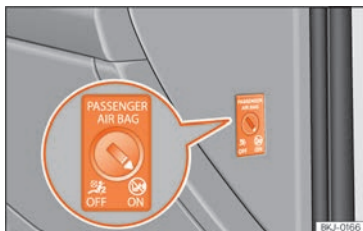
Abb. 16 Schlüsselschalter zum Ein- und Abschalten des Beifahrerairbags.
