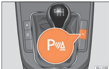
Abb. 176 Mittelkonsole: Taste für Einparkhilfe (je nach Ausführung).
