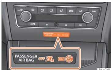
Abb. 17 In der Mitte der Instrumententafel: Kontrollleuchte für Abschaltung der Beifahrerairbags.
