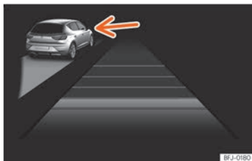
Abb. 161 Am Bildschirm des Kombi-Instruments: ACC aktiv, Fahrzeug auf der linken Seite erkannt
