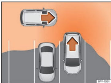
Abb. 167 Schematische Abbildung des Ausparkassistenten: Überwachter Bereich des ausparkenden Fahrzeugs.
