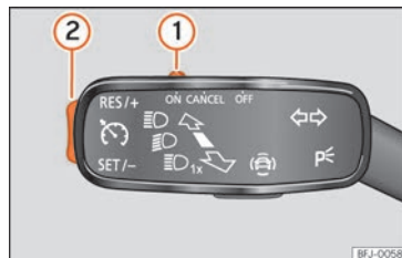
Abb. 151 Am Blinkerhebel: Bedienelemente zur Bedienung der GRA.
