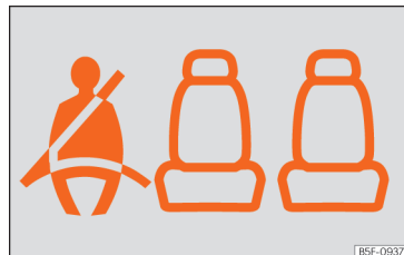
Abb. 6 Kombi-Instrument: Anzeige, dass der Platz hinten links besetzt ist und der Mitfahrer seinen Sicherheitsgurt angelegt hat.
