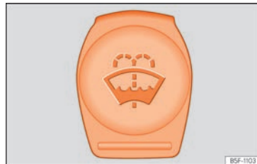
Abb. 204 Im Motorraum: Deckel des Scheibenwaschbehälters.
