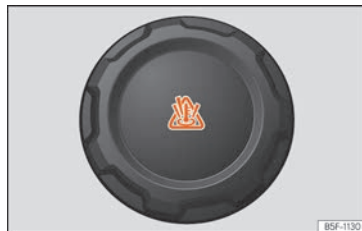
Abb. 202 Motorraum: Deckel des Motorkühlmittelausgleichsbehälters.
