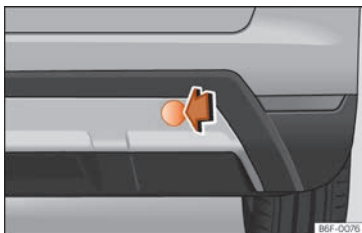
Abb. 46 Auf der rechten Seite des hinteren Stoßfängers: Abdeckung entfernen.
