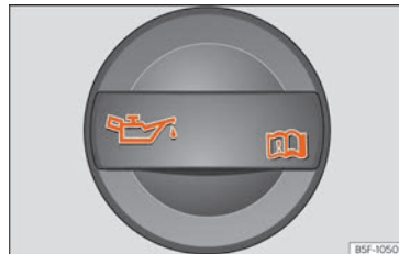
Abb. 200 Deckel der Motoröl-Einfüllöffnung im Motorraum
