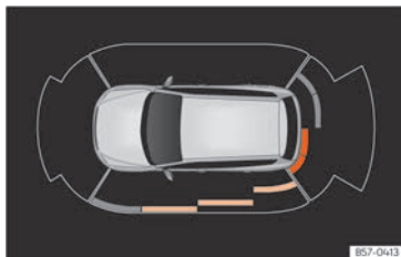
Abb. 177 Anzeige der Einparkhilfe auf dem Bildschirm des Infotainment-Systems.
