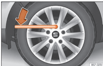
Abb. 35 Radwechsel: Radschrauben lockern.
