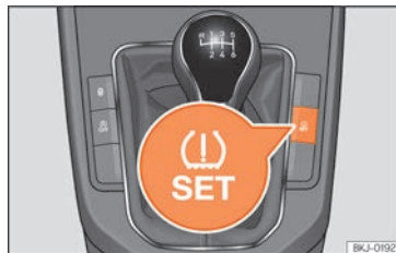
Abb. 209 Mittelkonsole: Taste für die Reifendruckkontrollanzeige.
