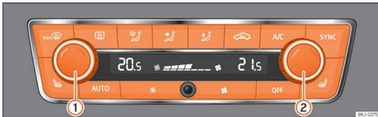
Abb. 126 In der Mittelkonsole: Bedienungselemente der Climatronic.
