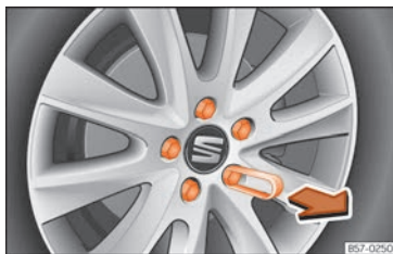
Abb. 33 Rad: Radschrauben mit Deckel.
