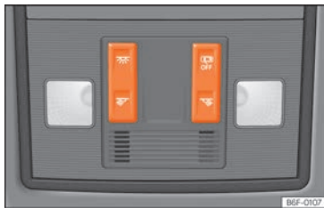
Abb. 102 Ausschnitt aus Dachhimmel:: Innenraumbeleuchtung vorn.
