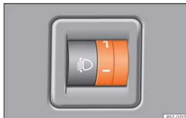
Abb. 101 Neben dem Lenkrad: Regler für die Leuchtweitenregulierung.
