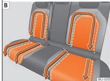
Abb. 113 Abnehmbare Schonbezüge ausbauen. [A] Sitz vorn links; [B] Sitze hinten
