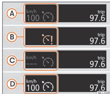
Abb. 150 Bildschirm des Kombi-Instruments: Zustandsanzeigen der GRA.
