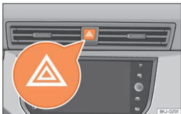
Abb. 100 Instrumententafel: Schalter für Warnblinkanlage.
