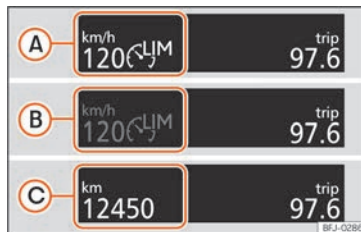
Abb. 153 Am Bildschirm des Kombi-Instruments: Statusanzeigen des Geschwindigkeitsbegrenzers.
