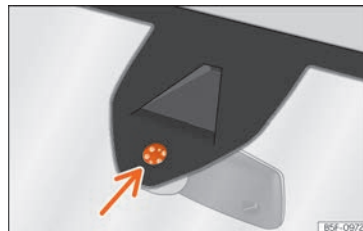
Abb. 105 Sensitive Fläche des Regensensors.
