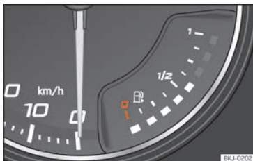
Abb. 69 Analoges Kombi-Instrument: Kraftstoffvorratsanzeige
