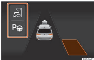
Abb. 170 Am Bildschirm des Kombi-Instruments: Anzeige des Parklenkassistenten mit eingeschränkter Sicht.
