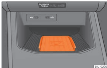
Abb. 133 In der Mittelkonsole: Aufnahme für die Mobiltelefonkopplung.
