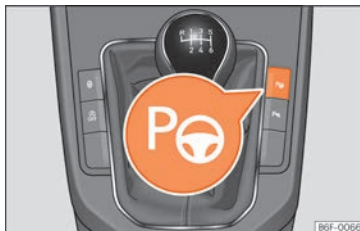
Abb. 169 In der Mittelkonsole: Taste zum Einschalten des Parklenkassistenten.
