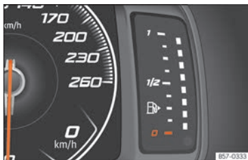
Abb. 70 Frei konfigurierbares Kombiinstrument: Kraftstoffvorratsanzeige
