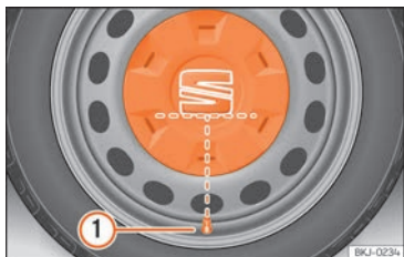
Abb. 32 Korrekte Anbringung der Radvollblende für Stahlfelgen.
