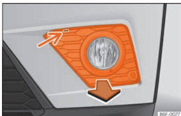
Abb. 55 Nebelscheinwerfer: Gitter herausziehen
