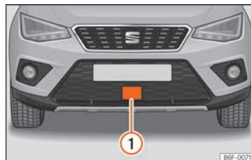
Abb. 145 Am vorderen Stoßfänger: Radarsensor.
