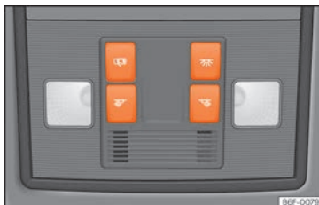
Abb. 44 Ausschnitt aus Dachhimmel: Innenbeleuchtung vorn.
