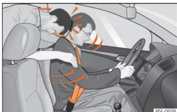
Abb. 91 Der nicht angegurte Mitfahrer auf dem Rücksitz schleudert nach vorn auf den angegurten Fahrer.
