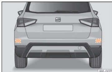
Abb. 243 Bereich hinter dem Fahrzeug: Bereiche der Radarsensoren.
