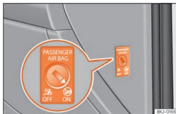
Abb. 24 Schalter für Beifahrer-Frontairbag.
