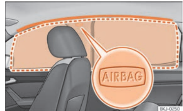
Abb. 28 Einbaort und Entfaltungsbereich des Kopfairbags.
