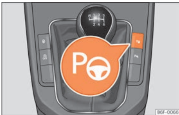
Abb. 248 In der Mittelkonsole: Taste zum Einschalten des Parklenkassistenten.
