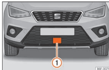
Abb. 231 Im vorderen Stoßfänger: Radarsensor.
