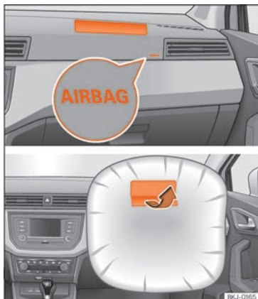
Abb. 23 Beifahrerairbag in der Instrumententafel
