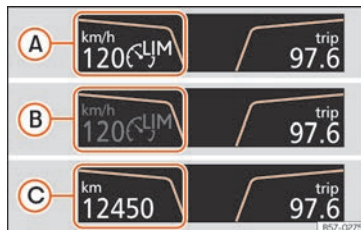
Abb. 227 Am Bildschirm des Kombi-Instruments: Anzeige des Zustands des Geschwindigkeitsbegrenzers.
