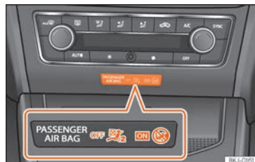
Abb. 25 Instrumententafel-Mittelteil: Kontrollleuchte für abgeschalteten Beifahrer-Frontairbag.
