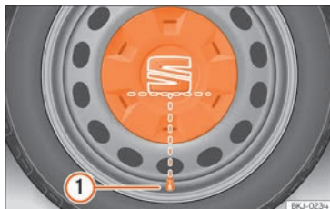
Abb. 70 Korrekte Anbringung der Radvollblende für Stahlfelgen.
