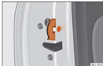
Abb. 140 Kindersicherung in der linken Tür
