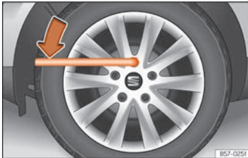
Abb. 72 Radwechsel: Radschrauben lockern
