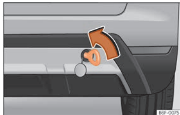
Abb. 77 Hinterer Stoßfänger, rechte Seite: Abschleppöse.
