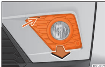
Abb. 105 Nebelscheinwerfer: Gitter abnehmen
