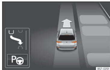
Abb. 250 Am Bildschirm des Kombi-Instruments: Anzeige des Parklenkassistenten mit eingeschränkter Sicht.
