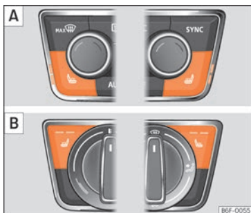
Abb. 150 In der Mittelkonsole: Regler für die Sitzheizung der Vordersitze. A : Ausführung mit Climatronic. B : Ausführung mit manueller Klimaanlage.
