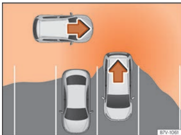
Abb. 246 Schematische Abbildung des Ausparkassistenten: Überwachter Bereich des ausparkenden Fahrzeugs.
