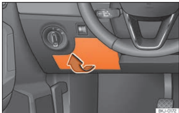
Abb. 63 Auf der Fahrerseite in der Instrumententafel: Abdeckung des Sicherungskastens.
