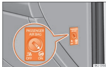
Abb. 94 Schlüsselschalter zum Ein- und Abschalten des Beifahrerairbags.
