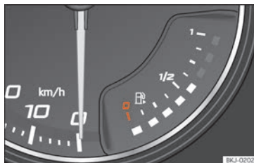
Abb. 121 Analoges Kombiinstrument: Kraftstoffvorratsanzeige
