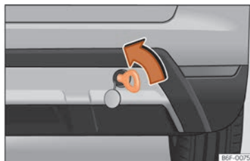
Abb. 100 Hinterer Stoßfänger rechts: Eingeschraubte Abschleppöse
