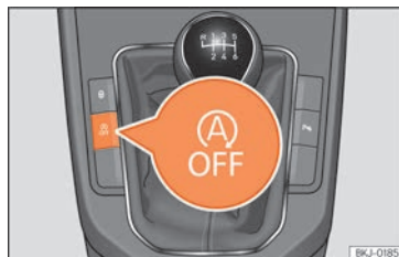
Abb. 225 Mittelkonsole: Systemtaste Start-Stopp.
