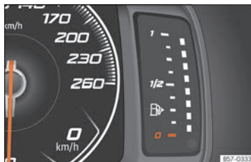
Abb. 122 Frei konfigurierbares Kombiinstrument: Kraftstoffvorratsanzeige.
