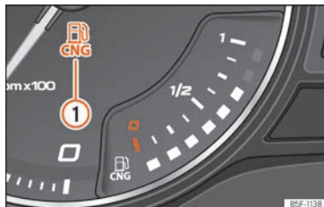
Abb. 123 Analoges Kombiinstrument: Erdgasvorratsanzeige
