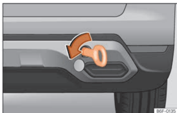
Abb. 47 Auf der rechten Seite des hinteren Stoßfängers: eingeschraubte Abschleppöse.
