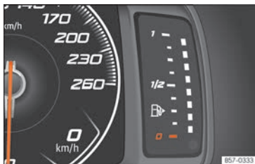
Abb. 66 Frei konfigurierbares Kombiinstrument: Kraftstoffvorratsanzeige
