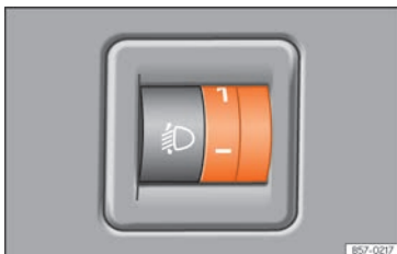
Abb. 96 Neben dem Lenkrad: Regler für die Leuchtweitenregulierung.
