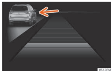
Abb. 151 Am Bildschirm des Kombi-Instruments: ACC aktiv, Fahrzeug auf der linken Seite erkannt
