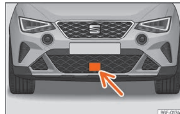
Abb. 139 Am vorderen Stoßfänger: Radarsensor.
