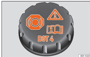
Abb. 198 Motorraum: Deckel des Bremsflüssigkeitsbehälters.
