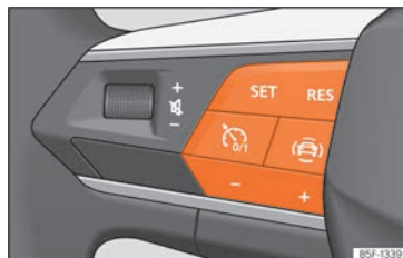
Abb. 145 Am Multifunktionslenkrad: Tasten zum Bedienen der Geschwindigkeitsregelanlage
