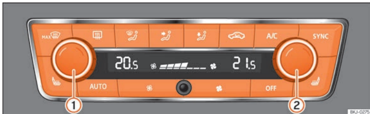
Abb. 119 In der Mittelkonsole: Bedienungselemente der Climatronic.
