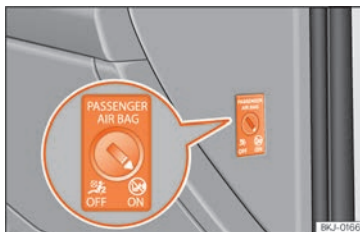
Abb. 16 Schlüsselschalter zum Ein- und Abschalten des Beifahrerairbags.
