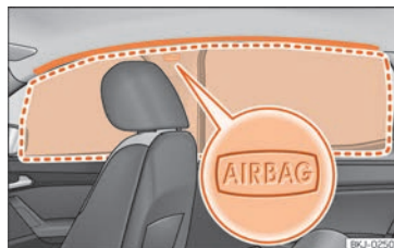
Abb. 20 Einbauart und Entfaltungsbereich des Kopfairbags.
