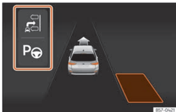
Abb. 164 Am Bildschirm des Kombi-Instruments: Anzeige des Parklenkassistenten mit eingeschränkter Sicht.
