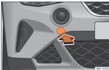
Abb. 44 Stoßfänger vorn rechts: Abdeckung entfernen.
