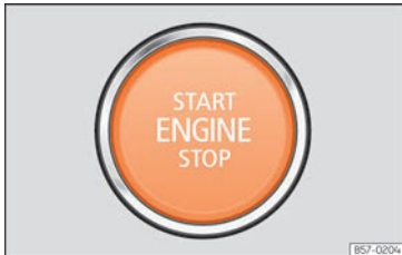
Abb. 130 Im unteren Teil der Mittelkonsole: Starterknopf.
