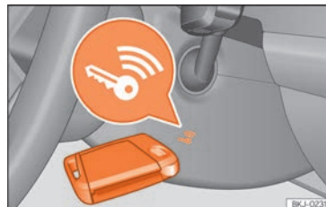
Abb. 131 Rechts an der Lenksäule: Notstart.
