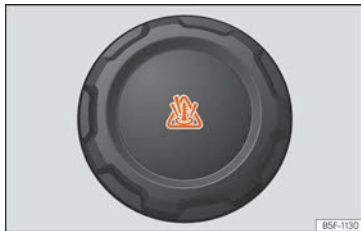
Abb. 197 Motorraum: Deckel des Motorkühlmittelausgleichsbehälters.
