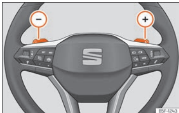
Abb. 136 Lenkrad: Hebel für Automatikgetriebe.
