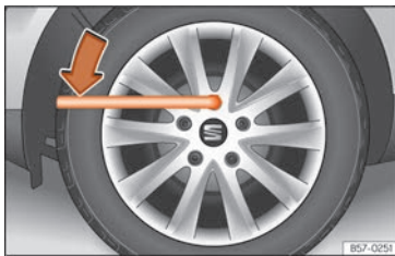
Abb. 35 Radwechsel: Radschrauben lockern.
