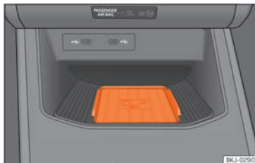
Abb. 127 In der Mittelkonsole: Aufnahme für die Mobiltelefonkopplung.
