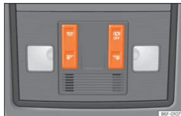
Abb. 97 Ausschnitt aus Dachhimmel:: Innenraumbeleuchtung vorn.
