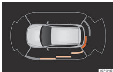
Abb. 171 Anzeige der Einparkhilfe auf dem Bildschirm des Infotainment-Systems.
