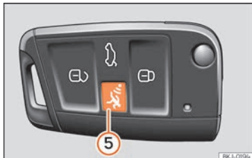
Abb. 78 Fahrzeugschlüssel mit Alarmtaste.
