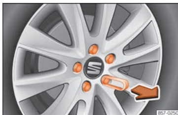
Abb. 33 Rad: Radschrauben mit Deckel.
