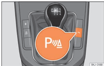
Abb. 170 Mittelkonsole: Taste für Einparkhilfe (je nach Ausführung).
