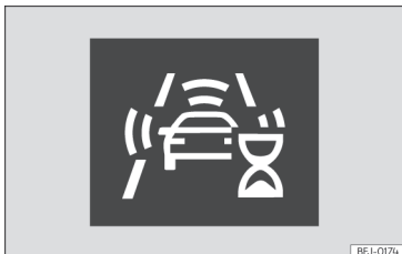
Abb. 148 Am Bildschirm des Kombi-Instruments: Anzeige der ersten Selbstkalibrierung des Systems.
