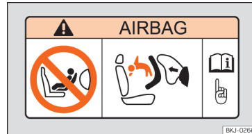
Abb. 22 Airbagaufkleber: an der Sonnenblende auf der Beifahrerseite
