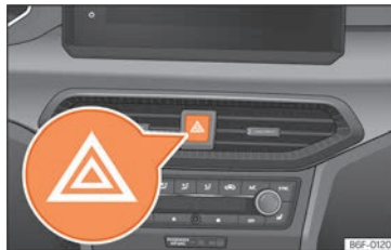
Abb. 95 Instrumententafel: Schalter für Warnblinkanlage.
