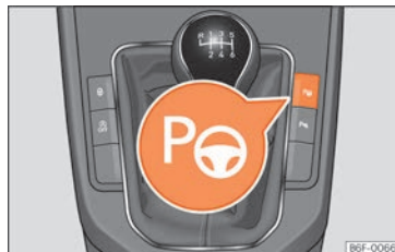
Abb. 163 In der Mittelkonsole: Taste zum Einschalten des Parklenkassistenten.
