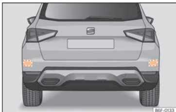
Abb. 142 Heckansicht des Fahrzeugs: Bereiche der Radarsensoren.
