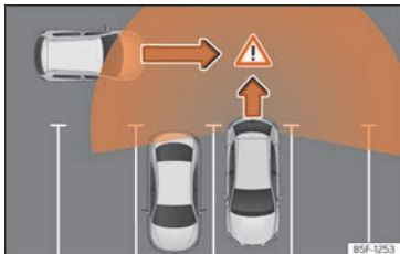
Abb. 161 Schematische Abbildung des Ausparkassistenten: Überwachter Bereich des ausparkenden Fahrzeugs.
