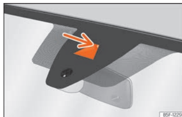
Abb. 141 An der Windschutzscheibe: Kamerasichtfenster des Spurhalteassistenten.
