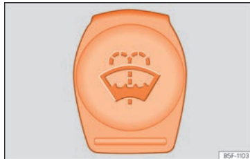
Abb. 199 Im Motorraum: blauer Deckel des Scheibenwaschwasserbehälters.
