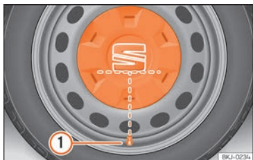
Abb. 32 Korrekte Anbringung der Radvollblende für Stahlfelgen.
