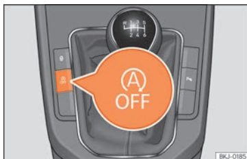
Abb. 132 Mittelkonsole: Taste des Start-Stopp-Systems.
