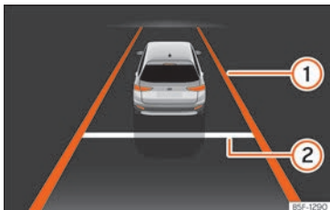
Abb. 155 Am Bildschirm des Kombi-Instruments: Anzeige bei aktiver Regelung.
