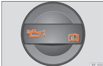
Abb. 195 Deckel der Motoröl-Einfüllöffnung im Motorraum
