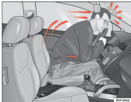
Abb. 9 Der nicht angegurte Fahrer fliegt nach vorne
