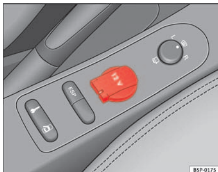
Abb. 115 Steckdose an der Mittelkonsole vorne
