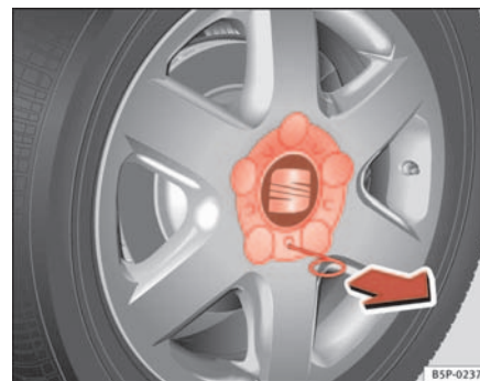
Abb. 171 Radwechsel: Radzierkappe abziehen
