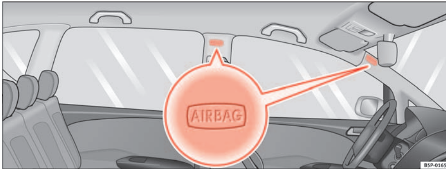
Abb. 24 Einbauort der Kopfairbags auf der linken Fahrzeugseite
