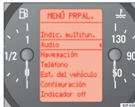
Abb. 44 Display im Kombiinstrument: Hauptmenü
