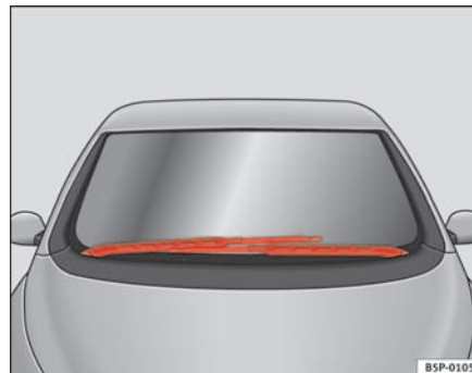
Abb. 164 Scheibenwischer in Service-Stellung
