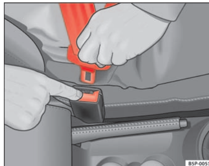
Abb. 16 Lösen der Schlosszunge vom Gurtschloss
