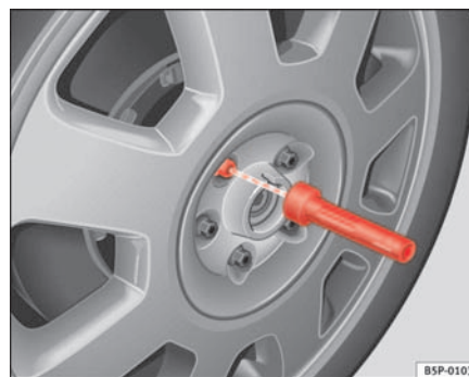
Abb. 175 Radwechsel: Innensechskant zum Drehen der Schrauben
