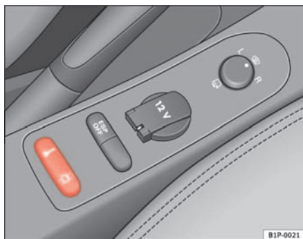
Abb. 60 Ausschnitt der Mittelkonsole: Zentralverriegelungstaster
