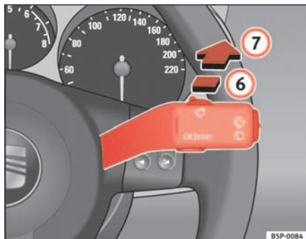
Abb. 87 Scheibenwischer- und Scheibenwascherhebel: Scheibenwischer für die Heckscheibe
