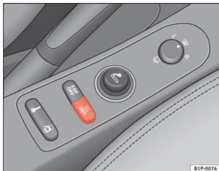
Abb. 48 Mittelkonsole: Taste für die Reifenkontrollanzeige
