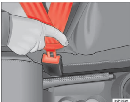
Abb. 12 Gurtschloss und Schloßzunge des Sicherheitsgurtes
