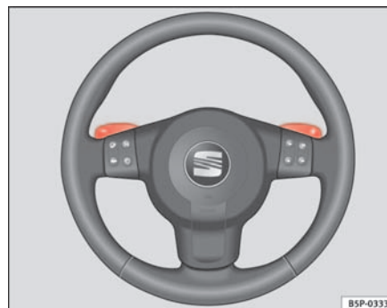
Abb. 139 Lenkrad mit Wippen für Automatikgetriebe
