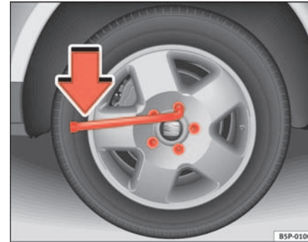
Abb. 172 Radwechsel: Radschrauben lockern
