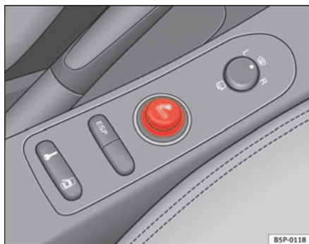
Abb. 114 Der Zigarettenanzünder befindet sich im der Steckdose der vordere Mittelkonsole
