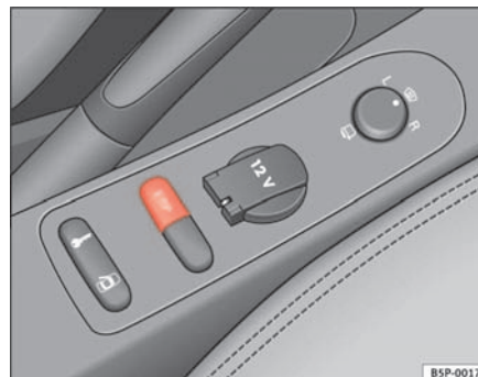
Abb. 130 Ausschnitt aus der Mittelkonsole: ESP-Taste
