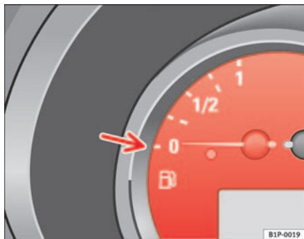
Abb. 34 Ausschnitt aus Kombiinstrument: Kraftstoffvorrats-Anzeige
