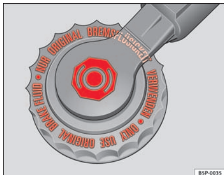
Abb. 167 Im Motorraum: Abdeckung des Bremsflüssigkeitsbehälters
