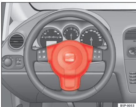
Abb. 18 Einbauort Fahrerairbag: im Lenkrad
