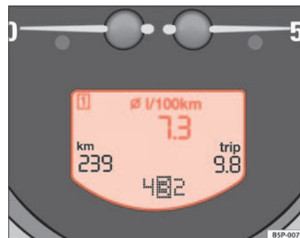
Abb. 40 Display im Kombiinstrument: Anzeige des durchschnittlichen Kraftstoffverbrauchs
