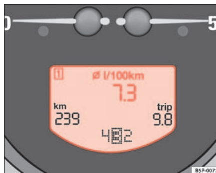
Abb. 42 Display im Kombiinstrument: Anzeige des durchschnittlichen Kraftstoffverbrauchs.
