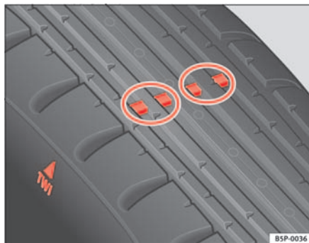
Abb. 168 Prinzipdarstellung Reifenprofil: Verschleißanzeiger
