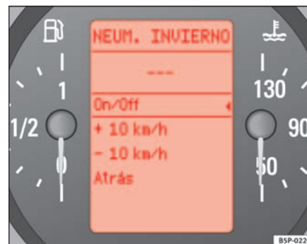
Abb. 46 Display im Kombiinstrument: Anzeige Winterreifen
