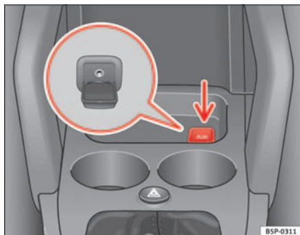
Abb. 117 Anschluss für einen zusätzlichen Audio-Eingang
