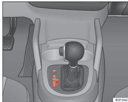
Abb. 141 Mittelkonsole: Wählhebel des Automatikgetriebes / Direktschaltgetriebes
