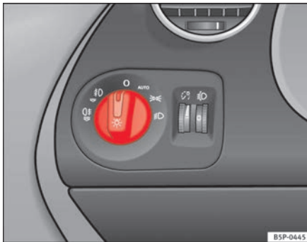
Abb. 72 Ausschnitt aus der Instrumententafel: Schalter für die Leuchten, Nebelscheinwerfer und Nebelschlussleuchte
