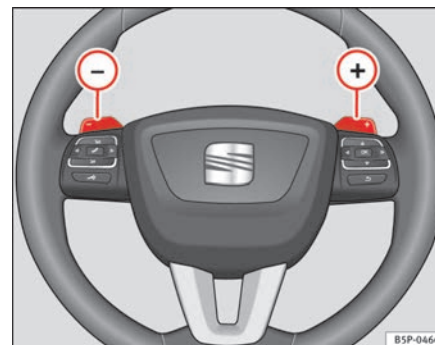
Abb. 146 Lenkrad mit Wippen für Automatikgetriebe
