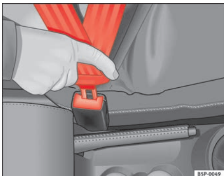
Abb. 12 Gurtschloss und Schlosszunge des Sicherheitsgurtes
