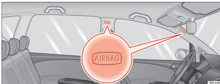
Abb. 24 Einbauort der Kopfairbags auf der linken Fahrzeugseite
