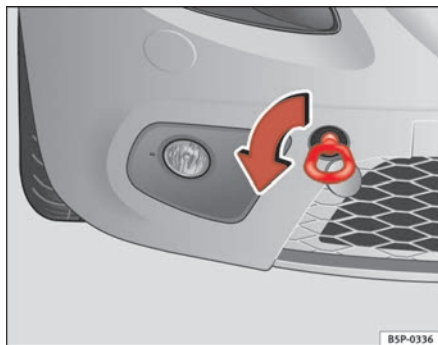
Abb. 199 Frontpartie rechts: Einschrauben der vorderen Abschleppöse
