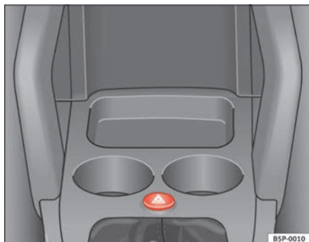
Abb. 76 In der Instrumententafel: Schalter für Warnblinkanlage
