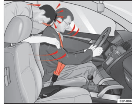
Abb. 10 Der nicht angegurte Mitfahrer auf dem Rücksitz schleudert nach vorne auf den angegurten Fahrer
