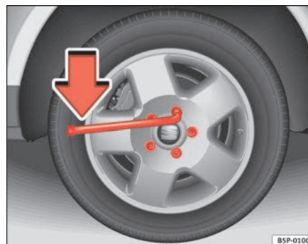
Abb. 171 Radwechsel: Radschrauben lockern
