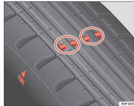
Abb. 166 Prinzipdarstellung Reifenprofil: Verschleißanzeiger
