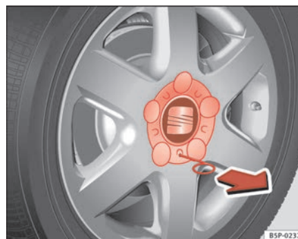
Abb. 169 Radwechsel: Radzierkappe abziehen
