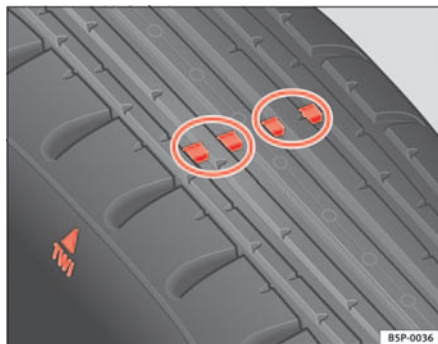
Abb. 162 Prinzipdarstellung Reifenprofil: Verschleißanzeiger
