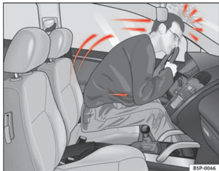
Abb. 9 Der nicht angegurte Fahrer fliegt nach vorne
