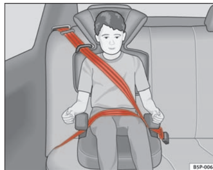
Abb. 30 In Fahrtrichtung eingebauter Kindersitz auf dem Rücksitz. ▶
