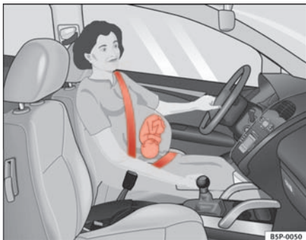
Abb. 15 Gurtbandverlauf bei schwangeren Frauen
