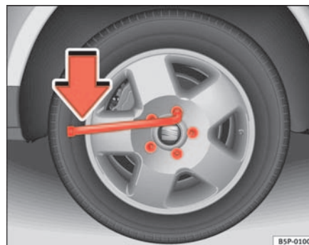
Abb. 166 Radwechsel: Radschrauben lockern
