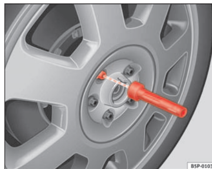
Abb. 169 Radwechsel: Innensechskant zum Drehen der Schrauben
