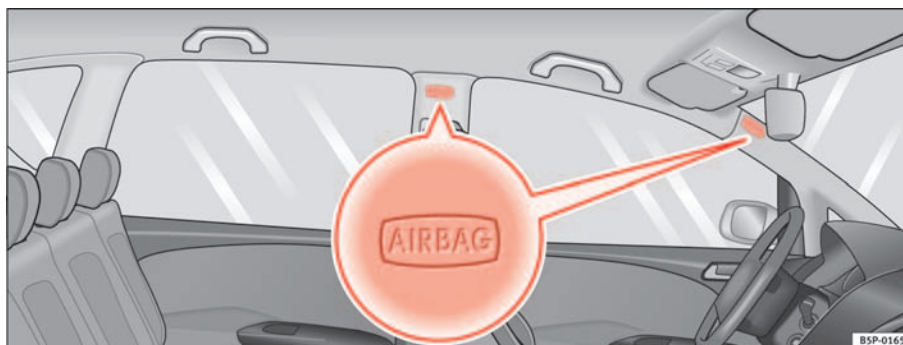
Abb. 24 Einbauort der Kopfairbags auf der linken Fahrzeugseite
