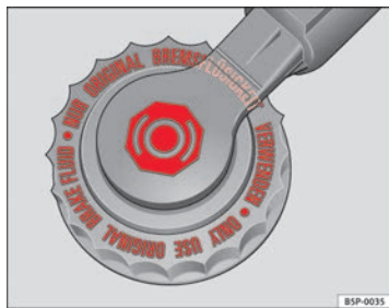
Abb. 166 Im Motorraum: Abdeckung des Bremsflüssigkeitsbehälters
