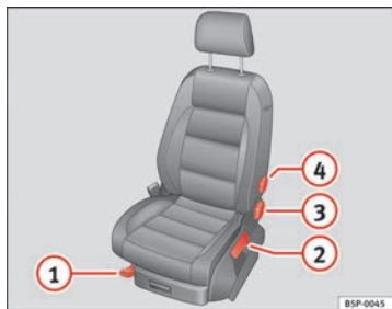
Abb. 94 Bedienelemente am linken Vordersitz
