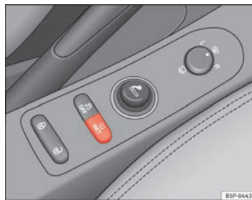
Abb. 49 Mittelkonsole: Taste für die Reifen- Kontroll-Anzeige
