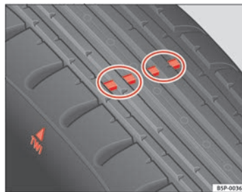
Abb. 167 Prinzipdarstellung Reifenprofil: Verschleißanzeiger
