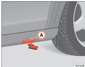
Abb. 174 Kunststoff-Trittleiste mit Deckel zur Aufnahme des Wagenhebers
