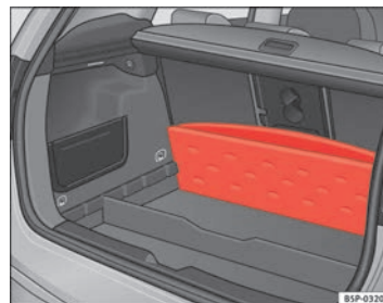
Abb. 106 Variables Ablagefach Gepäckraumboden
