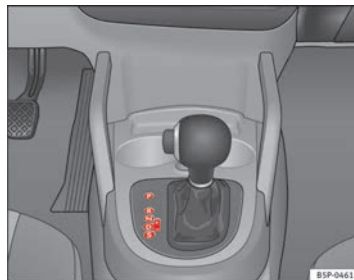
Abb. 141 Mittelkonsole: Wählhebel des Automatikgetriebes / Direktschaltgetriebes
