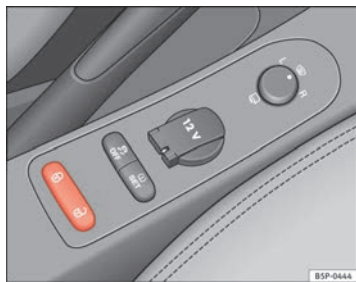
Abb. 58 In der Mittelkonsole: Zentralverriegelungstaster
