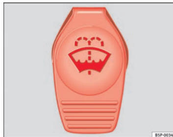
Abb. 161 Im Motorraum: Deckel des Scheibenwaschwasserbehälters
