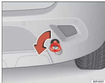
Abb. 200 Einschrauben der Abschleppöse hinten
