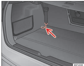
Abb. 126 Befestigungsösen zum Spannen des Gepäckraumnetzes
