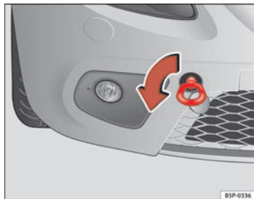
Abb. 199 Frontpartie rechts: Einschrauben der vorderen Abschleppöse
