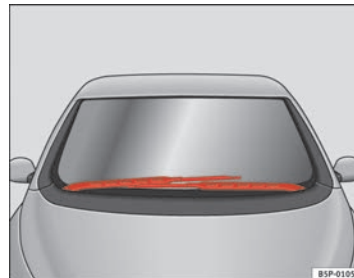
Abb. 162 Scheibenwischer in Service-Stellung
