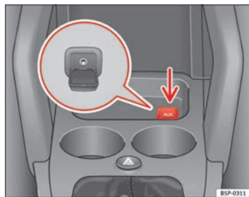
Abb. 120 Anschluss für einen zusätzlichen Audio-Eingang
