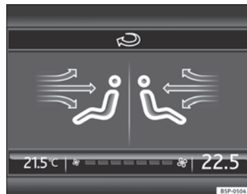
Abb. 132 Display des Navigationssystems mit Informationen der Climatronic
