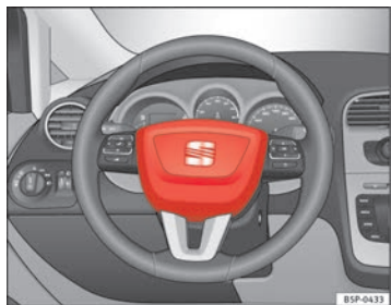
Abb. 18 Einbauort Fahrerairbag: im Lenkrad
