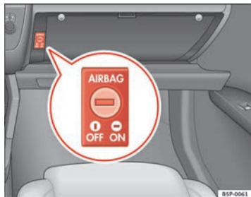
Abb. 26 Im Handschuhfach: Schlüsselschalter zum An- und Abschalten des Beifahrerairbags.
