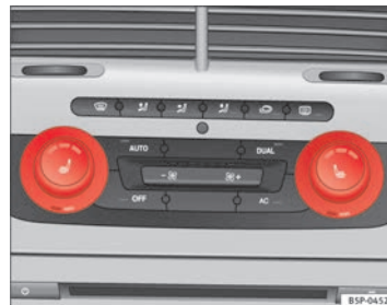
Abb. 96 Sitzheizung der Vordersitze mit Climatronic
