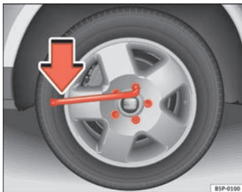
Abb. 171 Radwechsel: Radschrauben lockern
