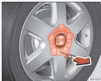
Abb. 170 Radwechsel: Radzierkappe abziehen
