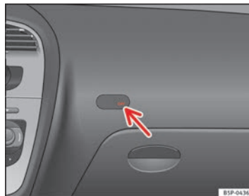
Abb. 27 Kontrollleuchte für Abschaltung der Beifahrerairbags
