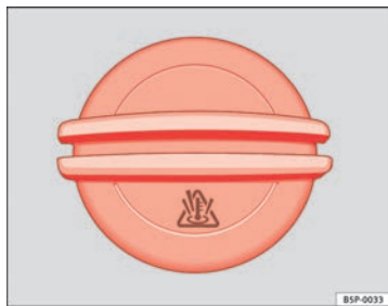
Abb. 160 Im Motorraum: Deckel des Kühlmittel- Ausgleichsbehälters
