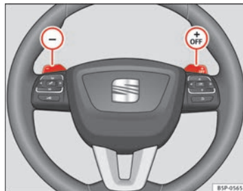
Abb. 146 Lenkrad mit Wippen für Automatikgetriebe
