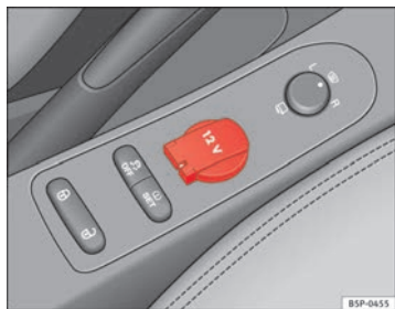
Abb. 118 Steckdose an der Mittelkonsole vorne
