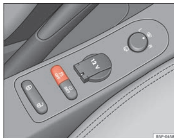
Abb. 137 In der Mittelkonsole: ESP-Taste
