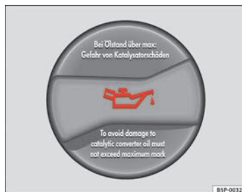
Abb. 159 Deckel der Motoröl-Einfüllöffnung im Motorraum
