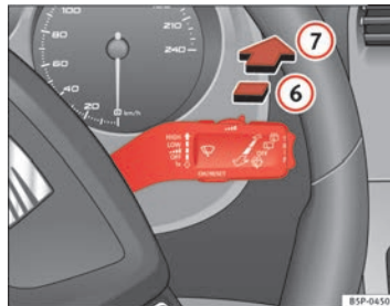
Abb. 88 Scheibenwischer- und Scheibenwaschhebel: Heckscheibenwischer
