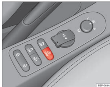
Abb. 137 Mittelkonsole: Kontrollschalter für Autogasanlage.
