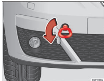
Abb. 204 Frontpartie rechts: Einschrauben der vorderen Abschleppöse
