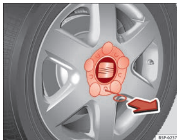
Abb. 175 Radwechsel: Radzierkappe abziehen
