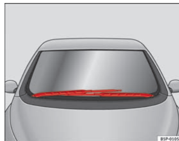
Abb. 167 Scheibenwischer in Service-Stellung
