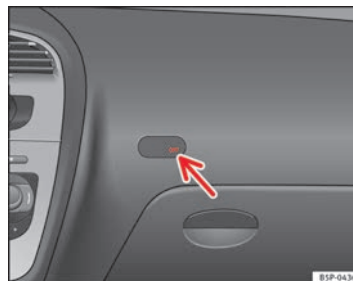
Abb. 27 Kontrollleuchte für Abschaltung der Beifahrerairbags
