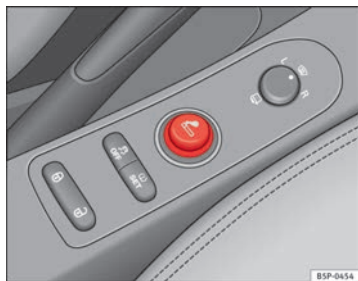
Abb. 117 Der Zigarettenanzünder befindet sich in der Steckdose der vorderen Mittelkonsole
