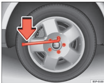
Abb. 176 Radwechsel: Radschrauben lockern
