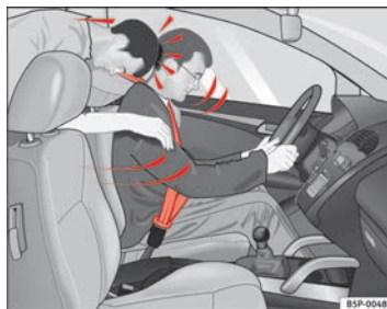
Abb. 10 Der nicht angegurte Mitfahrer auf dem Rücksitz wird nach vorne auf den angegurten Fahrer geschleudert.
