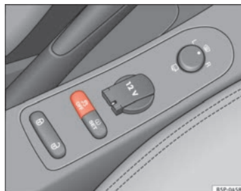
Abb. 135 Ansicht der Mittelkonsole: ESP-Taste
