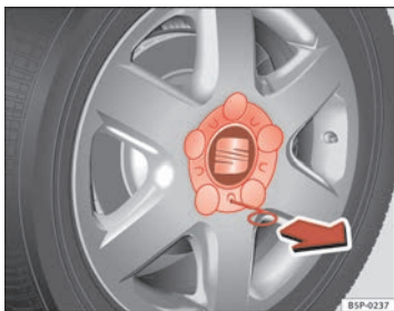
Abb. 175 Radwechsel: Radzierkappe abziehen
