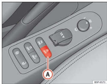
Abb. 138 Ansicht des Tasters für den Start-Stopp-Betrieb
