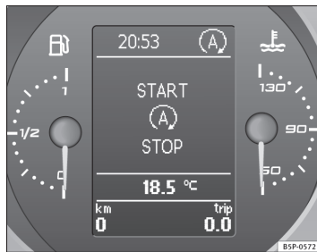
Abb. 139 Anzeige am Display des Kombiinstruments während des Start-Stopp-Betriebs
