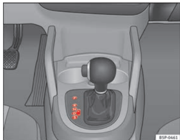
Abb. 142 Mittelkonsole: Wählhebel des Automatikgetriebes / Direktschaltgetriebes DSG
