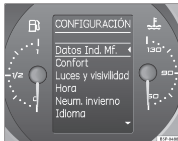
Abb. 49 Display des Kombiinstrumentes der Multifunktionsanzeige (MFA)
