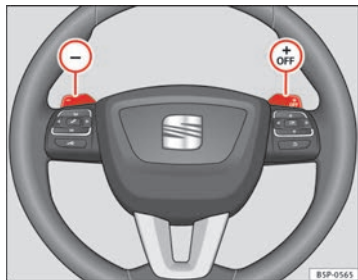
Abb. 147 Lenkrad mit Wippen für Automatikgetriebe
