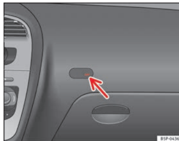
Abb. 27 Kontrollleuchte für Abschaltung der Beifahrerairbags
