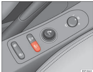
Abb. 52 Mittelkonsole: Taste für Reifenfülldruck- kontrolle
