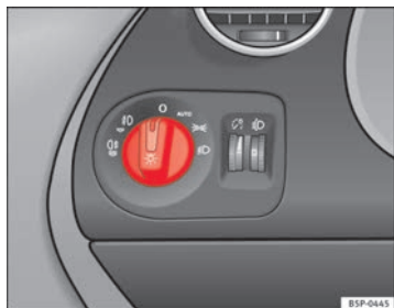
Abb. 73 Ausschnitt aus der Instrumententafel: Schalter für die Leuchten, Nebelscheinwerfer und Nebelschlussleuchte
