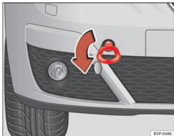
Abb.205 Frontpartie rechts: Einschrauben der vorderen Abschleppöse
