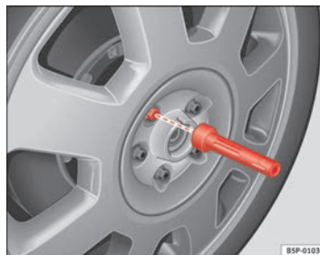
Abb. 179 Radwechsel: Innensechskant zum Drehen der Schrauben
