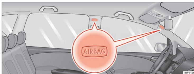
Abb. 24 Einbauort der Kopfairbags auf der linken Fahrzeugseite
