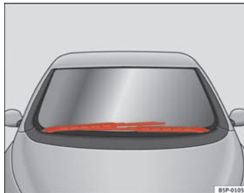
Abb. 167 Scheibenwischer in Service-Stellung
