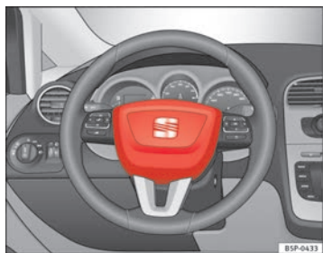
Abb. 18 Einbauort Fahrerairbag: im Lenkrad
