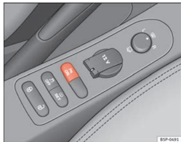
Abb. 149 Mittelkonsole: Schalter für Einparkhilfe
