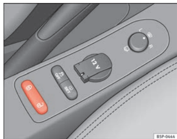
Abb. 59 Ansicht der Mittelkonsole: Taster für Zentralverriegelung
