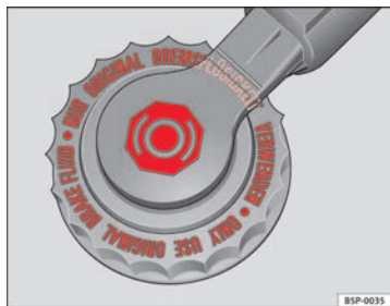
Abb. 171 Im Motorraum: Abdeckung des Bremsflüssigkeitsbehälters
