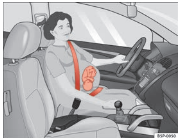
Abb. 15 Gurtbandverlauf bei schwangeren Frauen
