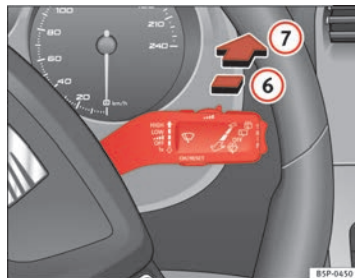
Abb. 88 Scheibenwischer- und Scheibenwaschhebel: Heckscheibenwischer
