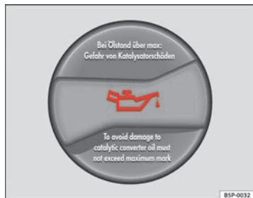
Abb. 164 Deckel der Motoröl-Einflüllöffnung im Motorraum
