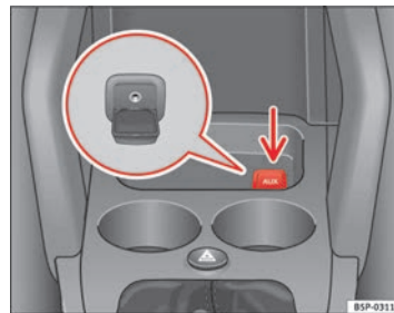
Abb. 119 Anschluss für einen zusätzlichen Audio- Eingang
