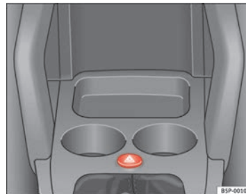
Abb. 77 In der Instrumententafel: Schalter für Warnblinkanlage
