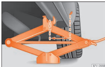
Abb. 48 Wagenheber hinten an der linken Fahrzeugseite angesetzt.
