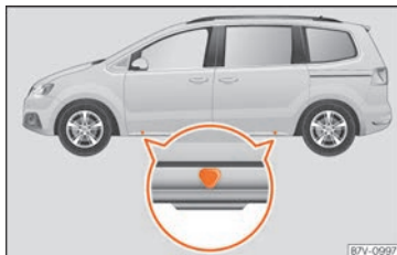
Abb. 47 Aufnahmepunkte für den Wagenheber.
