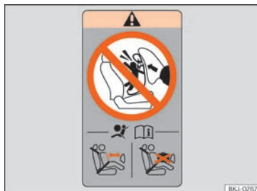
Abb. 28 Airbagaufkleber: Im hinteren Rahmen der Beifahrertür
