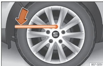
Abb. 45 Radwechsel: Radschrauben lockern.
