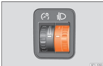
Abb. 118 Neben dem Lenkrad: Regler für die Leuchtweitenregulierung.
