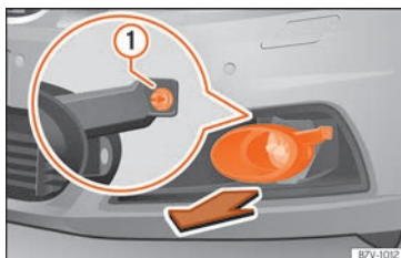
Abb. 66 Im Stoßfänger vorn rechts: Ausbau der Glühlampe.
