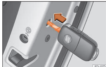
Abb. 97 Notverriegelung des Fahrzeugs mit dem Fahrzeugschlüssel.
