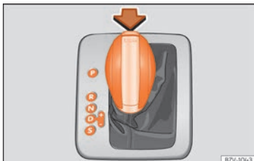
Abb. 235 Wählhebel des automatischen Getriebes mit Sperrtaste (Pfeil).
