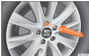
Abb. 49 Radwechsel: Radschrauben mit dem Schraubendrehergriff herausdrehen.
