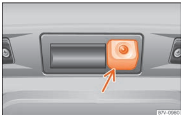
Abb. 246 Im Stoßfänger hinten: Einbauort der Kamera des Rückfahrassistenten.
