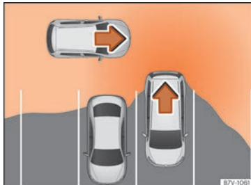
Abb. 262 Schematische Abbildung des Ausparkassistenten: Überwachter Bereich des ausparkenden Fahrzeugs.
