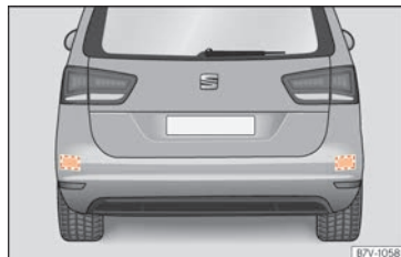
Abb. 244 Heckansicht des Fahrzeugs: Bereiche der Radarsensoren.
