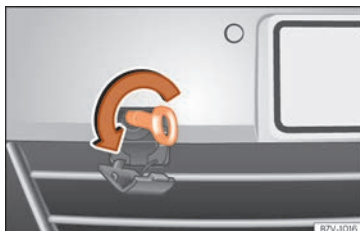
Abb. 56 Im Stoßfänger vorn rechts: Abschleppöse einschrauben.
