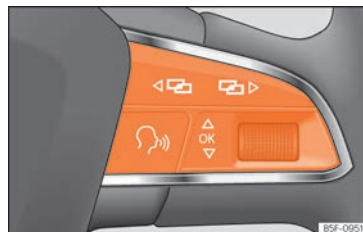
Abb. 81 Multifunktionslenkrad: Tasten zum Bedienen der Menüs im Kombiinstrument.
