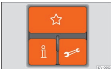
Abb. 85 Drei-Tasten-Modul im Himmel: Bedienelemente des Telefonsteuerungssystems.
