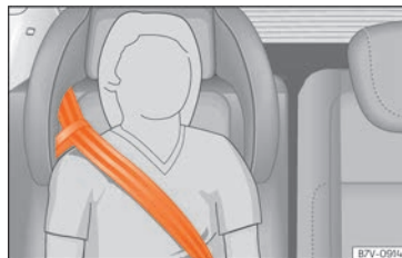
Abb. 35 Integrierter Kindersitz: Gurtbandverlauf mit Gurtführungsschleufe.
