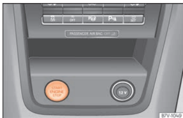
Abb. 231 In der Mittelkonsole: Starterknopf des schlüssellosen Schließ- und Startsystems Keyless Access. Bei Rechtslenker-Fahrzeugen ist die Anordnung symmetrisch.
