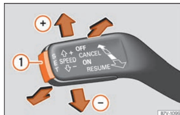
Abb. 248 Links an der Lenksäule: dritter Hebel für die Bedienung der GRA.
