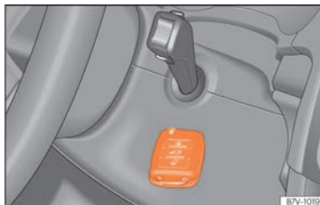
Abb. 232 Notstart bei Fahrzeugen mit Keyless Access.
