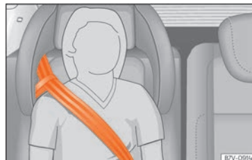
Abb. 98 Integrierter Kindersitz: Gurtbandverlauf mit Gurtführungsschleufe.
