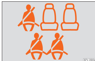
Abb. 85 Beispiel der Gurtstatusanzeige für die hinteren Sitzplätze (hier beim 7-Sitzer) im Kombiinstrument: oben zweite Sitzreihe, unten dritte Sitzreihe.
