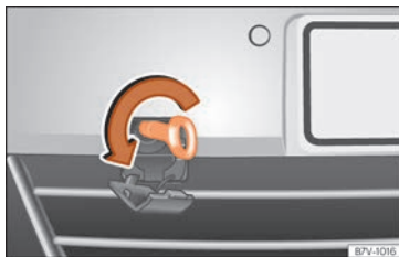
Abb. 105 Im Stoßfänger vorn rechts: Abschleppöse einschrauben.
