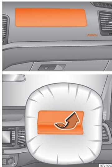
Abb. 28 Einbauort und Wirkungsbereich des Beifahrer-Frontairbags.
