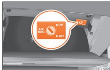
Abb. 94 Im Handschuhfach, auf der Beifahrerseite: Schlüsselschalter zum Ab- und Einschalten des Beifahrer-Frontairbags.
