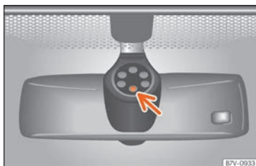
Abb. 149 Sensitive Fläche des Regensensors.
