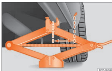
Abb. 72 Wagenheber hinten an der linken Fahrzeugseite angesetzt.
