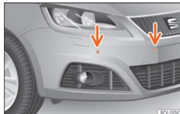
Abb. 247 Sensoren der Parkdistanzkontrolle vorn im Stoßfänger.
