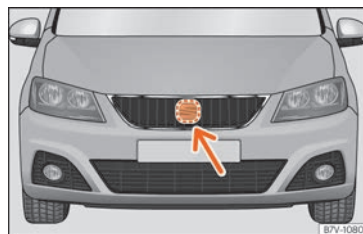
Abb. 263 Im Frontbereich hinter dem SEAT-Emblem: Radarsensor.
