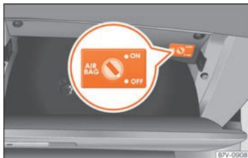
Abb. 29 Im Handschuhfach, auf der Beifahrerseite: Schlüsselschalter zum Ab- und Einschalten des Beifahrer-Frontairbags.
