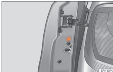
Abb. 6 Am Frontend der Schiebetür: Notverriegelung, durch eine Gummidichtung abgedeckt.
