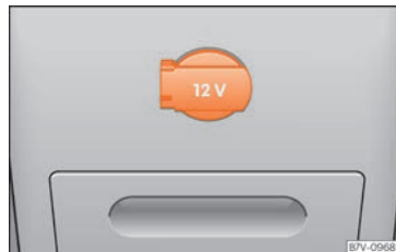
Abb. 197 Hintere Seite der Mittelkonsole: 12-Volt-Steckdose.
