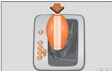
Abb. 241 Wählhebel des automatischen Getriebes mit Sperrtaste (Pfeil).
