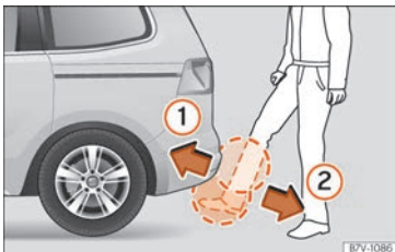
Abb. 142 Heckklappe mit sensorgesteuerter Öffnung (Easy Open).
