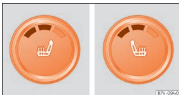
Abb. 158 Ausschnitt aus der Mittelkonsole: Regler für die Sitzheizung der Vordersitze, hier bei eingestellter zweiter Heizstufe.
