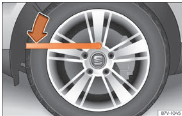
Abb. 69 Radwechsel: Radschrauben lockern.
