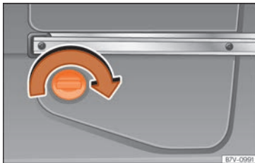
Abb. 288 Hinten links im Gepäckraum: AdBlue-Tank, hinter einer Abdeckung.
