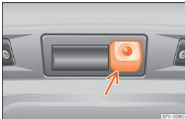
Abb. 253 In der Heckklappe: Einbauort der Kamera des Rückfahrasistenten.
