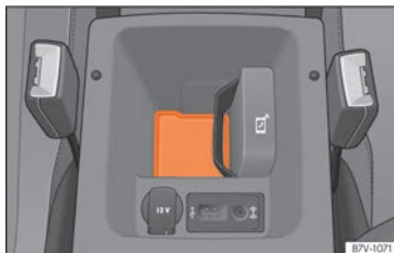
Abb. 124 Vordere Mittelarmlehne: Aufnahme zur Verbindung des Mobiltelefons mit der Außenantenne des Fahrzeugs.
