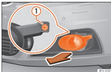
Abb. 111 Im Stoßfänger vorn rechts: Ausbau der Scheinwerfer.
