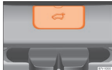
Abb. 10 Vom Gepäckraum aus: Demontage der Abdeckung der Heckklappe.
