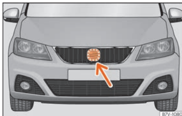
Abb. 259 Im Frontbereich hinter dem SEAT-Emblem: Radarsensor.
